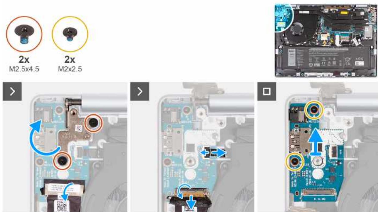
Rysunek 39. Wymontowywanie płyty we/wy
