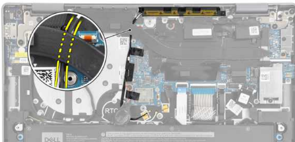
Rysunek 54. Instalowanie kabli antenowych
