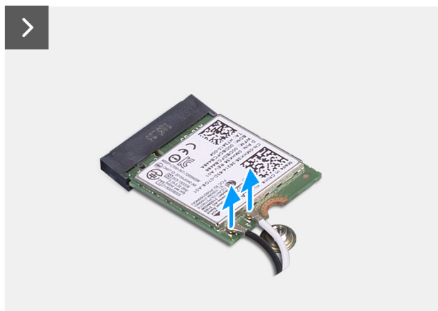
Rysunek 18. Wymontowywanie karty sieci bezprzewodowej
