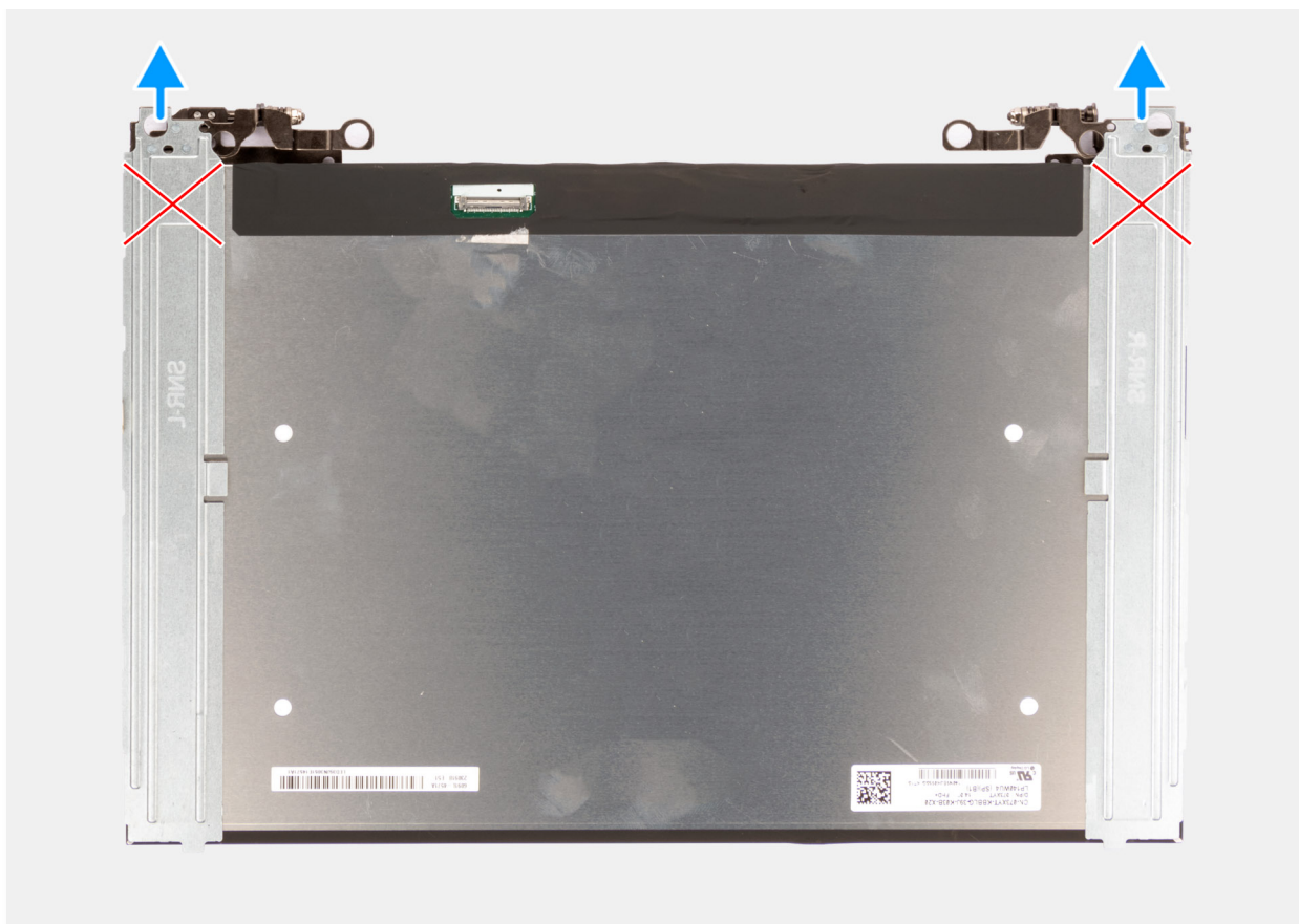
Rysunek 57. Wymontowywanie wyświetlacza
