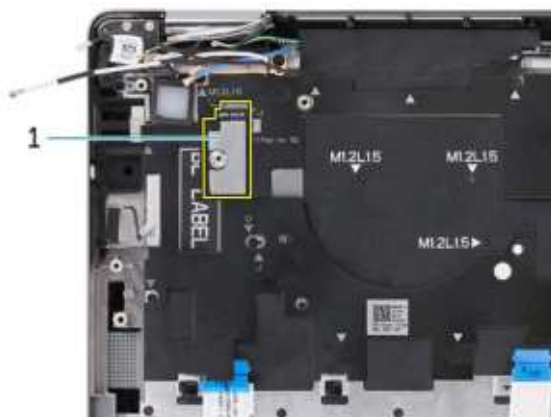
Rysunek 65. Płyta nośna klawiatury komputera w konfiguracji z kartą sieci WWAN 5G
