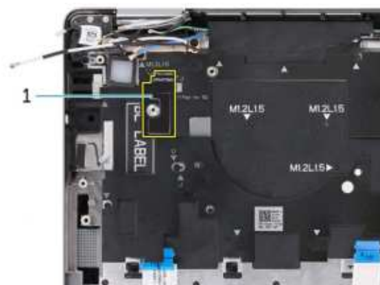
Rysunek 64. Płyta nośna klawiatury komputera w konfiguracji z kartą sieci WWAN 4G
