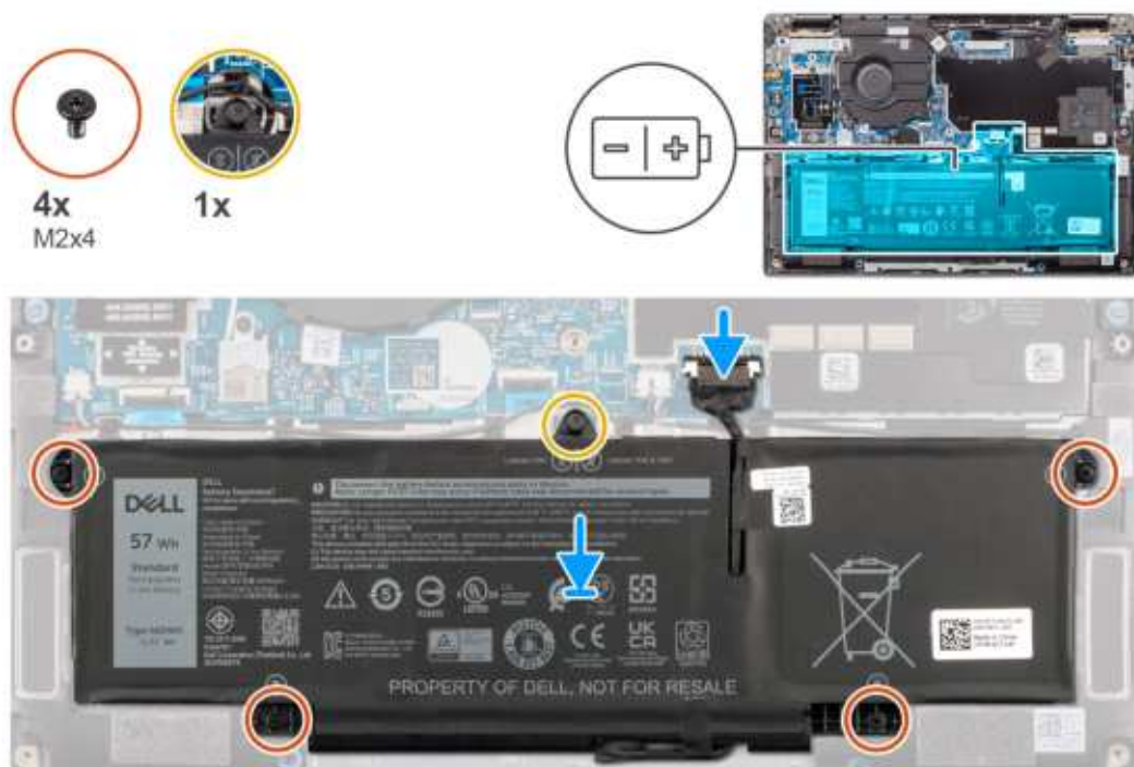
Rysunek 32. Instalowanie baterii 3-ogniowej
