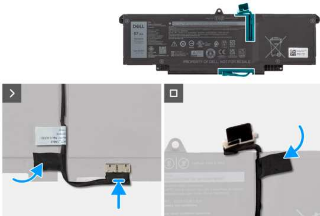
Rysunek 34. Instalowanie kabla baterii
