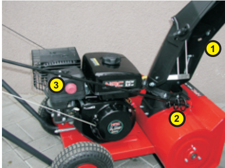
Rys. 4 1 - Wyrzutnik śniegu 2 - Ślimak korby 3 - Łącznik korby
