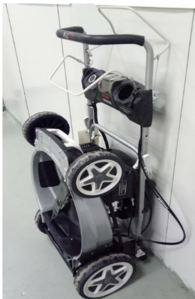
Przechowanie kosiarki w pozycji pionowej bez oleju i paliwa
