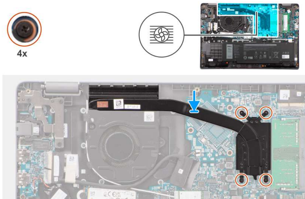
Rysunek 30. Instalowanie radiatora (konfiguracja ze zintegrowaną kartą graficzną)
