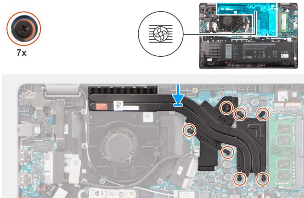
Rysunek 32. Instalowanie radiatora (konfiguracja z autonomiczną kartą graficzną)
