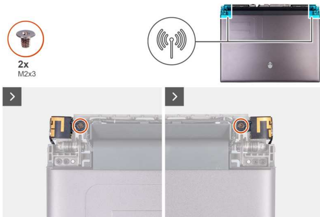
Rysunek 46. Wymontowywanie anteny
