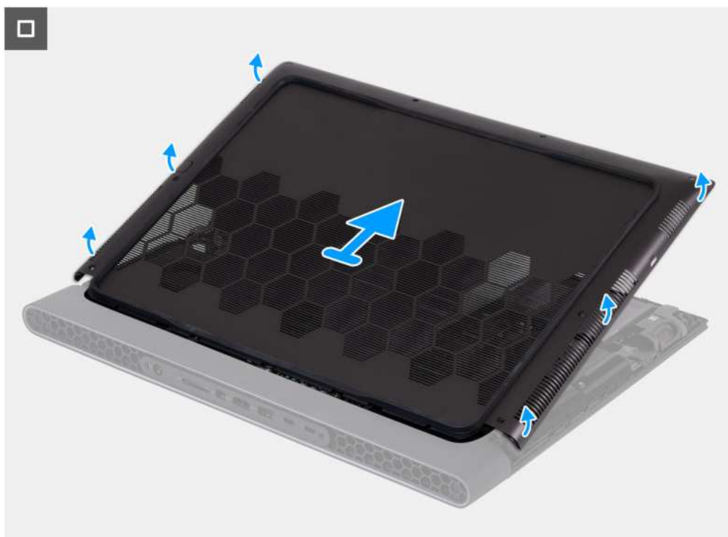
Rysunek 9 Wymontowywanie pokrywy dolnej Wymontowywanie i instalowanie modułów wymienianych samodzielnie przez klienta (CRU)
