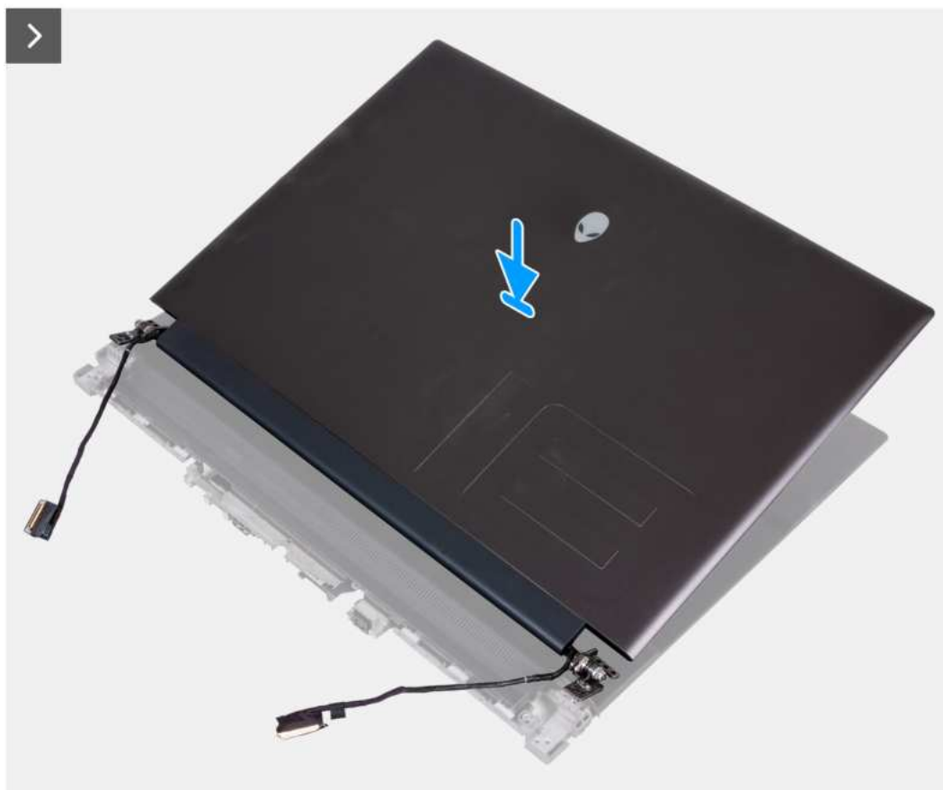
Rysunek 38. Instalowanie zestawu wyświetlacza
