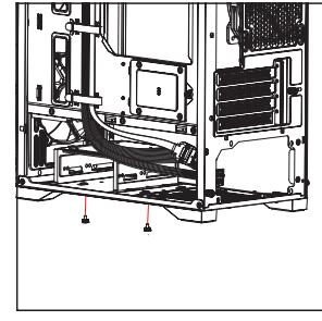
Installing 2.5" SSDs / Montaż dysków 2.5" SSD
