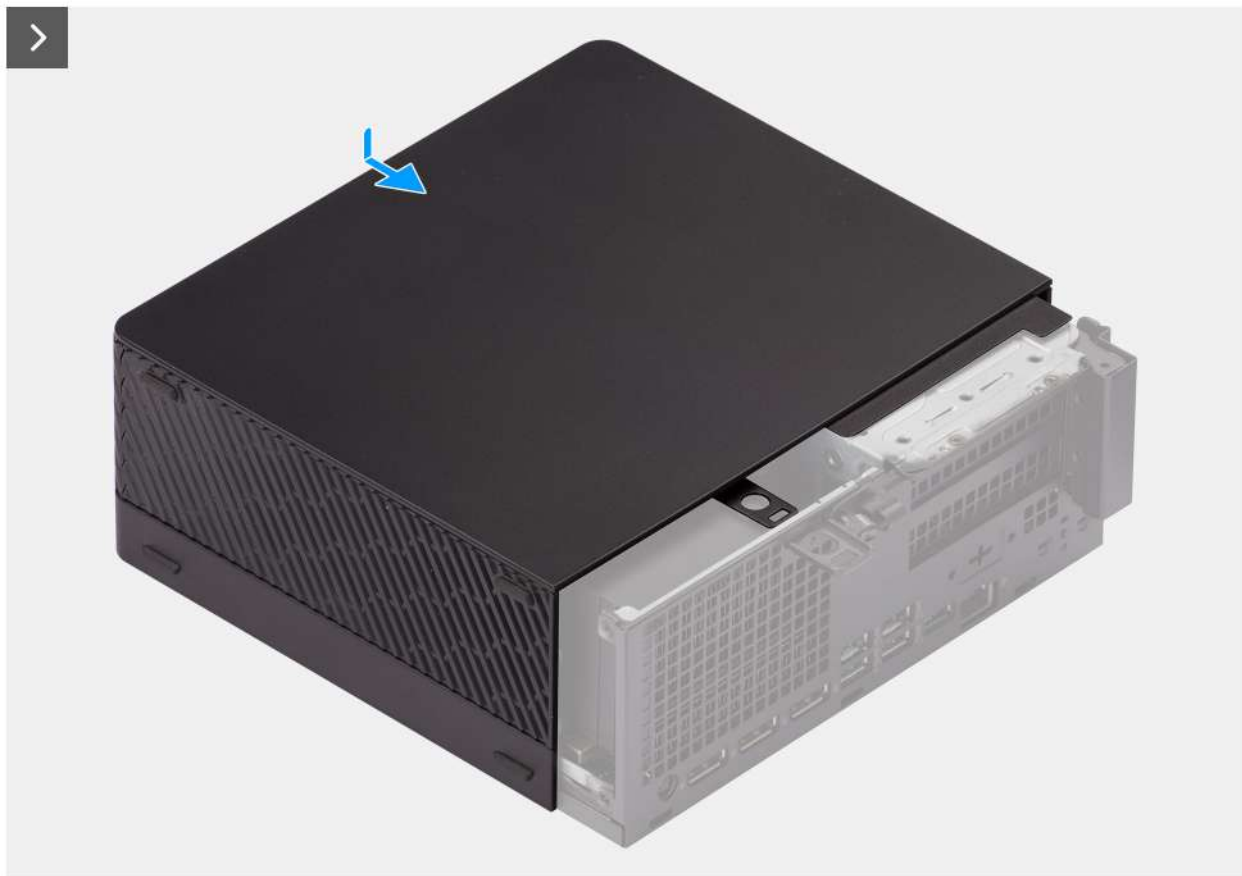
Rysunek 12. Instalowanie pokrywy bocznej
