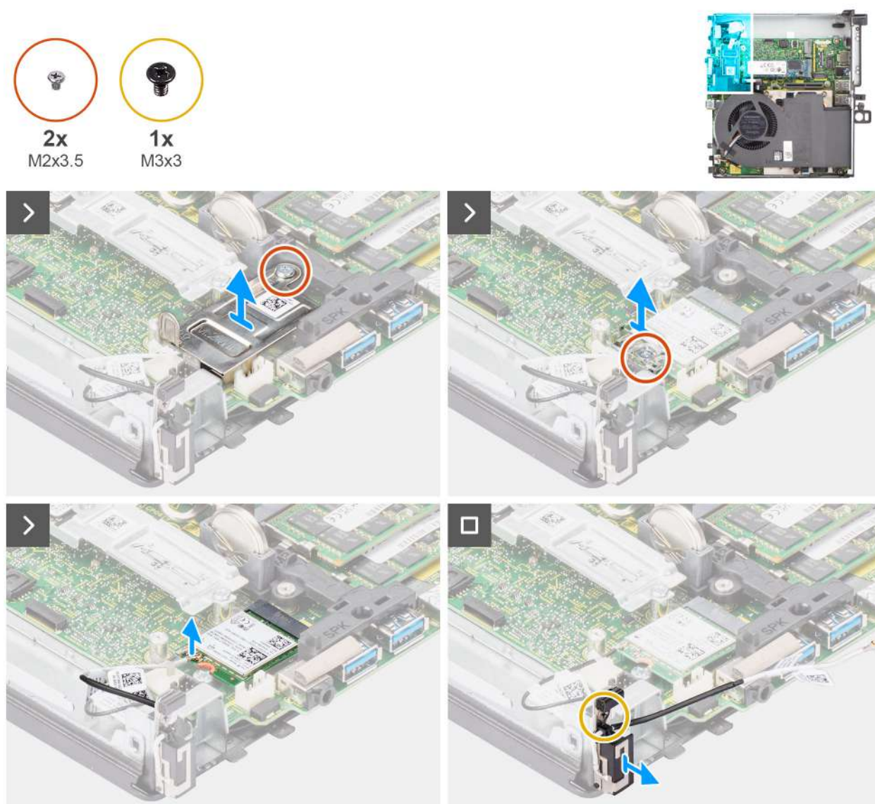
Rysunek 56. Wymontowywanie anteny wewnętrznej — miejsce 1
