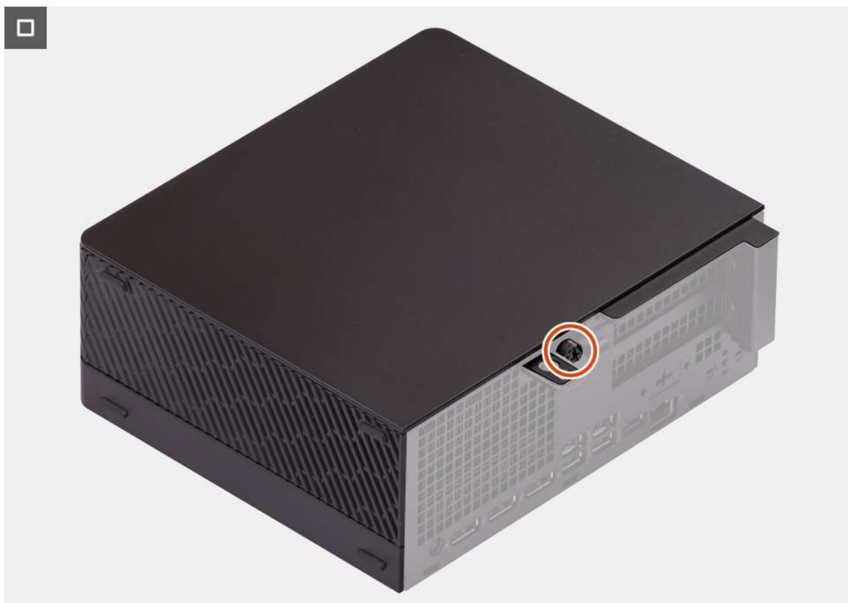
Rysunek 13. Instalowanie pokrywy bocznej
