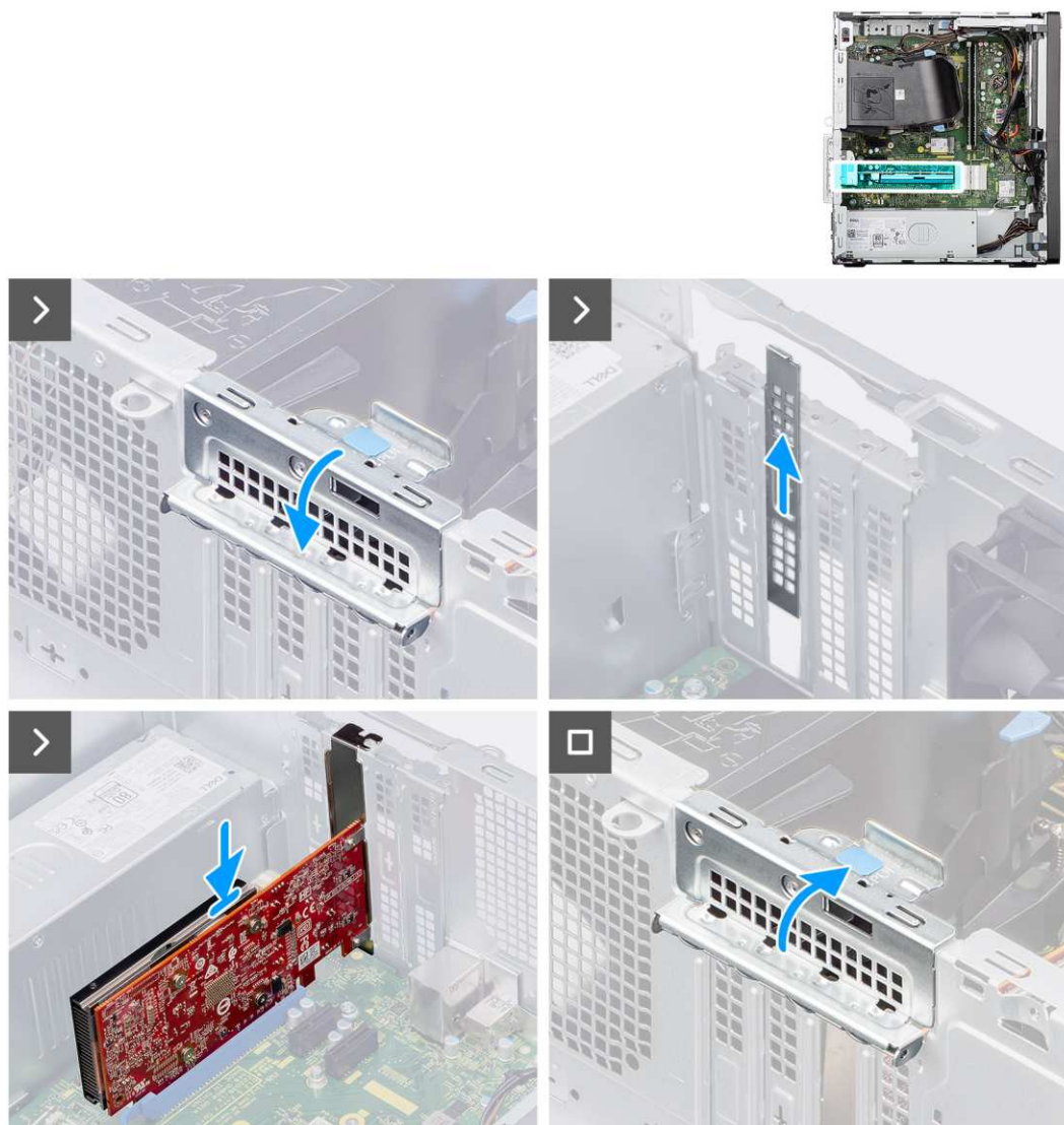
Rysunek 34. Instalowanie karty graficznej
