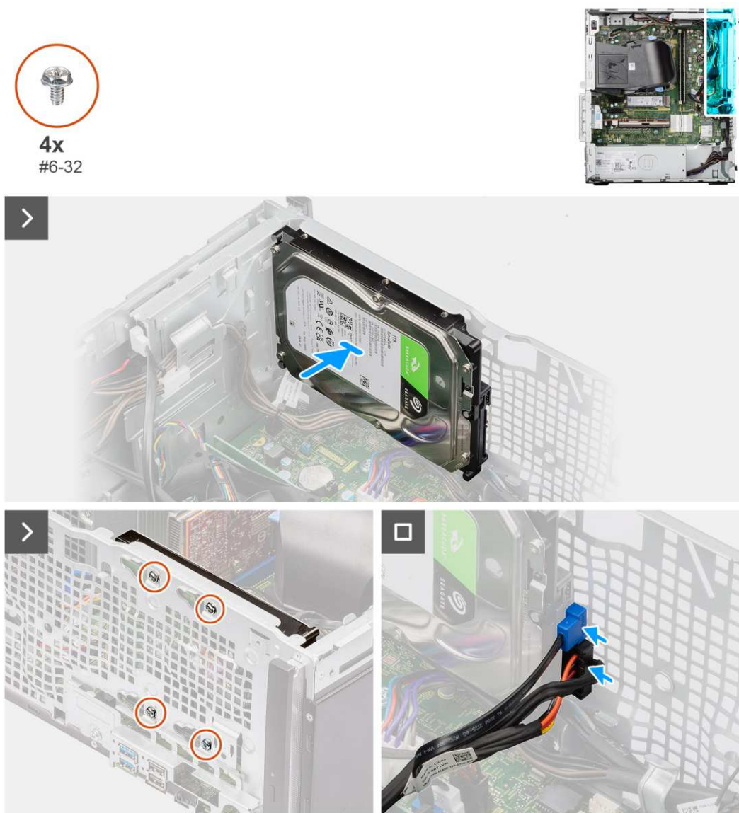
Rysunek 36. Instalowanie dysku twardego 3,5"
