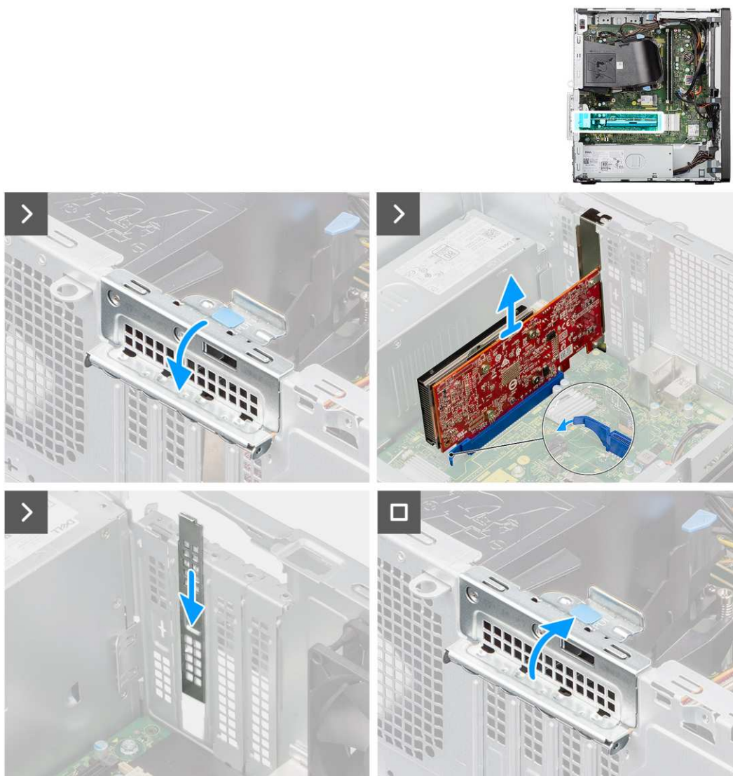
Rysunek 33. Wymontowywanie karty graficznej
