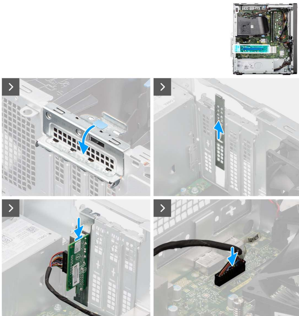
Rysunek 74. Instalowanie opcjonalnego modułu złącza PS2/szeregowego
