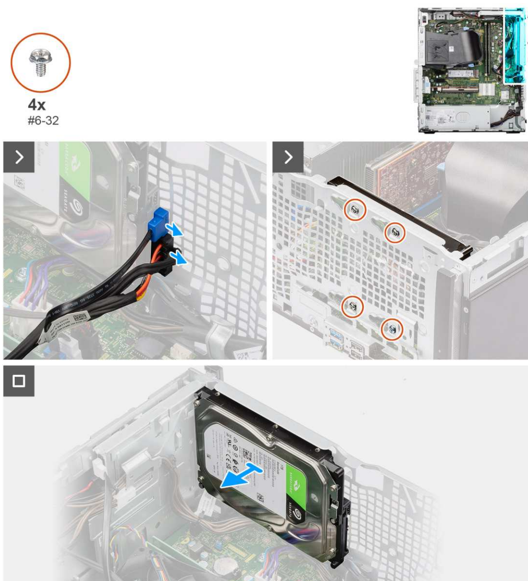
Rysunek 35. Wymontowywanie dysku twardego 3,5"
