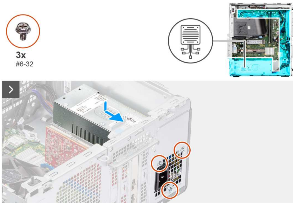
Rysunek 66. Instalowanie zasilacza
