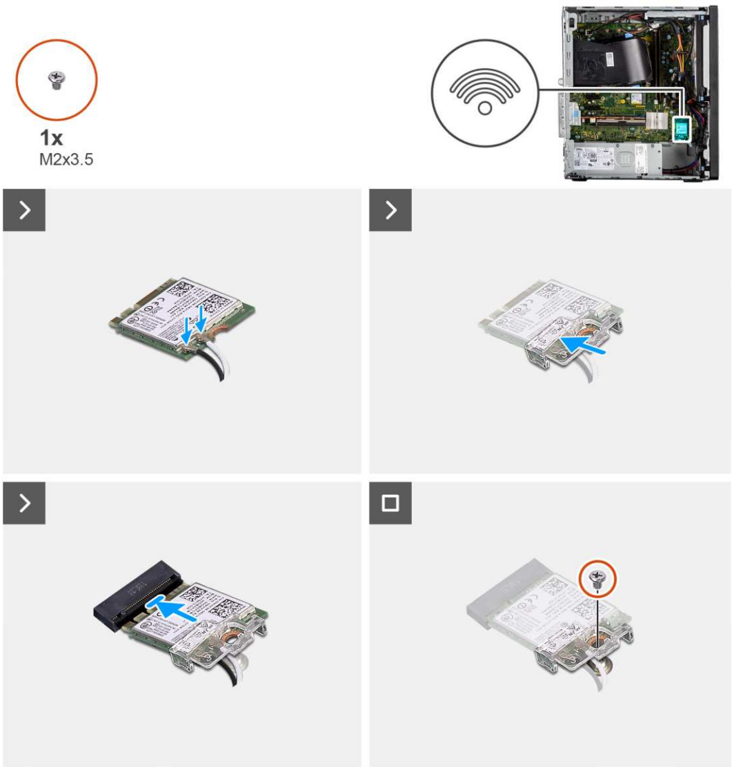
Rysunek 32. Instalowanie karty sieci bezprzewodowej
