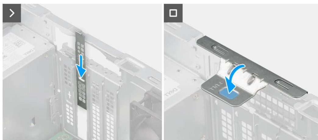
Rysunek 44. Wymontowywanie karty portów szeregowego/równoległego
