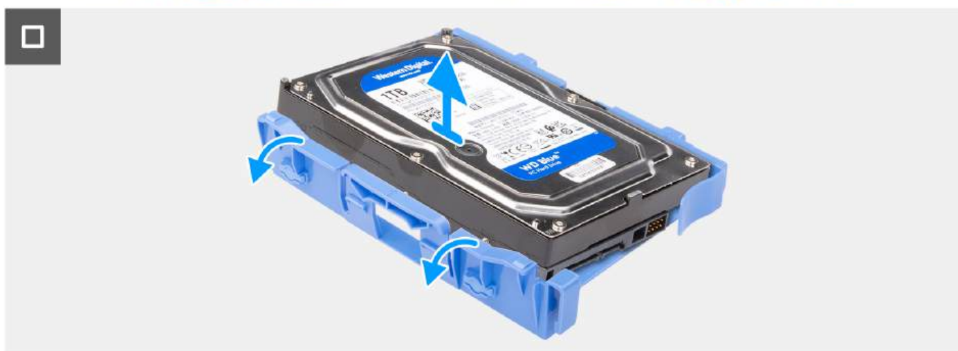
Rysunek 9. Wymontowywanie dysku twardego 3,5"
