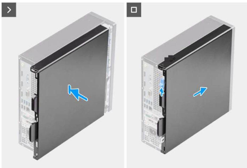
Rysunek 4. Instalowanie pokrywy bocznej
