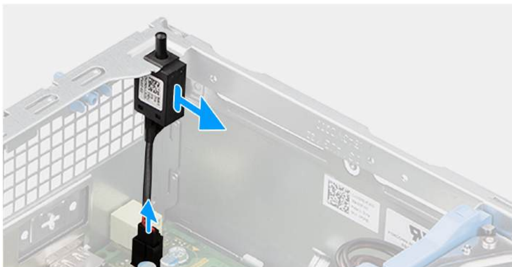
Rysunek 31. Wymontowywanie czujnika otwarcia obudowy
