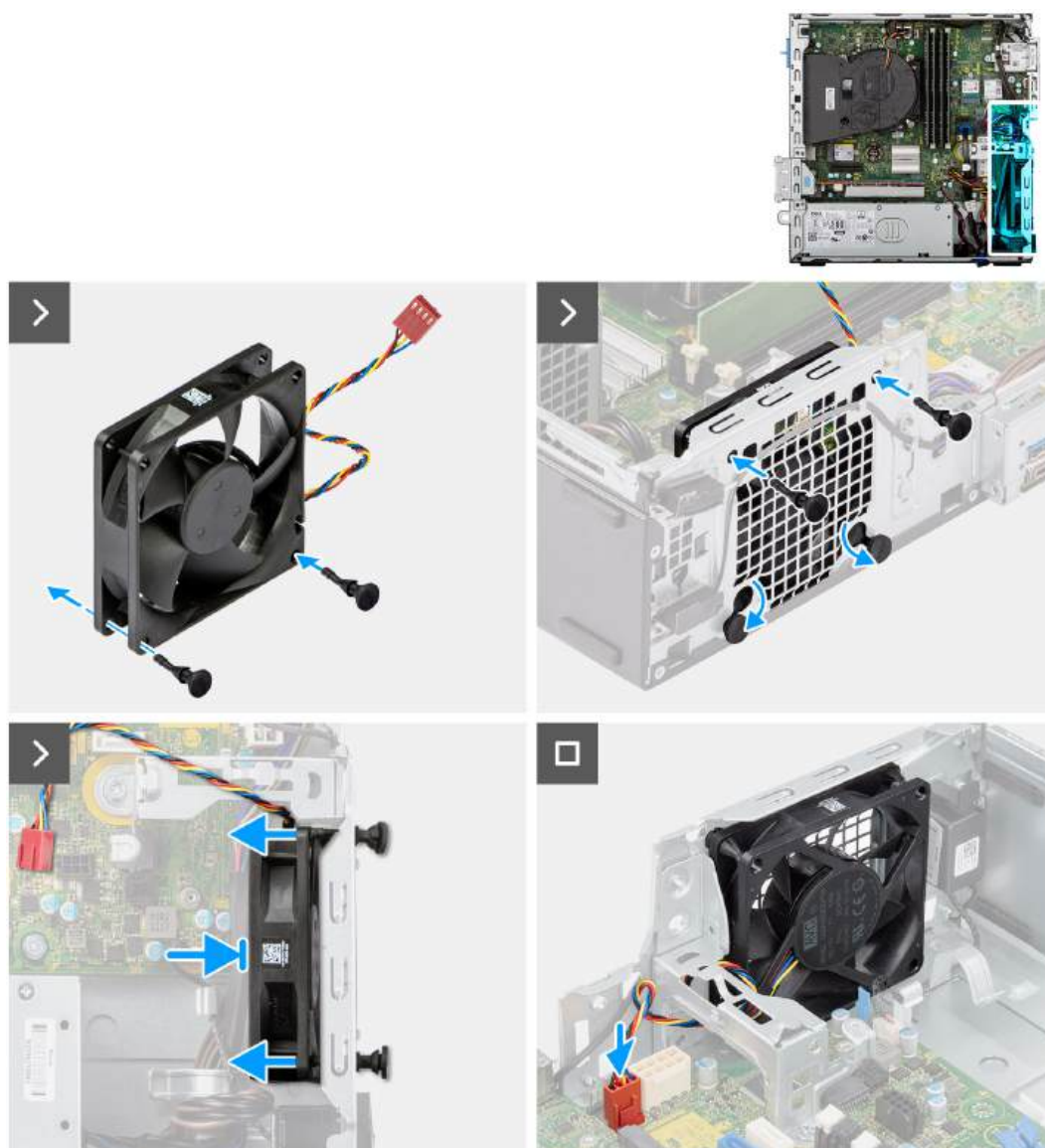
Rysunek 36. Instalowanie wentylatora systemowego
