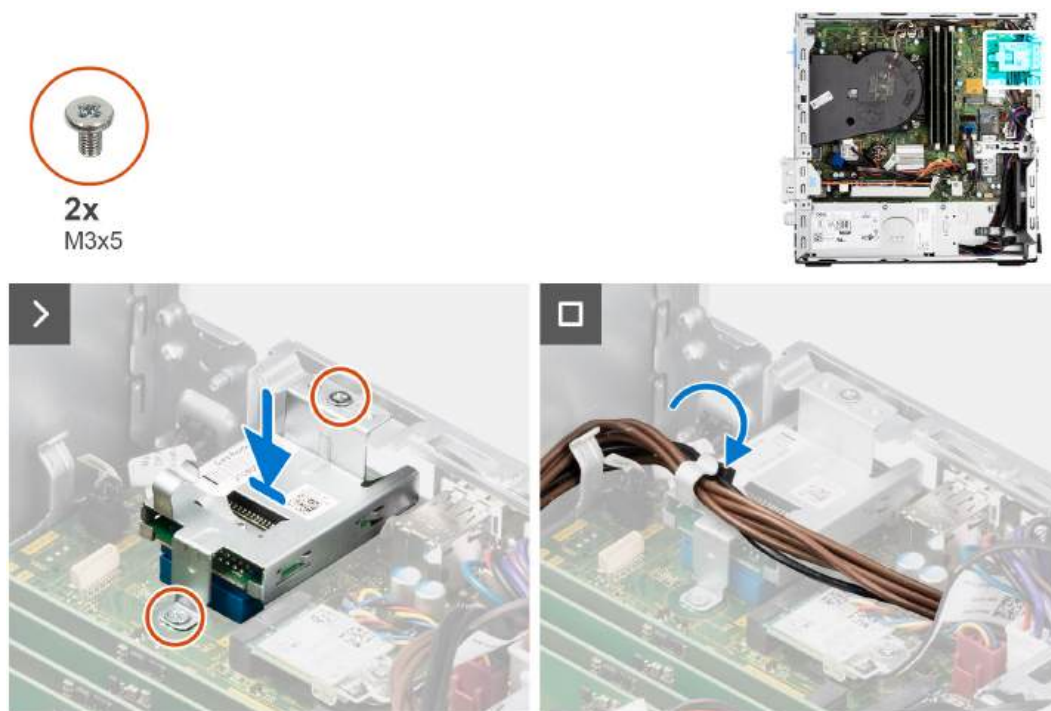
Rysunek 26. Instalowanie czytnika kart pamięci
