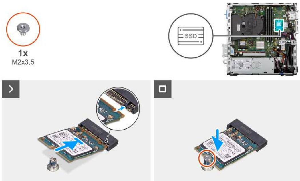
Rysunek 20. Instalowanie dysku SSD M.2 2230 w gnieździe 1
