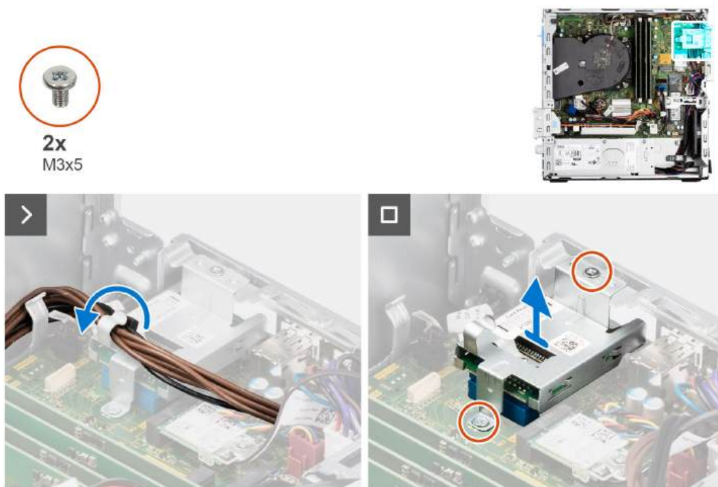
Rysunek 25. Wymontowywanie czytnika kart pamięci
