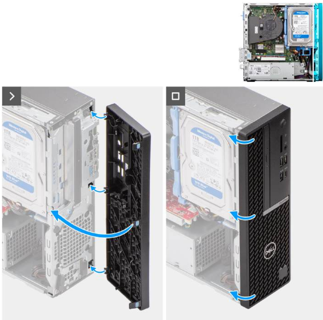
Rysunek 8. Instalowanie ramki przedniej
