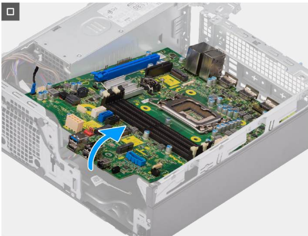
Rysunek 62. Wymontowywanie płyty głównej
