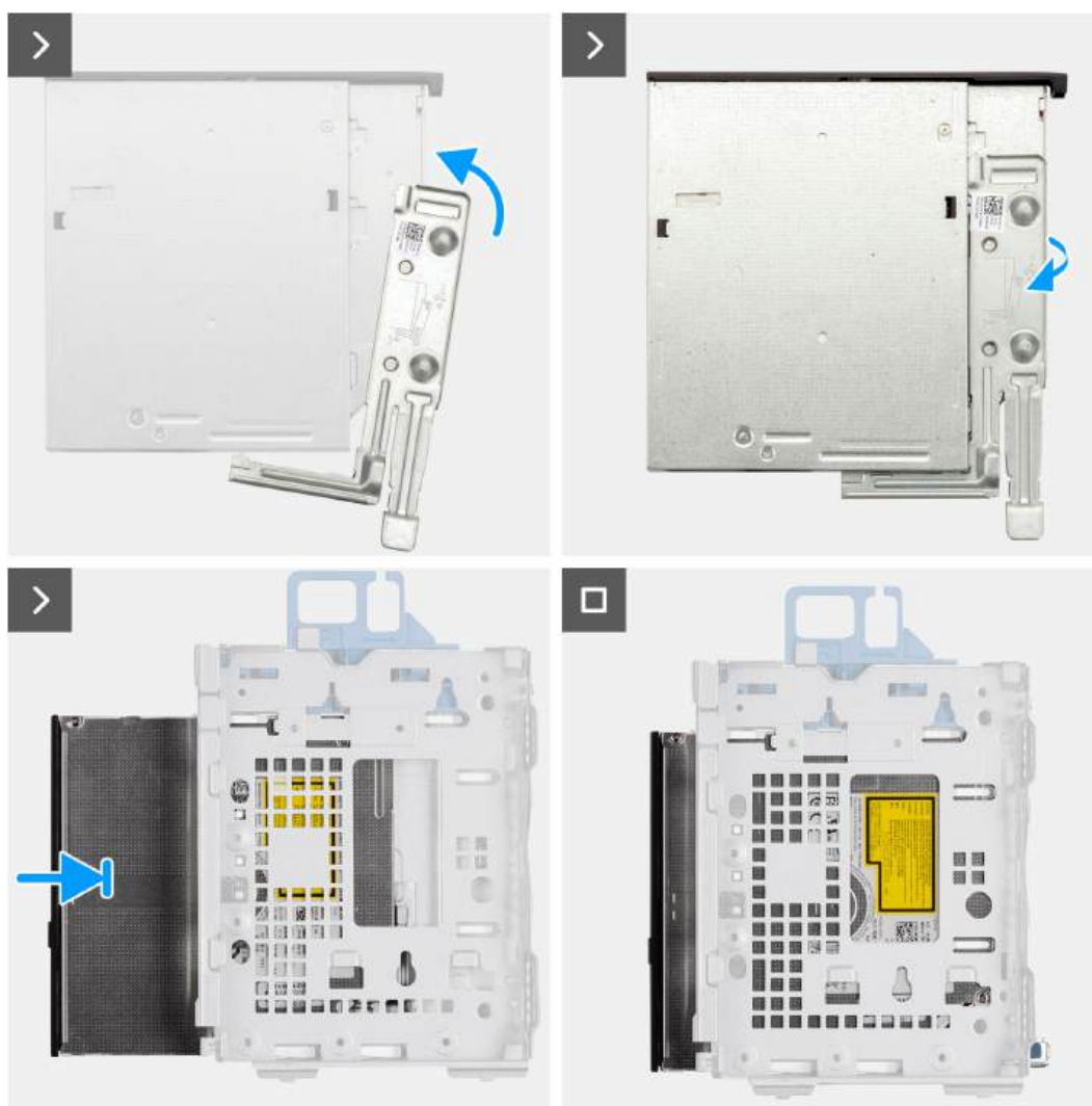
Rysunek 14. Instalowanie napędu optycznego
