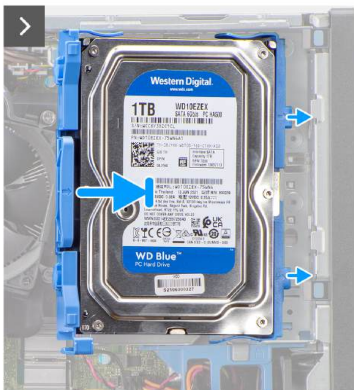
Rysunek 10. Instalowanie dysku twardego 3,5"
