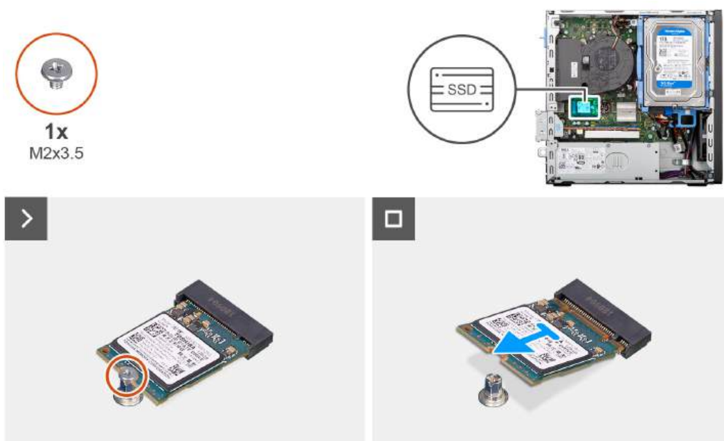
Rysunek 17. Wymontowywanie dysku SSD M.2 2230
