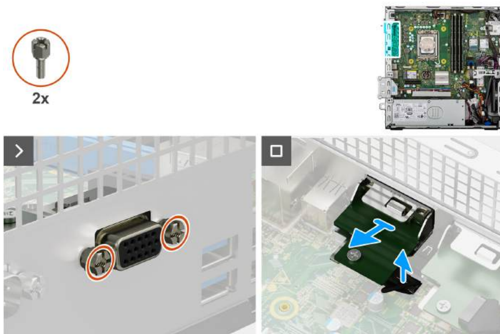
Rysunek 54. Wymontowywanie modułu złącza VGA
