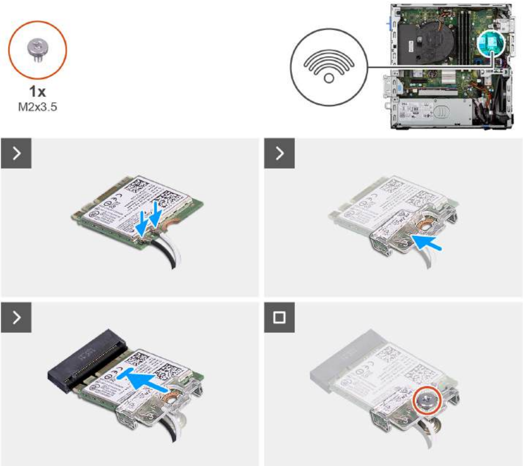
Rysunek 24. Instalowanie karty sieci bezprzewodowej
