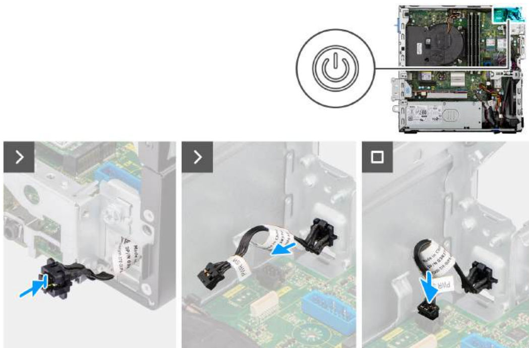
Rysunek 34. Instalowanie przycisku zasilania
