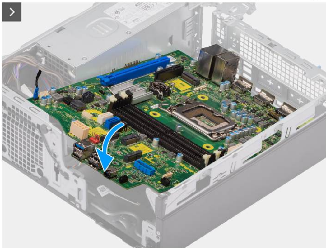
Rysunek 64. Instalowanie płyty głównej
