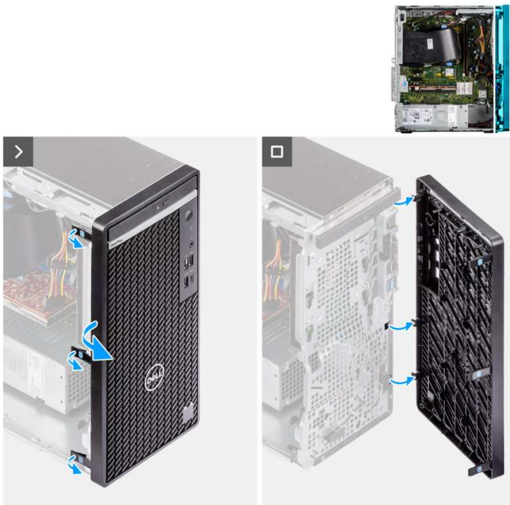
Rysunek 15. Wymontowywanie ramki przedniej
