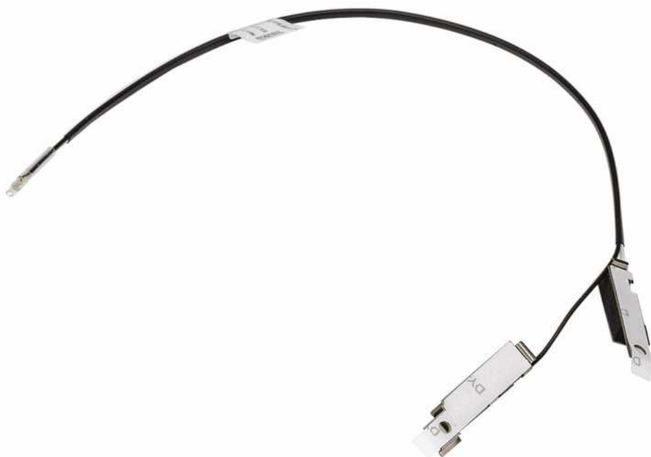
Rysunek 53. Wymontowywanie modułu anteny wewnętrznej
