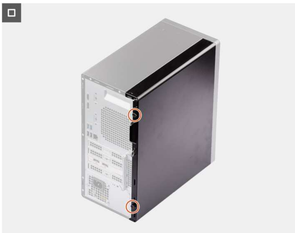
Rysunek 12. Instalowanie pokrywy bocznej
