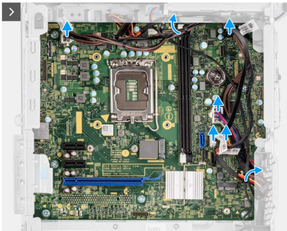
Rysunek 84. Wymontowywanie płyty głównej
