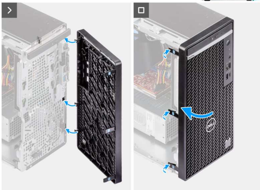
Rysunek 16. Instalowanie ramki przedniej
