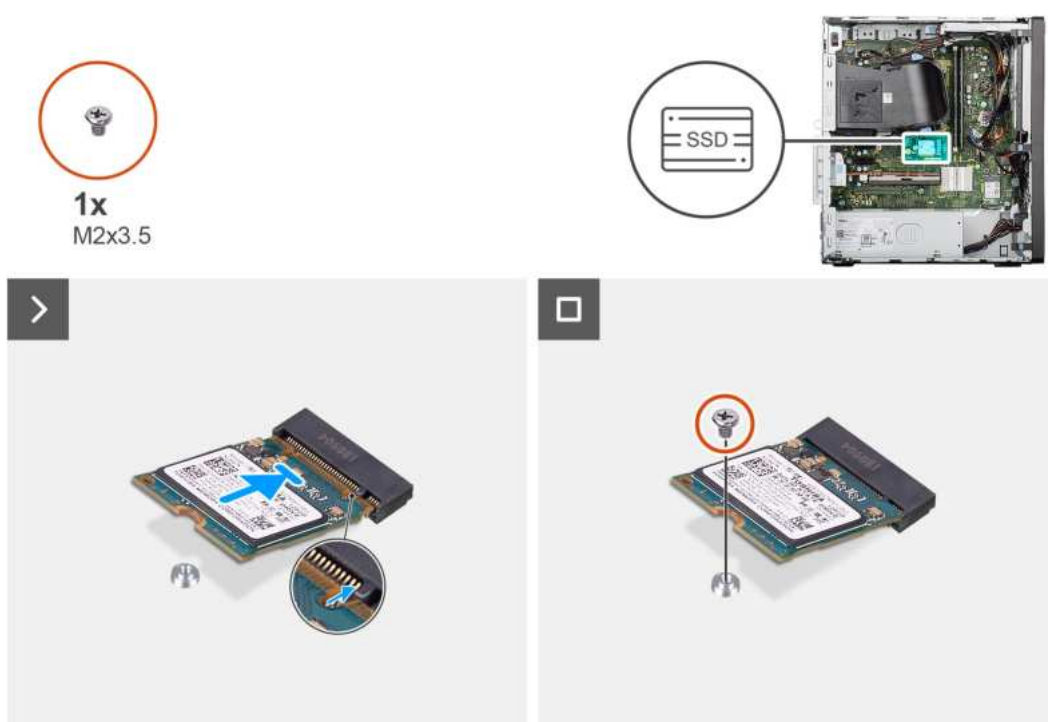
Rysunek 21. Instalowanie dysku SSD M.2 2230
