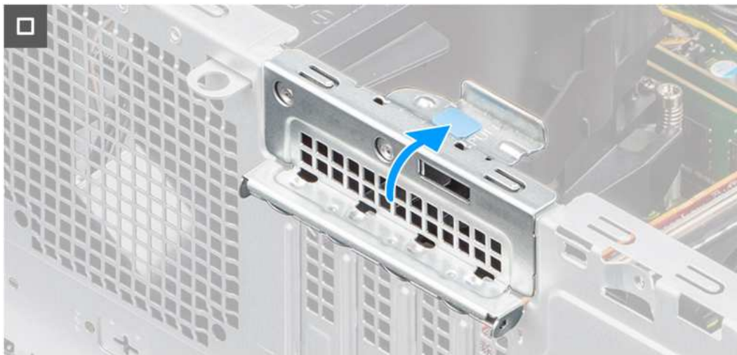
Rysunek 73. Wymontowywanie opcjonalnego modułu złącza PS2/szeregowego
