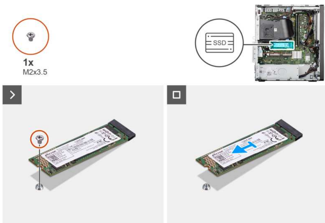
Rysunek 22. Wymontowywanie dysku SSD M.2 2280
