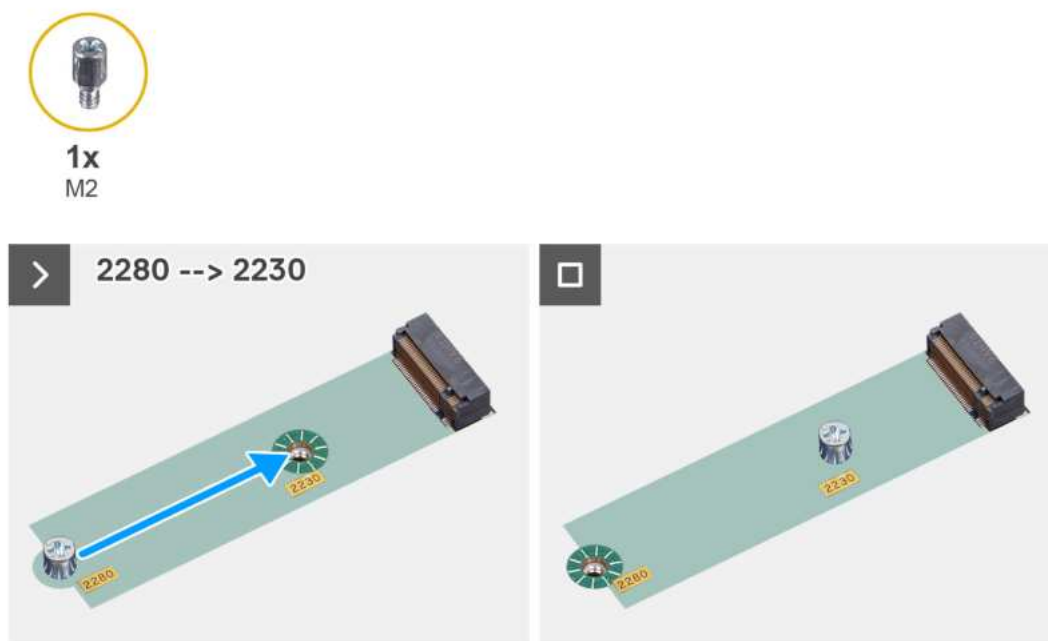
Rysunek 20. Instalowanie dysku SSD M.2 2230
