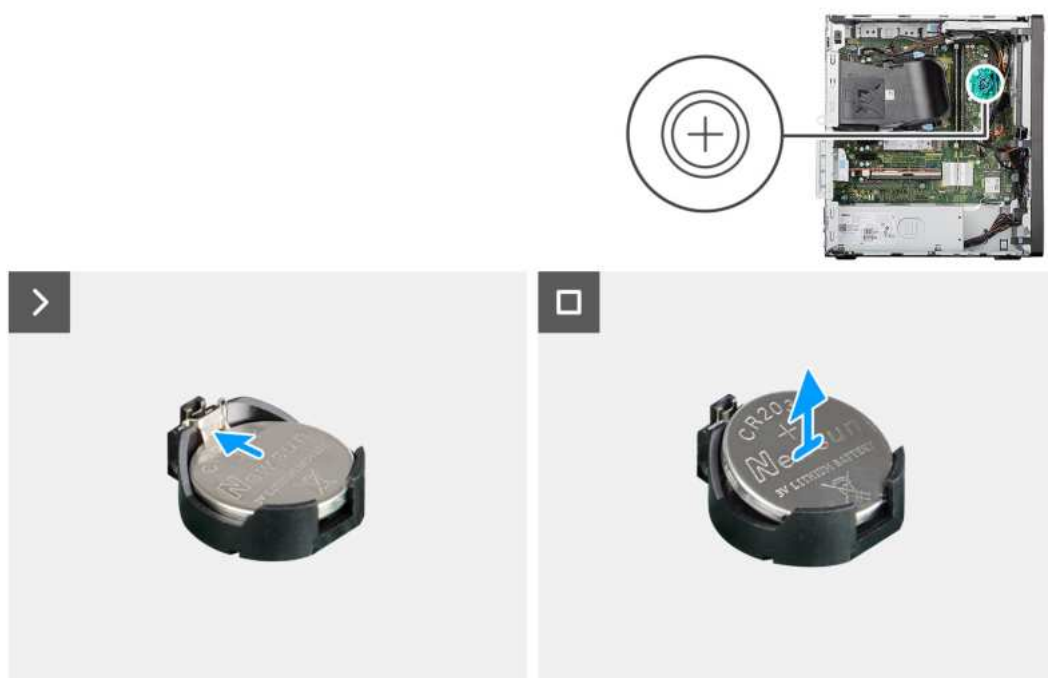
Rysunek 13. Wymontowywanie baterii pastylkowej
