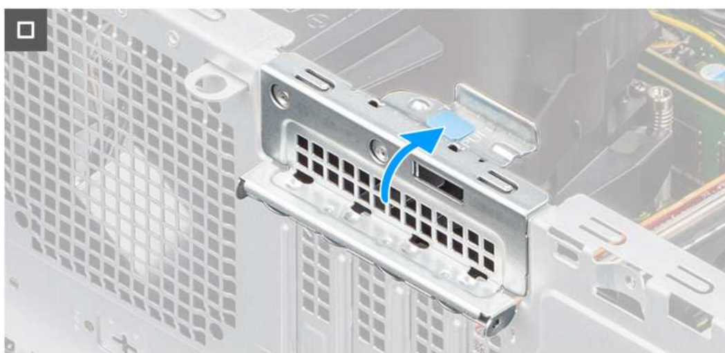
Rysunek 75. Instalowanie opcjonalnego modułu złącza PS2/szeregowego
