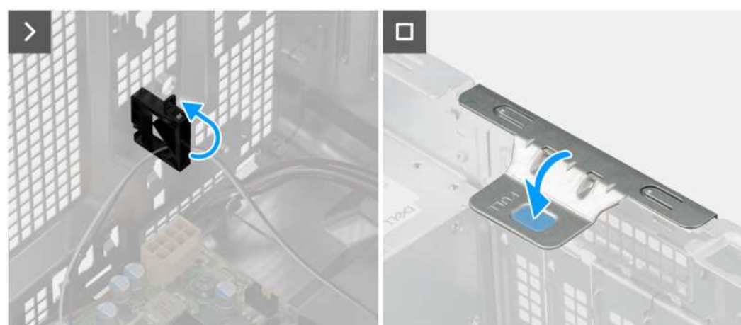
Rysunek 59. Instalowanie modułu anteny zewnętrznej SMA
