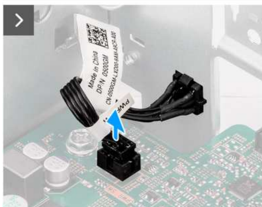
Rysunek 49. Wymontowywanie przycisku zasilania
