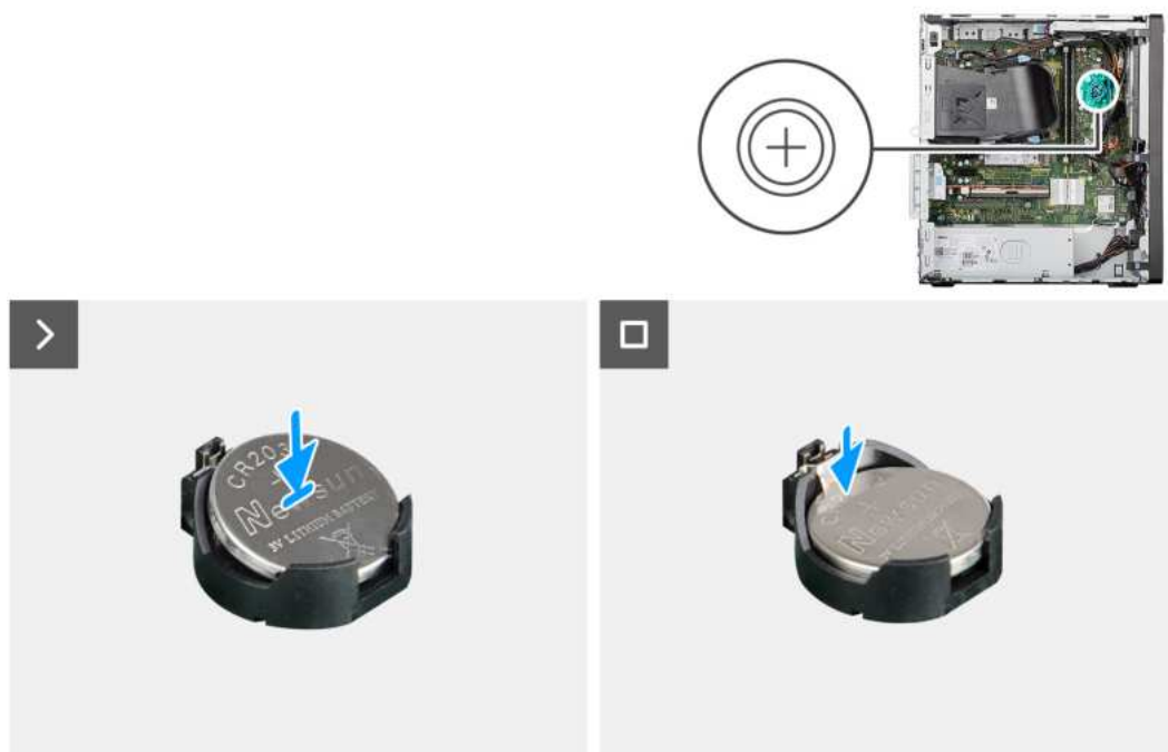
Rysunek 14. Instalowanie baterii pastylkowej
