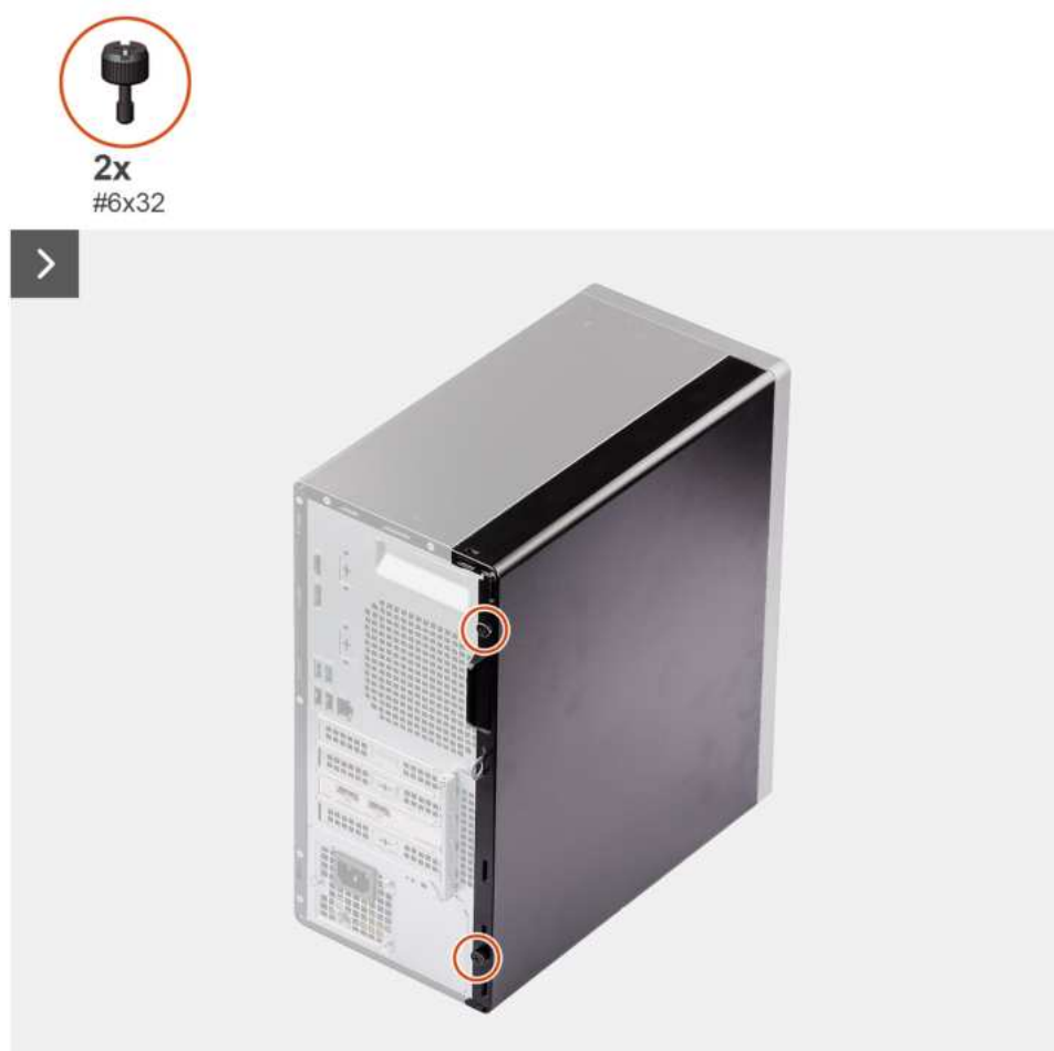
Rysunek 9. Wymontowywanie pokrywy bocznej
