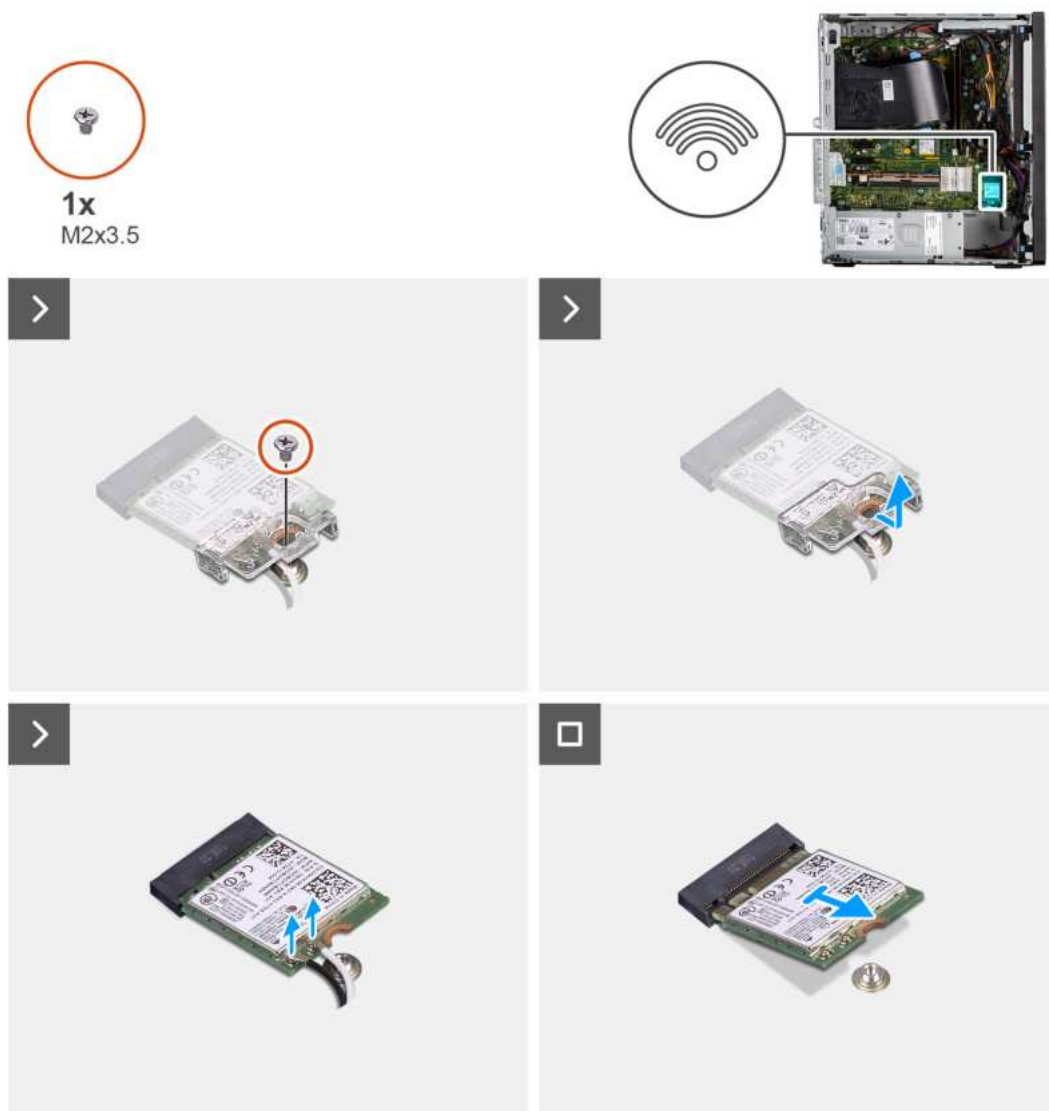
Rysunek 31. Wymontowywanie karty sieci bezprzewodowej
