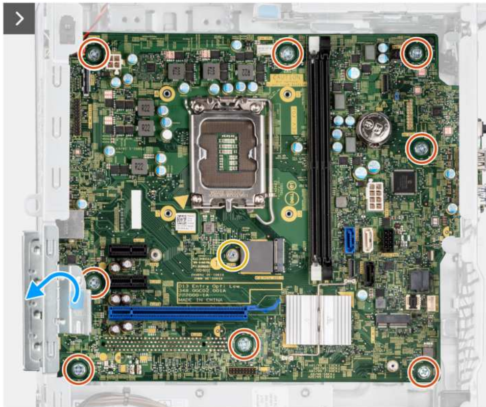
Rysunek 85. Wymontowywanie płyty głównej
