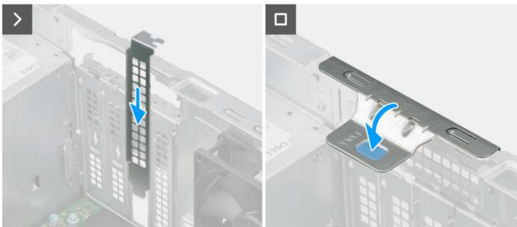
Rysunek 57. Wymontowywanie modułu anteny zewnętrznej SMA
