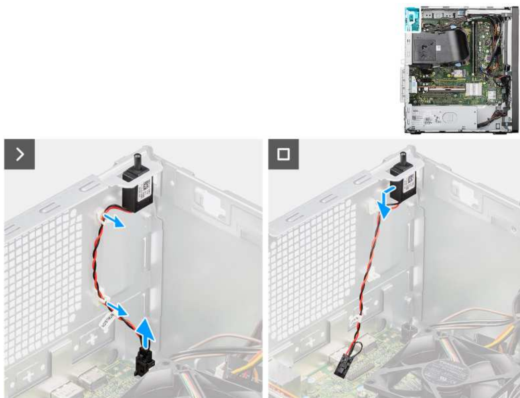
Rysunek 47. Wymontowywanie czujnika otwarcia obudowy
