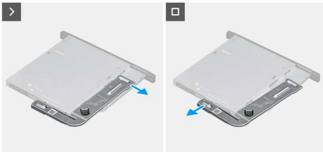
Rysunek 38. Wymontowywanie płaskiego napędu optycznego
