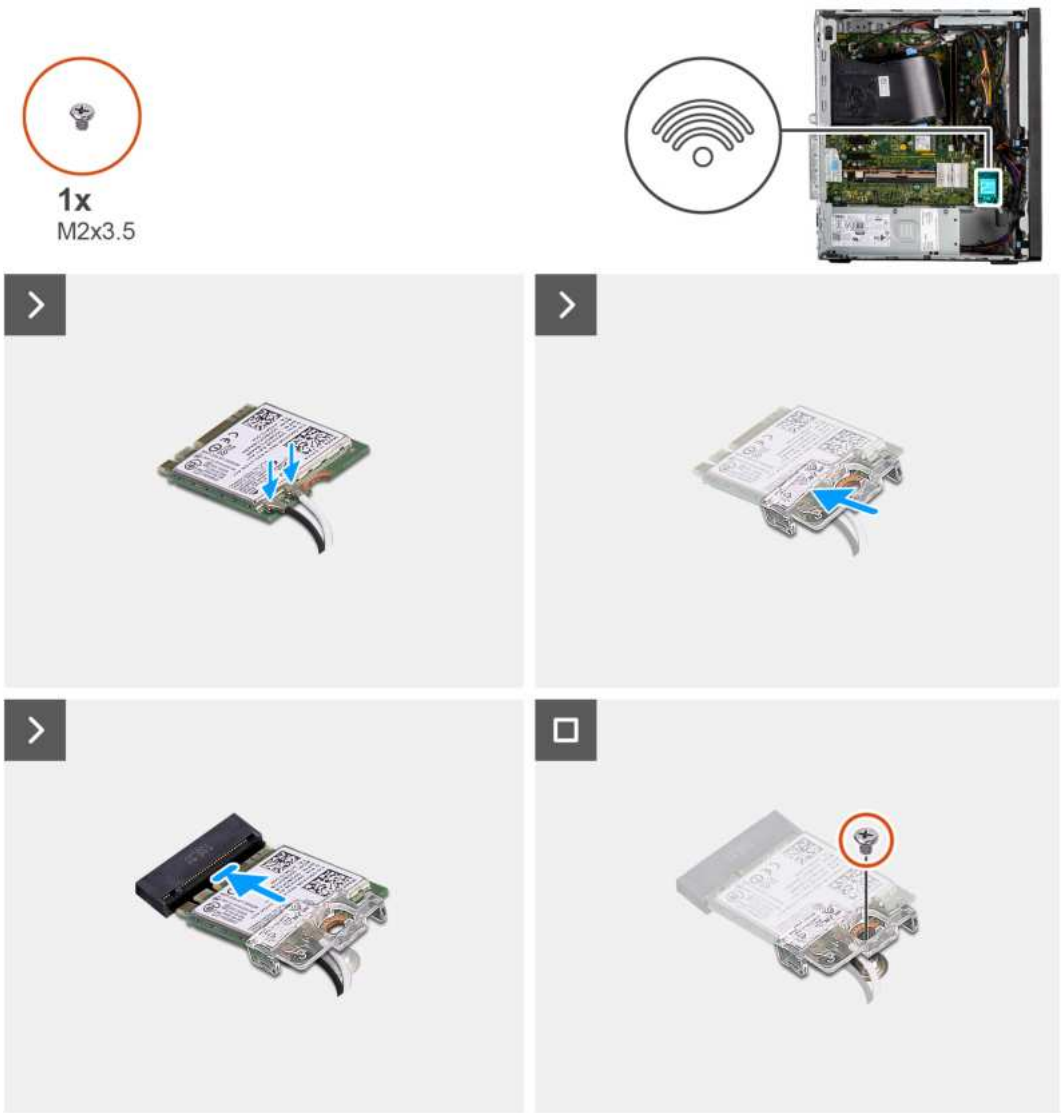
Rysunek 32. Instalowanie karty sieci bezprzewodowej
