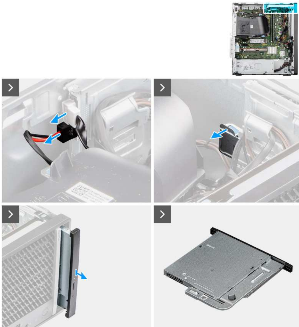
Rysunek 37. Wymontowywanie płaskiego napędu optycznego
