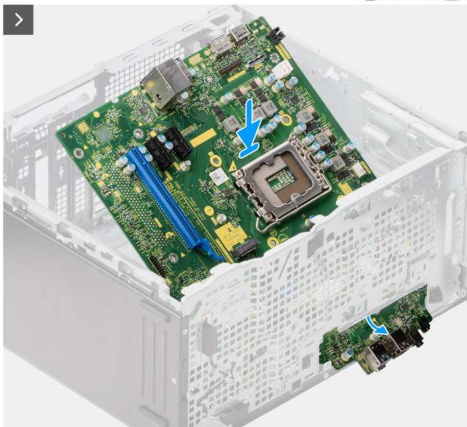
Rysunek 88. Instalowanie płyty głównej
