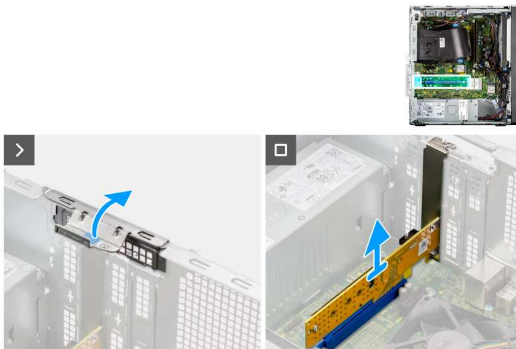
Rysunek 25. Wymontowywanie karty Dell Ultra Speed Drive trzeciej generacji
