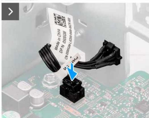
Rysunek 50. Instalowanie przycisku zasilania
