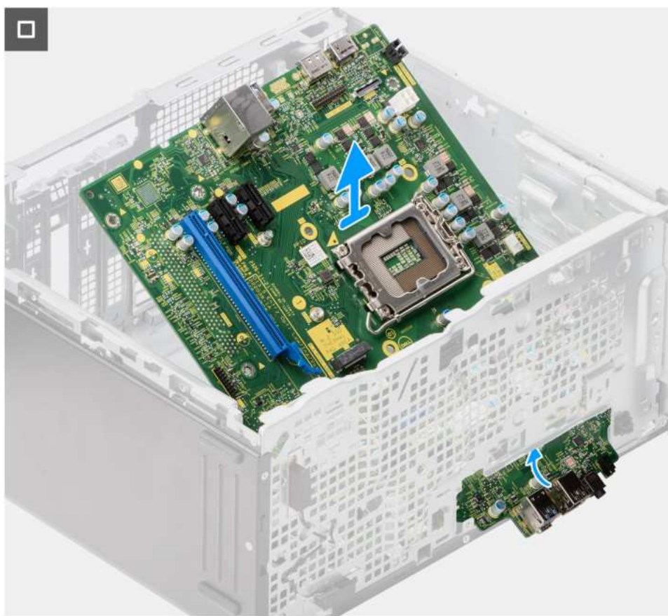
Rysunek 86. Wymontowywanie płyty głównej
