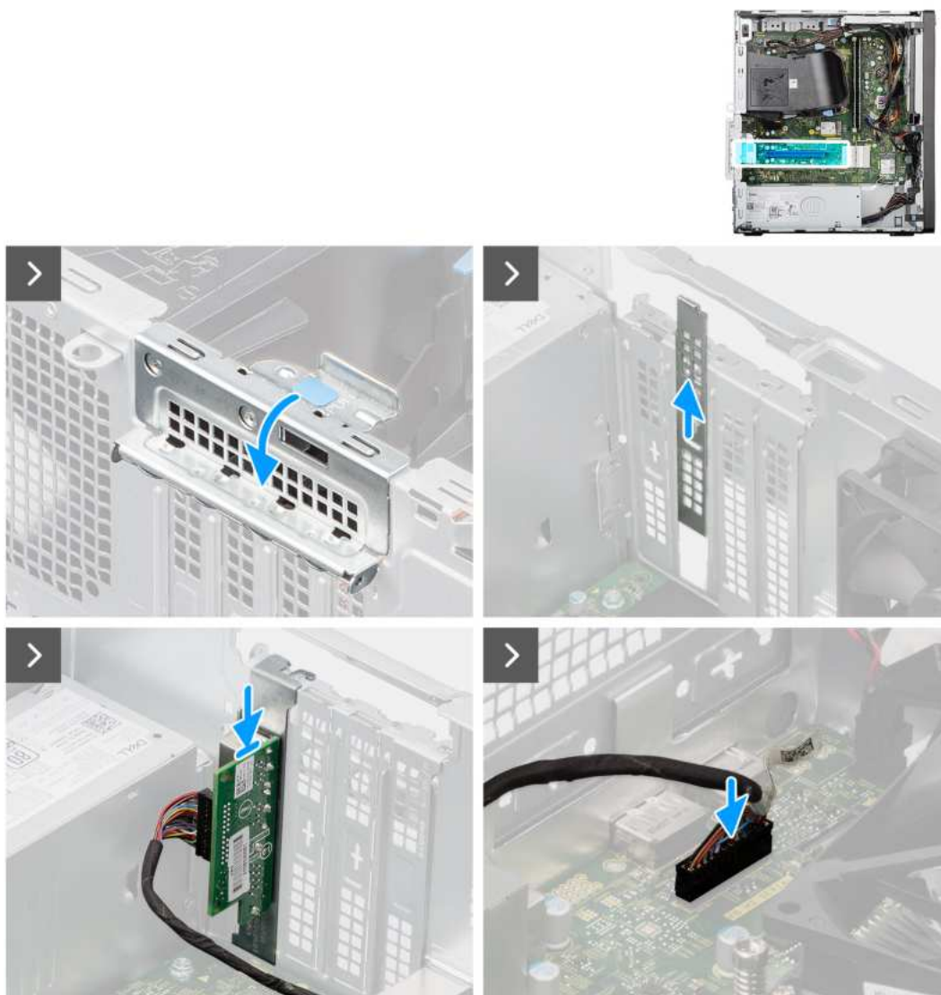
Rysunek 74. Instalowanie opcjonalnego modułu złącza PS2/szeregowego
