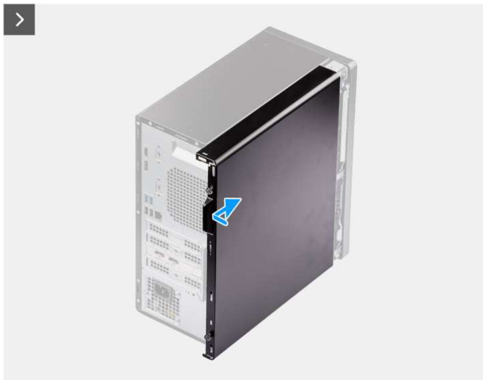
Rysunek 11. Instalowanie pokrywy bocznej
