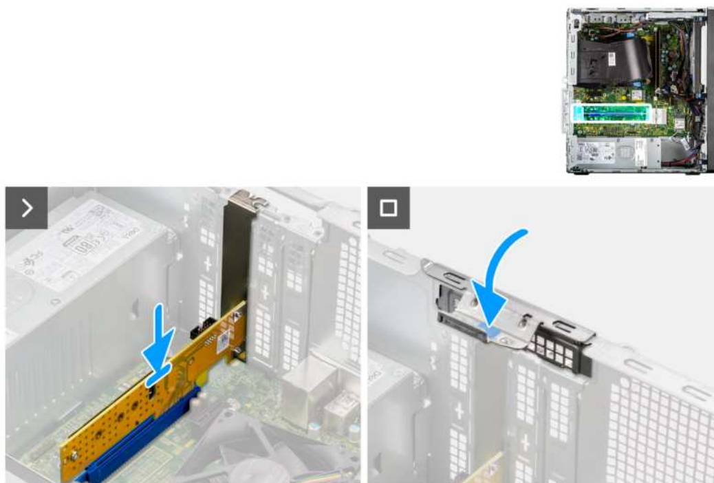
Rysunek 30. Instalowanie karty Dell Ultra Speed Drive trzeciej generacji
