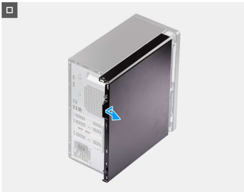
Rysunek 10. Wymontowywanie pokrywy bocznej
