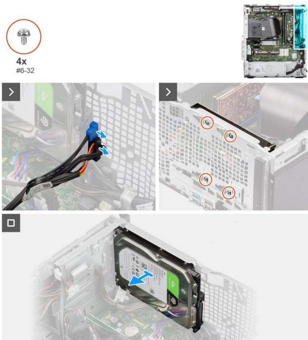
Rysunek 35. Wymontowywanie dysku twardego 3,5"
