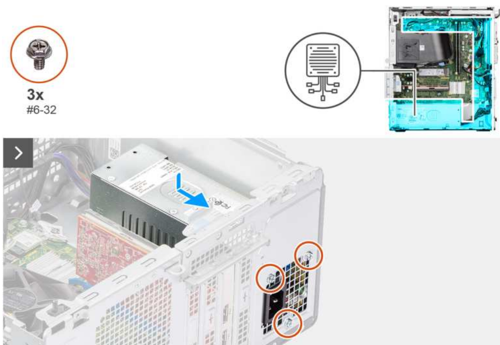
Rysunek 66. Instalowanie zasilacza
