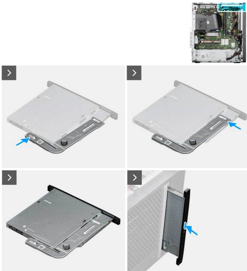
Rysunek 39. Instalowanie płaskiego napędu optycznego
