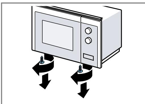
5. Rögzítse a mikrohullámú sütő aján a beépítő keretet a két külső csavarral.
