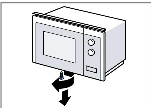
2. Снимите защитную панель со дна микроволновой печи.
