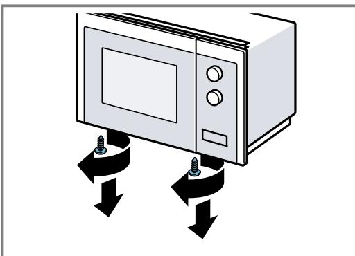
5. Прикрепите установочную рамку к основанию микроволновой печи двумя внешними винтами.
