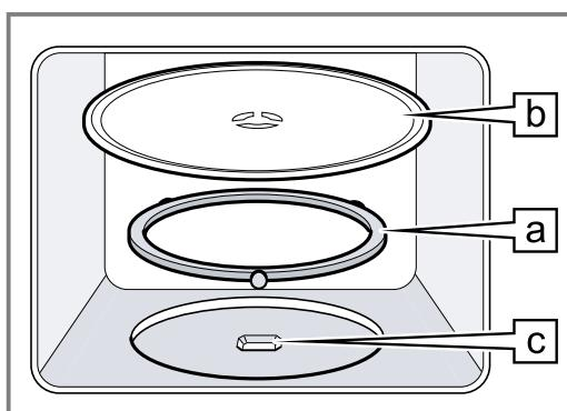
2. Fixați suportul rotativ **b** în piesa de antrenare **c** din centrul din spațiu interior al cuptorului.
