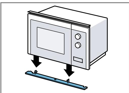
3. Зафиксируйте средний винт на основании микроволновой печи.
