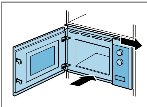
**3. Заворачивайте винты прибора до тех пор, пока он не будет выровнен по центру.**
