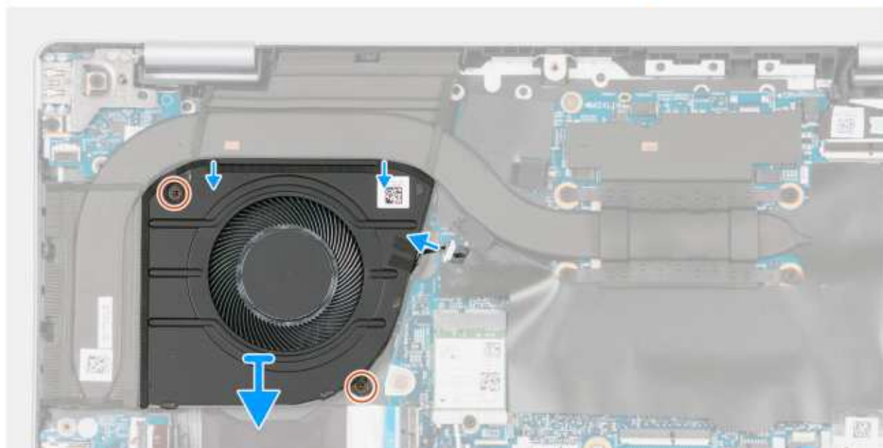
Rysunek 17. Wymontowywanie wentylatora
