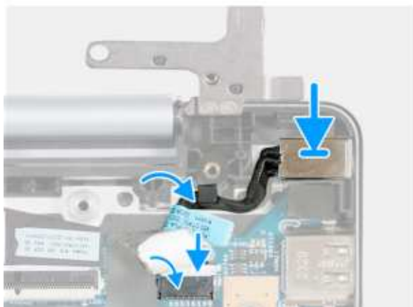
Rysunek 35. Instalowanie portu zasilacza
