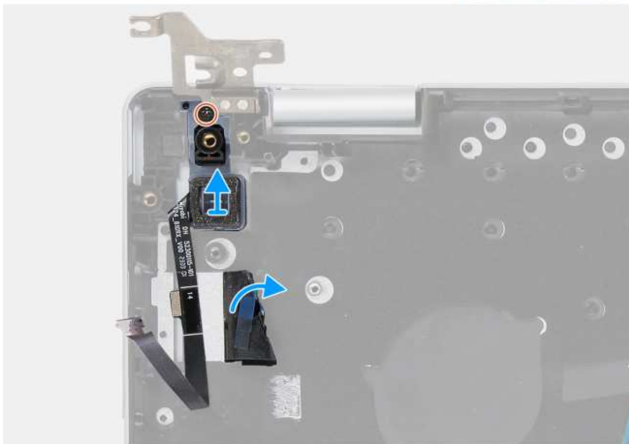
Rysunek 43. Wymontowywanie przycisku zasilania z opcjonalnym czytnikiem linii papilarnych
