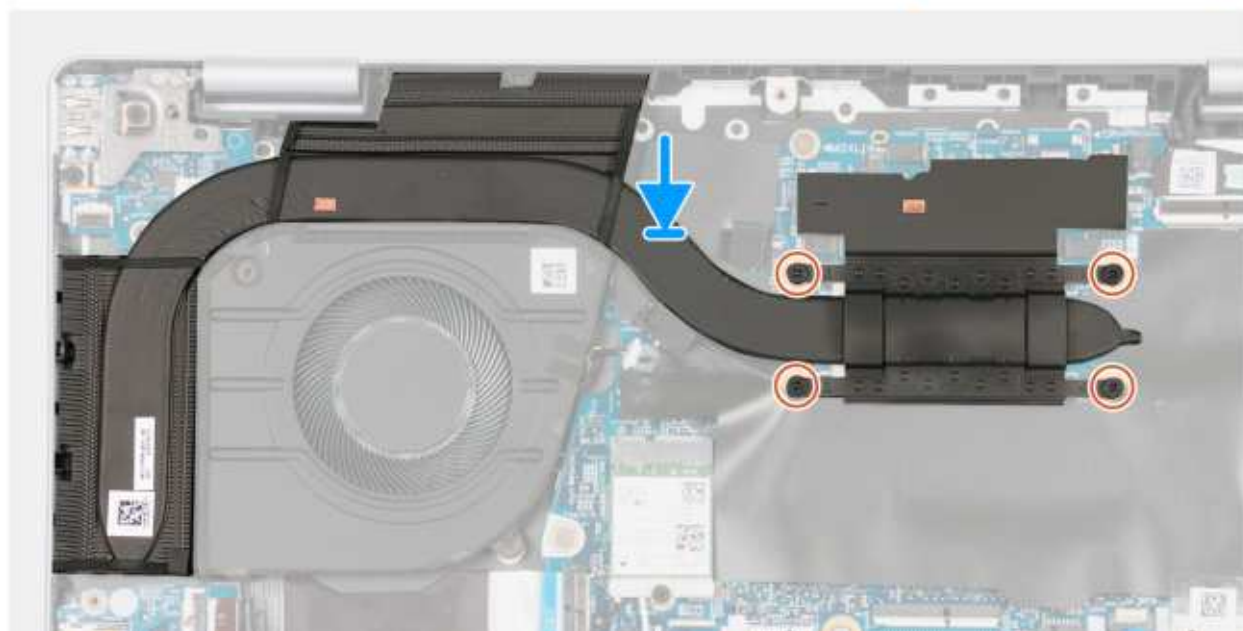
Rysunek 33. Instalowanie radiatora
