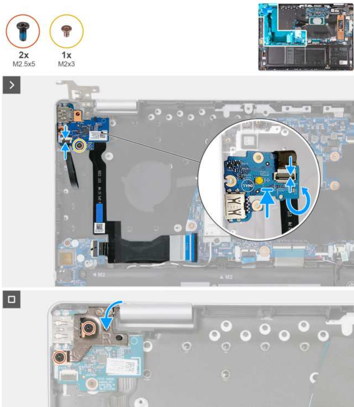
Rysunek 41. Instalowanie płyty USB
