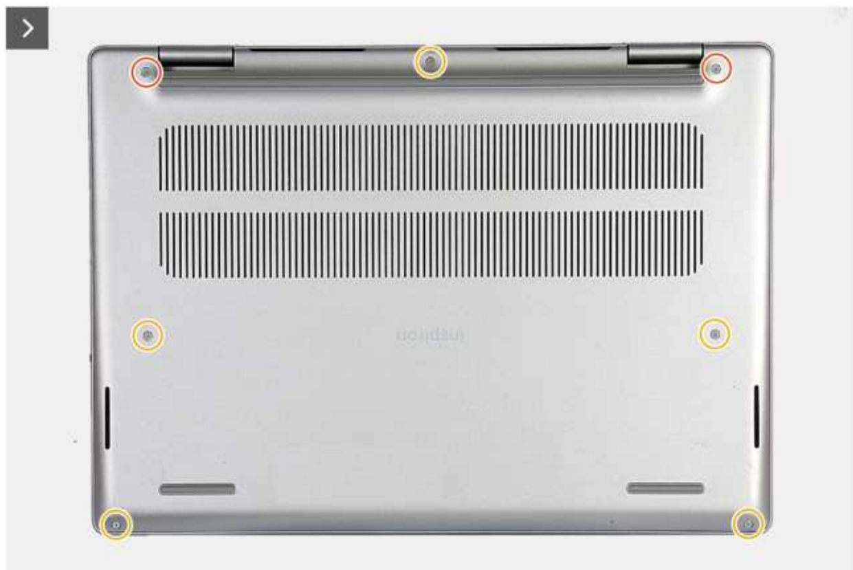
Rysunek 9. Wymontowywanie pokrywy dolnej
