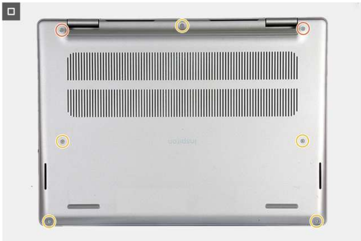
Rysunek 12. Instalowanie pokrywy dolnej — krok 2
