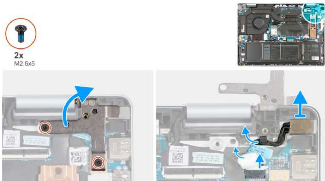
Rysunek 34. Wymontowywanie portu zasilacza
