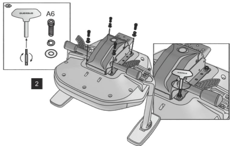
**3** Fixez l'équerre d'appui au mécanisme à l'aide des boulons B6 et d'une rondelle.
