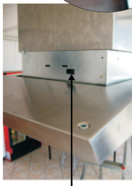
Otvory na háky v telese motoru (12b)
