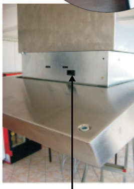
Otvory na háčky v tělese motoru (12b)
