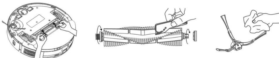
Wymij główną środkową szczotkę czyszczącą, naciskając dwie wypustki na pokrywie szczotki. Użyj narzędzia do czyszczenia, aby usunąć włosy zaplątane w główną szczotkę. Środkową szczotkę czyszczącą należy utrzymywać w stanie wolnym od dużych ilości włosów, kurzu, bawełny itp. Przynajmniej raz w tygodniu sprawdzaj boczną szczotkę czyszczącą wraz z otworem wlotu powietrza w zależności od intensywności zabrudzenia i usuwaj splątane włosy i inne zabrudzenia.
