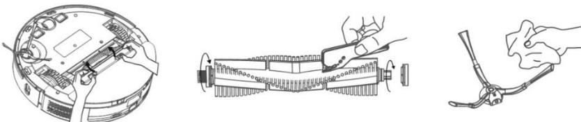
Entfernen Sie die mittlere Hauptbürste, indem Sie die beiden Laschen an der Bürstenabdeckung drücken. Verwenden Sie das Reinigungswerkzeug, um alle Haare zu entfernen, die sich in der Hauptbürste verfangen haben. Halten Sie die mittlere Reinigungsbürste frei von großen Mengen an Haaren, Staub, Watte usw. Überprüfen Sie die seitliche Reinigungsbürste zusammen mit der Lufteinlassöffnung je nach Verschmutzungsgrad mindestens einmal pro Woche und entfernen Sie verhedderte Haare und anderen Schmutz.
