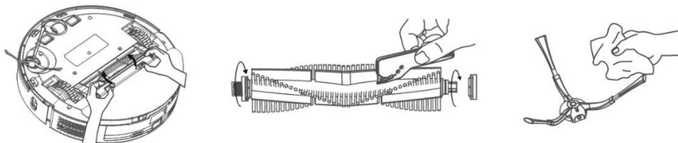
Hlavnú stredovú čistiacu kefu vyberte stlačením oboch úchytiak na kryte kefy. Na odstránenie vlasov zamotaných do hlavnej kefy použite čistiaci nástroj. Udržujte stredovú čistiacu kefu bez väčšieho množstva vlasov, prachu, bavlny a pod. Skontrolujte podľa intenzity znečistenia, minimálne raz týždenne, bočnú čistiacu kefu spoločne s otvorom na nasávanie vzduchu a odstráňte z neho namotané vlasy a ďalšie nečistoty.
