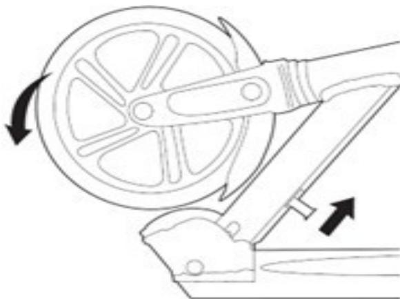
3. Um den Klappmechanismus zu lösen, halten Sie das T-Rohr mit einer Hand zwischen der Bundklemme und dem Schnellspannhebel und stellen Sie Ihren Fuß auf die Deckplatte. Ziehen Sie mit der anderen Hand den Kipphebel nach oben, um die Lenksäule aus ihrer verriegelten Position zu lösen und sie in die aufrechte Position drehen zu lassen.
