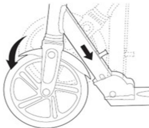
4 Dźwignia przegubu jest obciążona sprężyną i automatycznie blokuje się w pozycji pionowej po całkowitym wyprostowaniu.
