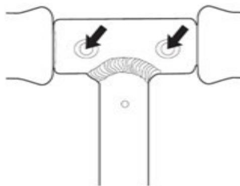
2. Ujistěte se, že pružinové tlačítko zapadlo do otvoru v T-rukojeti každé rukojeti.
