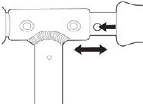
1. Setzen Sie den linken und rechten Lenker ein und sichern Sie ihn, indem Sie die Federknöpfe drücken und in das T-Rohr einführen.
