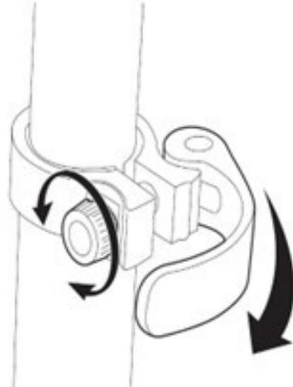
6 Die Spannung des Schnellspannhebels kann durch Anziehen oder Lösen der Inbusschraube eingestellt werden. Achten Sie darauf, dass Sie die Schraube nicht zu fest anziehen. Der Schnellspannhebel sollte immer manuell geöffnet und geschlossen werden können, und das T-Rohr sollte sich bei geöffnetem Schnellspannhebel frei bewegen lassen.
