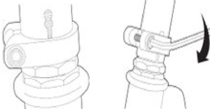
Prüfen Sie mit einem 5-mm-Inbusschlüssel, ob die Flanschklemmschraube fest angezogen ist. Dieses Bauteil wird im Werk angezogen und auf seine Qualität geprüft, aber es besteht eine geringe Chance, dass sich diese Schraube durch Transport oder Handhabung gelockert hat.
