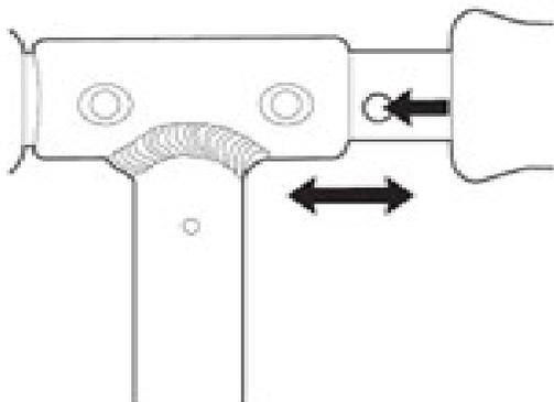
1. Włóż i zabezpiecz lewą i prawą kierownicę, naciskając przyciski sprężynowe i włóż je do rurki T.
