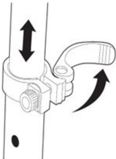
5 Chcete-li nastavit výšku řídítek, odemkněte prodlužovací trubku vytažením rychloupínací páčky směrem ven stisknutím tlačítka umístěného na prodlužovací trubce. Přesuňte trubku T do požadované polohy a zajistěte ji stisknutím rychloupínací páčky směrem dovnitř.
