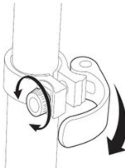
6 Napětí rychloupínací páky lze nastavit utažením nebo povolením imbusového šroubu. Je třeba dbát na to, abyste ho neutáhli příliš. Rychloupínací páku by mělo být vždy možné ručně otevřít a zavřít a T-trubka by se měla při otevřeném rychloupínači volně pohybovat.
