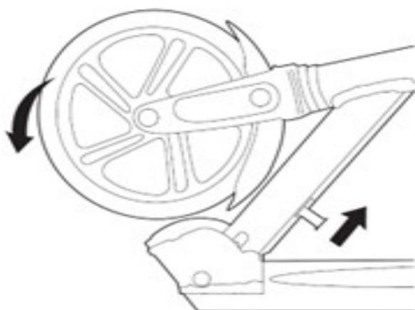
3. Aby zwolnić mechanizm składania, przytrzymaj rurę T jedną ręką między zaciskiem kołnierza a dźwignią szybkiego zwalniania i umieść stopę na płycie pokładu. Drugą ręką pociągnij dźwignię przegubu w górę, aby zwolnić kolumnę kierownicy z pozycji zablokowanej i umożliwić jej obrócenie do pozycji pionowej.
