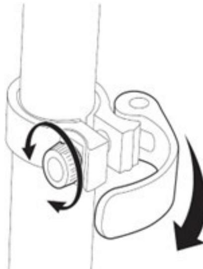
6 Napätie rýchlopínacej páky možno nastaviť utiahnutím alebo povolením imbusovej skrutky. Treba dbať na to, aby ste ju príliš neutiahli. Rýchlopínaciu páku by malo byť vždy možné ručne otvoriť a zatvoriť a T-trubica by sa mala voľne pohybovať s otvoreným rýchlopínačom.
