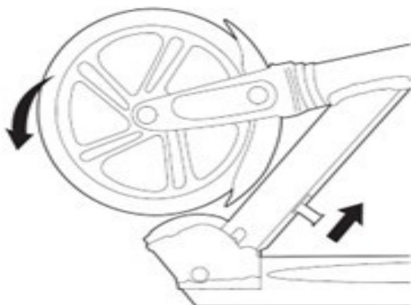
3. Ak chcete uvoľniť sklápací mechanizmus, jednou rukou pridržiňte T-trubicu medzi objímkou a pákou na rýchle uvoľnenie a položte nohu na dosku paluby. Druhou rukou potiahnite prepínaciu páčku smerom nahor, aby ste uvoľnili stĺpik riadenia z jeho uzamknutej polohy a umožnili jeho otočenie do zvislej polohy.
