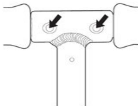
2. Uistite sa, že tlačidlo pružiny zapadlo do otvoru v T-rukoväti pre každú rukoväť.
