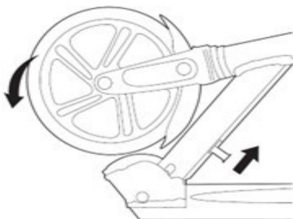
3. Chcete-li skládací mechanismus uvolnit, přidržte jednou rukou trubku T mezi objímkou a rychloupínací pákou a položte nohu na desku paluby. Druhou rukou zatáhněte za přepínací páčku směrem nahoru, čímž uvolníte sloupek řízení ze zajištěné polohy a umožníte mu otočit se do svislé polohy.
