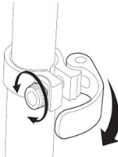
6 Napięcie dźwigni szybkiego zwalniania można regulować, dokręcając lub odkręcając śrubę imbusową. Należy uważać, aby nie dokręcić zbyt mocno. Zawsze powinna istnieć możliwość ręcznego otwarcia i zamknięcia dźwigni szybkiego zwalniania, a rura T powinna przesuwać się swobodnie przy otwartym szybkim zwalnianiu.
