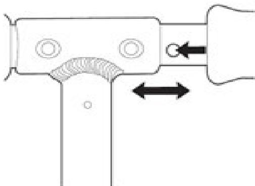
1. Vložte a zaistite ľavé a pravé riadidlá stlačením tlačidiel s pružinou a vložte ich do T-rúry.
