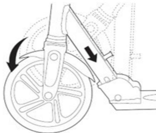
4. Otočná páka je odpružená a po úplném narovnání se automaticky zablokuje ve svislé poloze.
