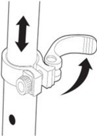
5 Um die Höhe des Lenkers einzustellen, entriegeln Sie das Verlängerungsrohr, indem Sie den Schnellspannhebel nach außen ziehen und den Knopf am Verlängerungsrohr drücken. Bringen Sie das T-Rohr in die gewünschte Position und sichern Sie es, indem Sie den Schnellspannhebel nach innen drücken.
