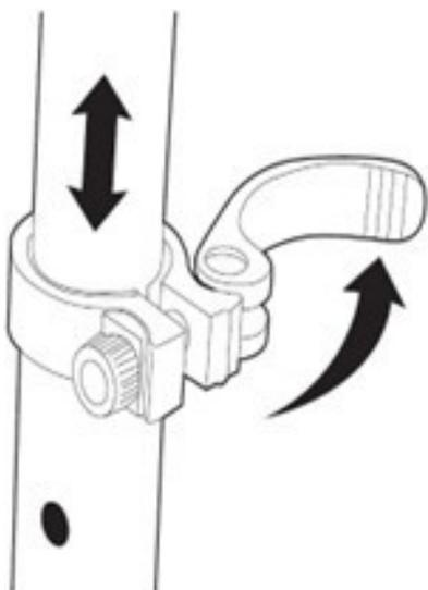
5 Ak chcete nastaviť výšku riadidiel, odomknite predlžovaciu rúrku vytiahnutím rýchlopínacej páčky smerom von stlačením tlačidla umiestneného na predlžovacej rúrke. Posuňte T-rúrku do požadovanej polohy a zaistite ju stlačením páčky rýchlopínača smerom dovnútra.
