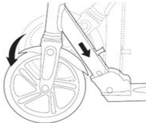
4 Der Schwenkhebel ist federbelastet und rastet automatisch in der vertikalen Position ein, wenn er ganz aufrecht steht.
