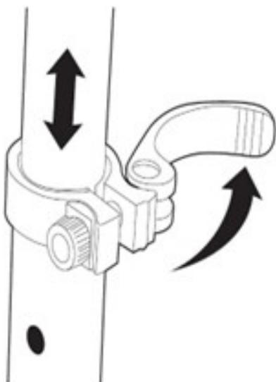
5 Aby wyregulować wysokość kierownicy, należy odblokować rurę przedłużającą, pociągając na zewnątrz dźwignię szybkiego zwalniania, naciskając przycisk znajdujący się na rurze przedłużającej. Przesuń rurkę T do żądanej pozycji i zabezpiecz ją, naciskając dźwignię szybkiego zwalniania do wewnątrz.
