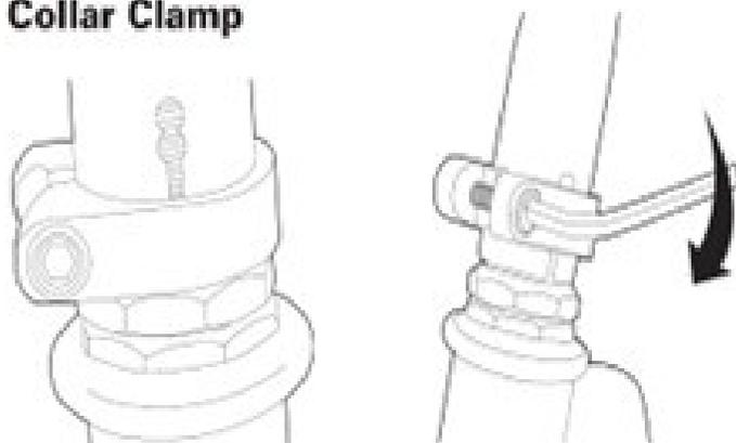
Pomocí 5mm imbusového klíče zkontrolujte, zda je šroub přírubové svorky pevně utažen. Tato součást je utažena a zkontrolována ve výrobě, ale existuje malá pravděpodobnost, že vlivem přepravy nebo manipulace se tento šroub uvolnil.
