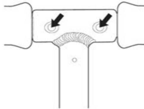
2. Achten Sie darauf, dass der Federknopf bei jedem Lenker in das Loch im T-Lenker einrastet.
