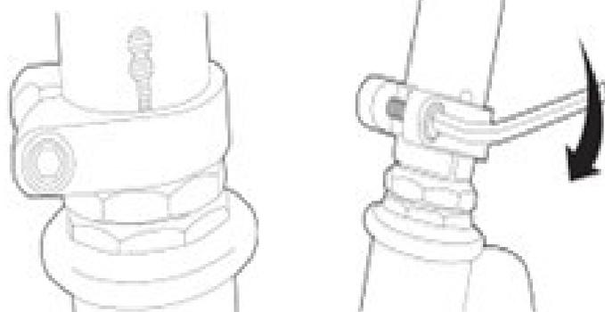
Pomocou 5 mm imbusového kľúča skontrolujte, či je skrutka prírubovej svorky pevne dotiahnutá. Tento komponent je dotiahnutý a skontrolovaný vo výrobe, ale existuje malá pravdepodobnosť, že vplyvom prepravy alebo manipulácie sa táto skrutka uvoľnila.
