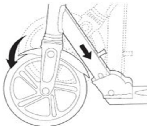
4. Otočná páka je odpružená a po úplnom narovnaní sa automaticky zaistí vo vertikálnej polohe.
