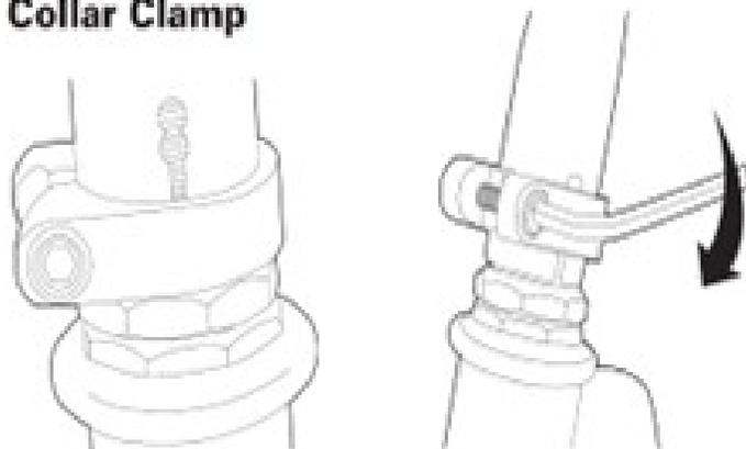
Za pomocą klucza imbusowego 5 mm sprawdź, czy śruba zacisku kołnierza jest dobrze dokręcona. Ten element jest dokręcany i sprawdzany pod względem jakości w fabryce, ale istnieje niewielka szansa, że skutki transportu lub obsługi mogły spowodować poluzowanie tej śruby.
