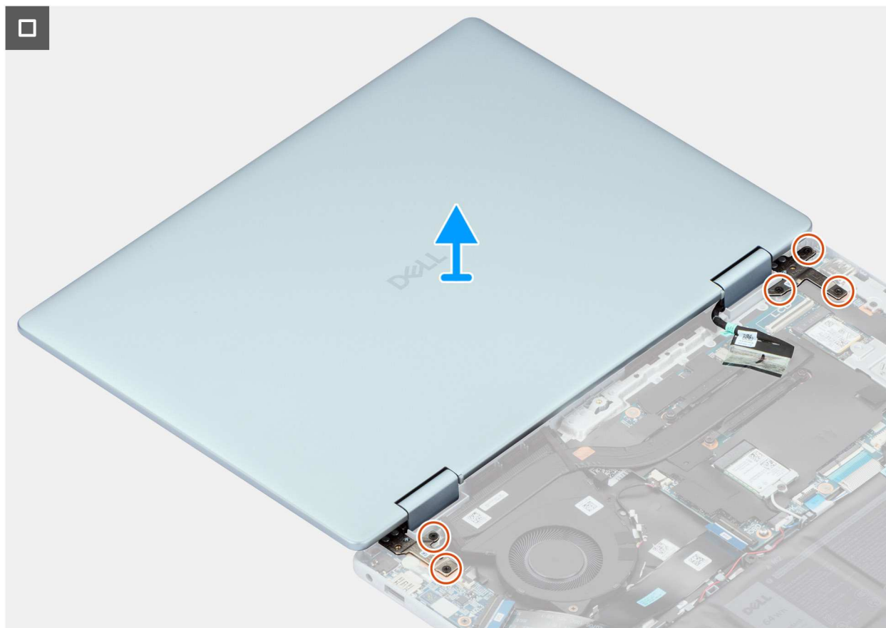
Rysunek 43. Wymontowywanie zestawu wyświetlacza
