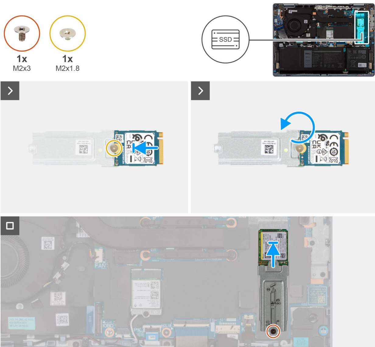
Rysunek 23. Instalowanie dysku SSD
