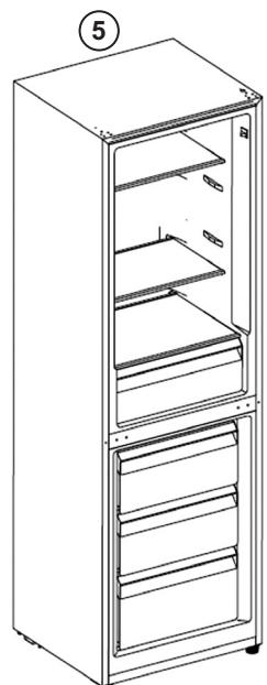
5. Vezměte dvířka mrazničky, ujistěte se, že osa spodního závěsu a otvor na osu na spodní levé straně spotřebiče dobře drží a správně zapadají. Nyní jsou dvířka mrazničky v podstatě připevněná; poté za pomoci dvou šroubů připevněte středový závěs na levou stranu skříně; pak středový závěs utáhněte (jak je znázorněno na obr. 6).
