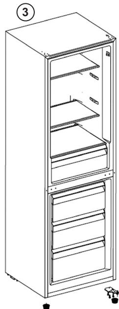
4. Stavitelnou nožičku, která je původně na levé straně, přišroubujte na odpovídající pozici na pravé straně pod skříní. Spodní závěs otočte o 180 stupňů a osu spodního závěsu připevněte do otvoru pro dolní závěs. Poté závěsy i šrouby utáhněte; stejně tak stavitelnou nožičku, která je původně na pravé straně, přišroubujte na odpovídající místo na levé straně pod skříní; poté utáhněte šrouby, které drží spodní závěs.
