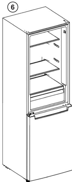
6. Vezměte dvířka chladničky, ujistěte se, že osa spodního závěsu a otvor na osu na spodní levé straně spotřebiče dobře drží a správně zapadají; nyní jsou dvířka chladničky v podstatě připevněná. Poté použijte šrouby, které jste vyjmuli v prvním kroku, k připevnění horního závěsu na levou stranu skříně; nasaděte kryt horního závěsu a přisroubujte.
