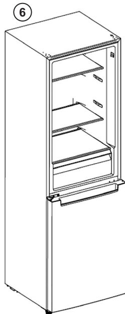
6. Vezmite dvierka chladničky, uistite sa, že os spodného závesu a otvor na os na spodnej ľavej strane spotrebiča dobre drží a správne zapadajú; teraz sú dvierka chladničky v podstate pripojená. Potom použite skrutky, ktoré ste vybrali v prvom kroku, na pripojenie horného závesu na ľavú stranu skrine; nasadte kryt horného závesu a priskrutkujte.
