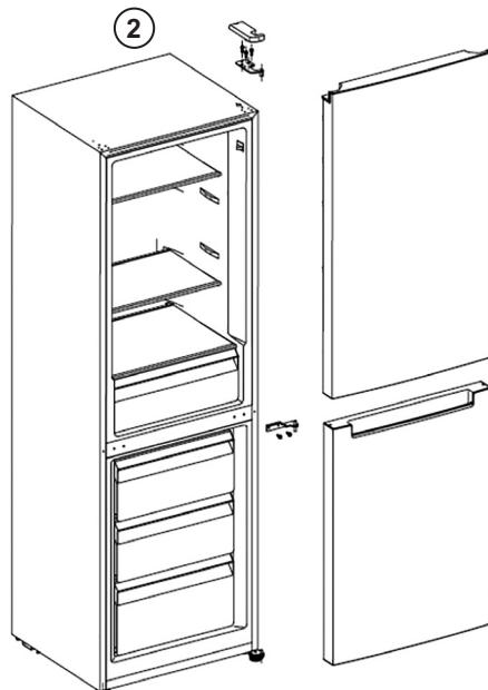
3. Vyšroubujte tři šrouby, které drží spodní závěs pod pravou stranou skříně. Sejměte spodní závěs a stavitelnou nožičku pod spodním závěsem pod pravou stranou skříně. Současně klíčem vyšroubujte šrouby, které drží osu závěsu; poté sejměte stavitelnou nožičku na spodní levé straně pod levou stranou skříně.
