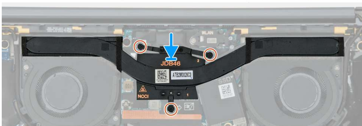
Rysunek 36. Installing the heat sink
