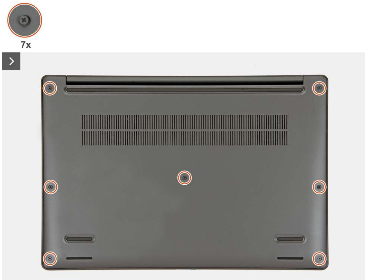
Rysunek 14. Loosen the captive screws
