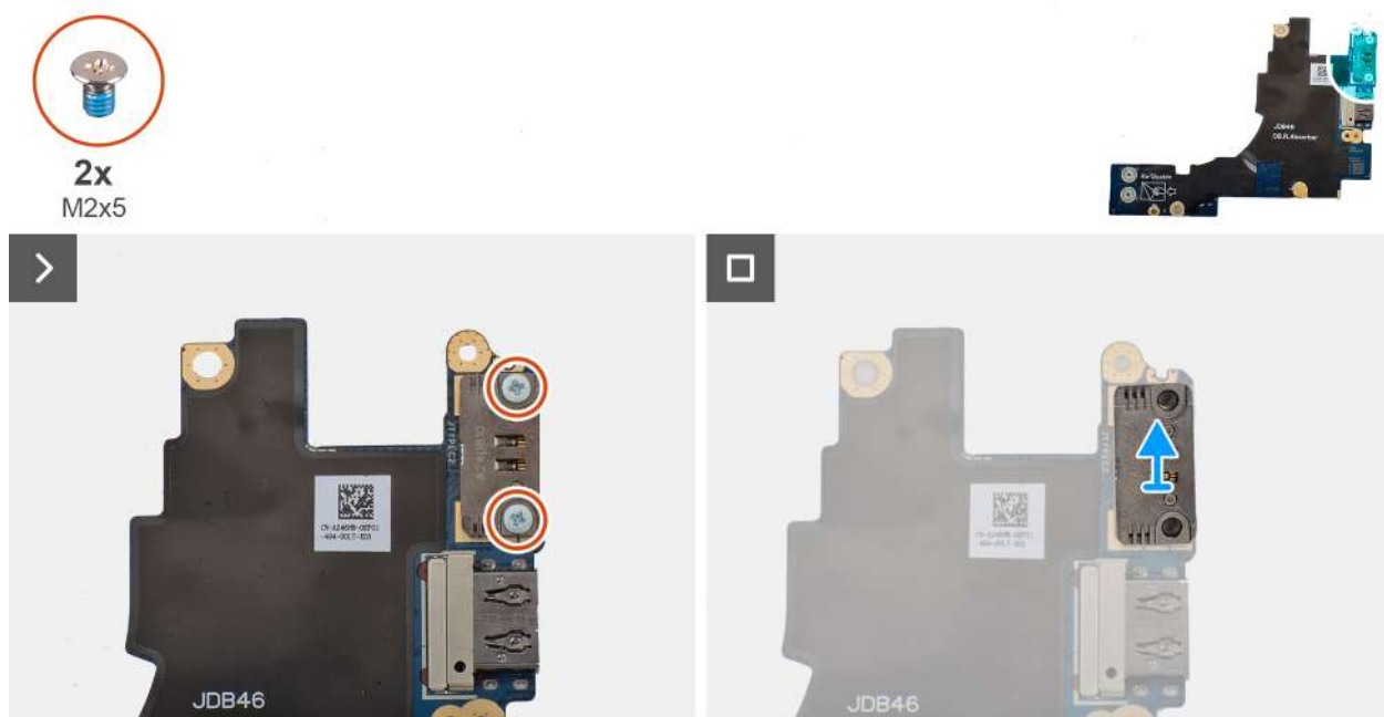
Rysunek 53. Removing the left USB Type-C module
