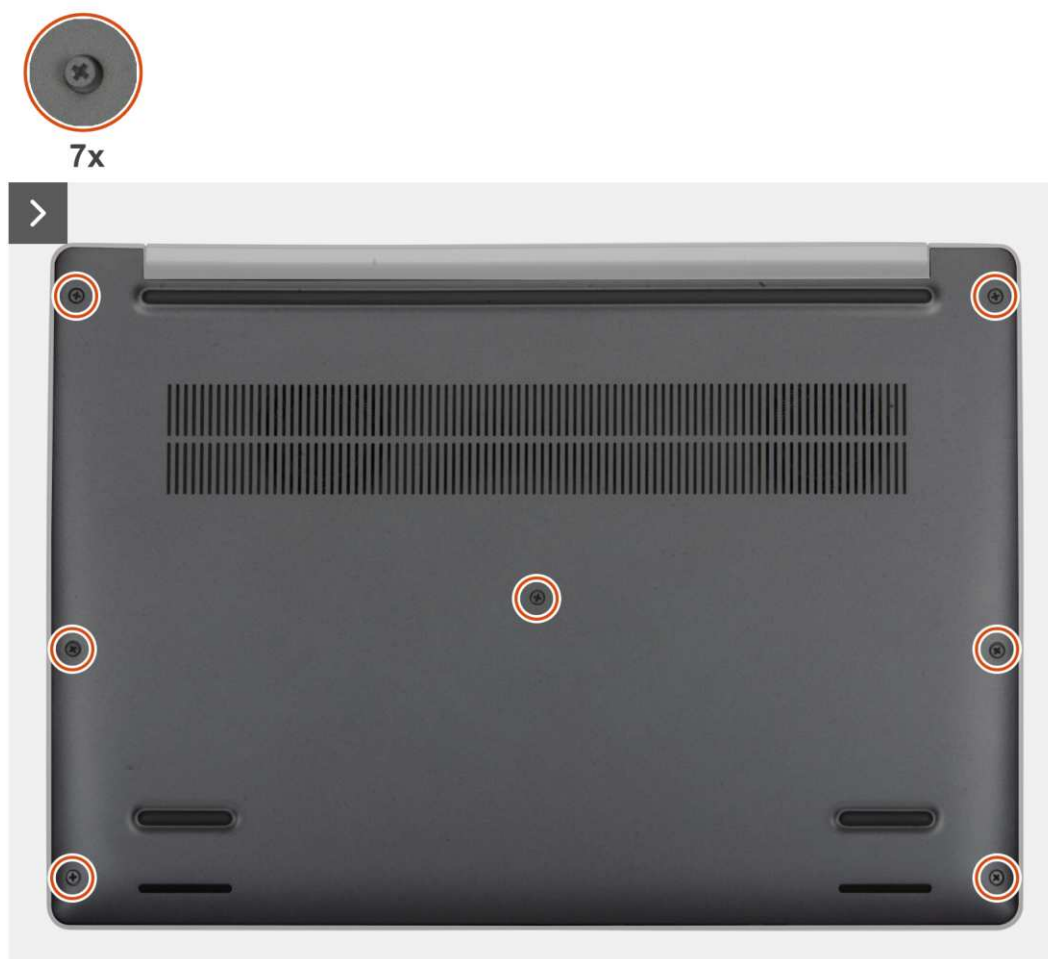
Rysunek 14. Luzowanie śrub mocujących
