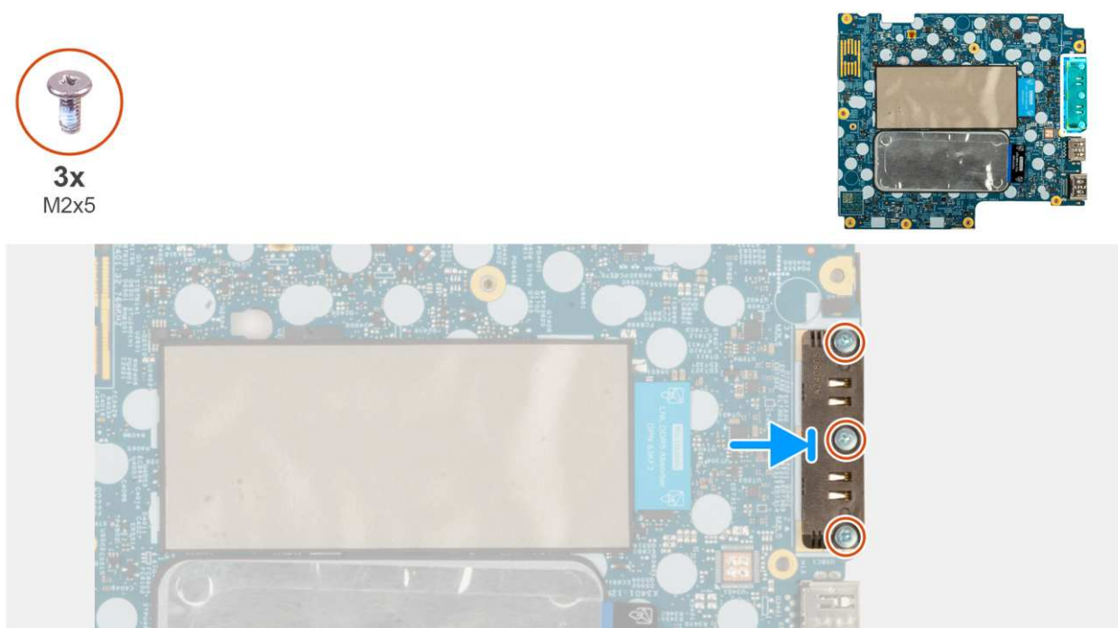
Rysunek 53. Instalowanie modułu złącza USB-C
