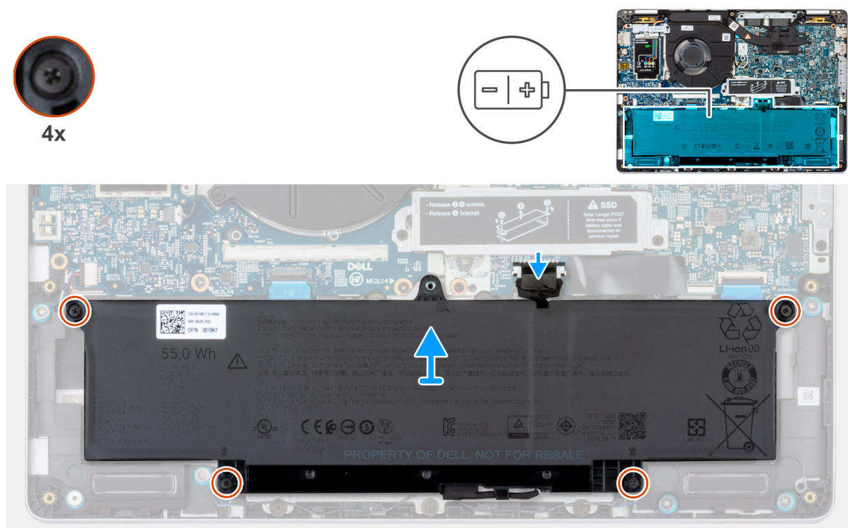
Rysunek 18. Instalowanie baterii
