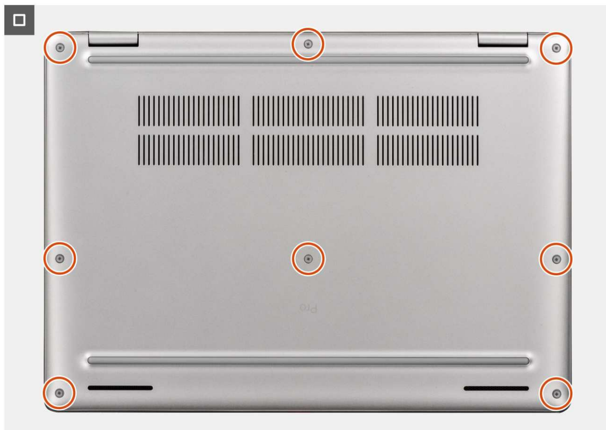
Rysunek 23. Instalowanie pokrywy dolnej
