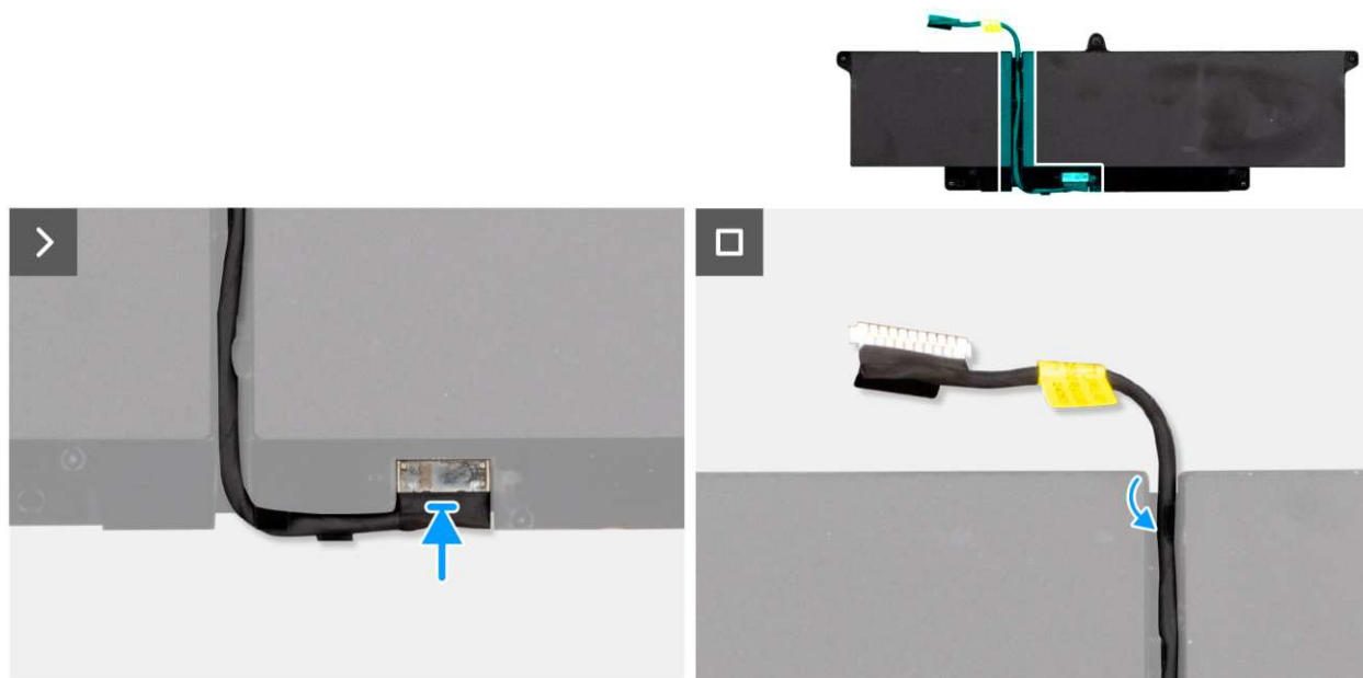
Rysunek 26. Wymiana kabla baterii
