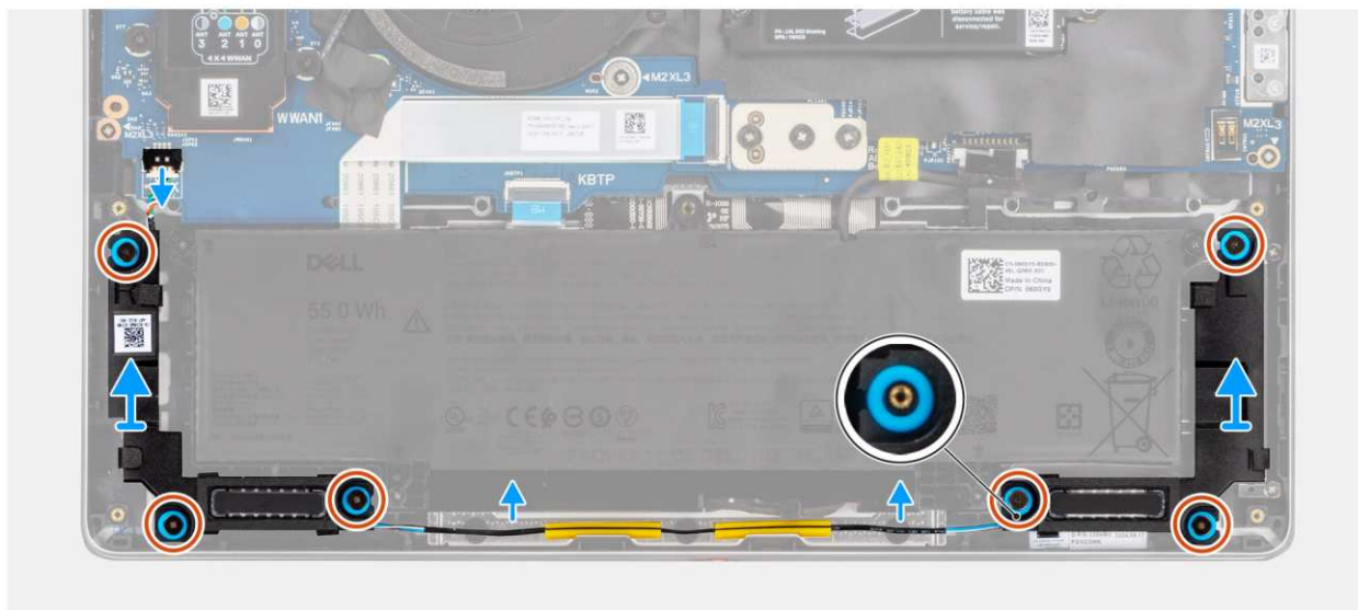
Rysunek 34. Wymontowywanie głośników
