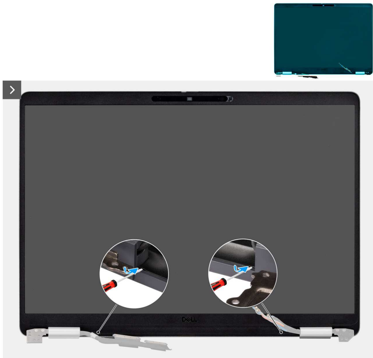
Rysunek 43. Podważanie plastikowej ramki
