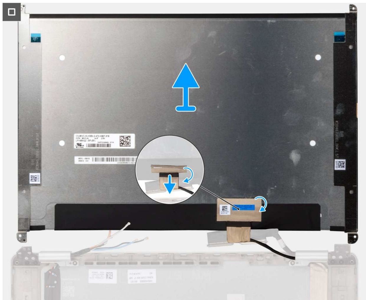
Rysunek 50. Wyjmij kabel wyświetlacza z pokrywy tylnej wyświetlacza.
