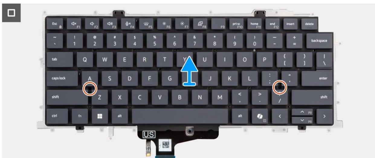
Rysunek 80. Wymontowywanie klawiatury
