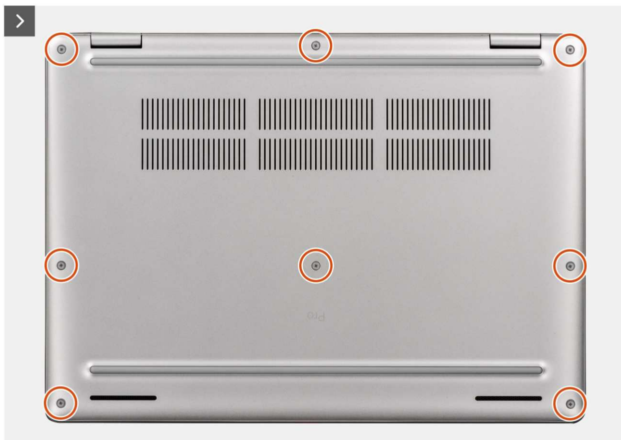
Rysunek 19. Wymontowywanie pokrywy dolnej
