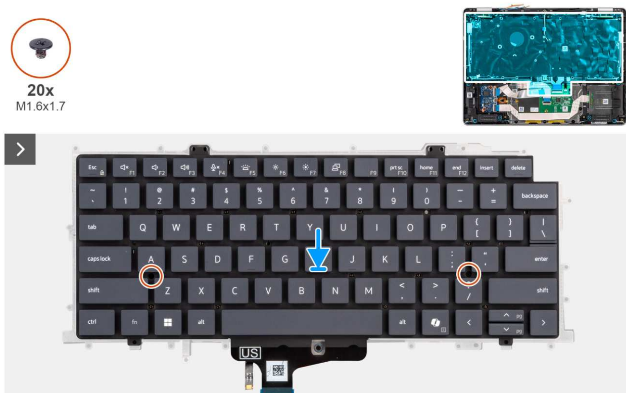
Rysunek 81. Instalowanie klawiatury
