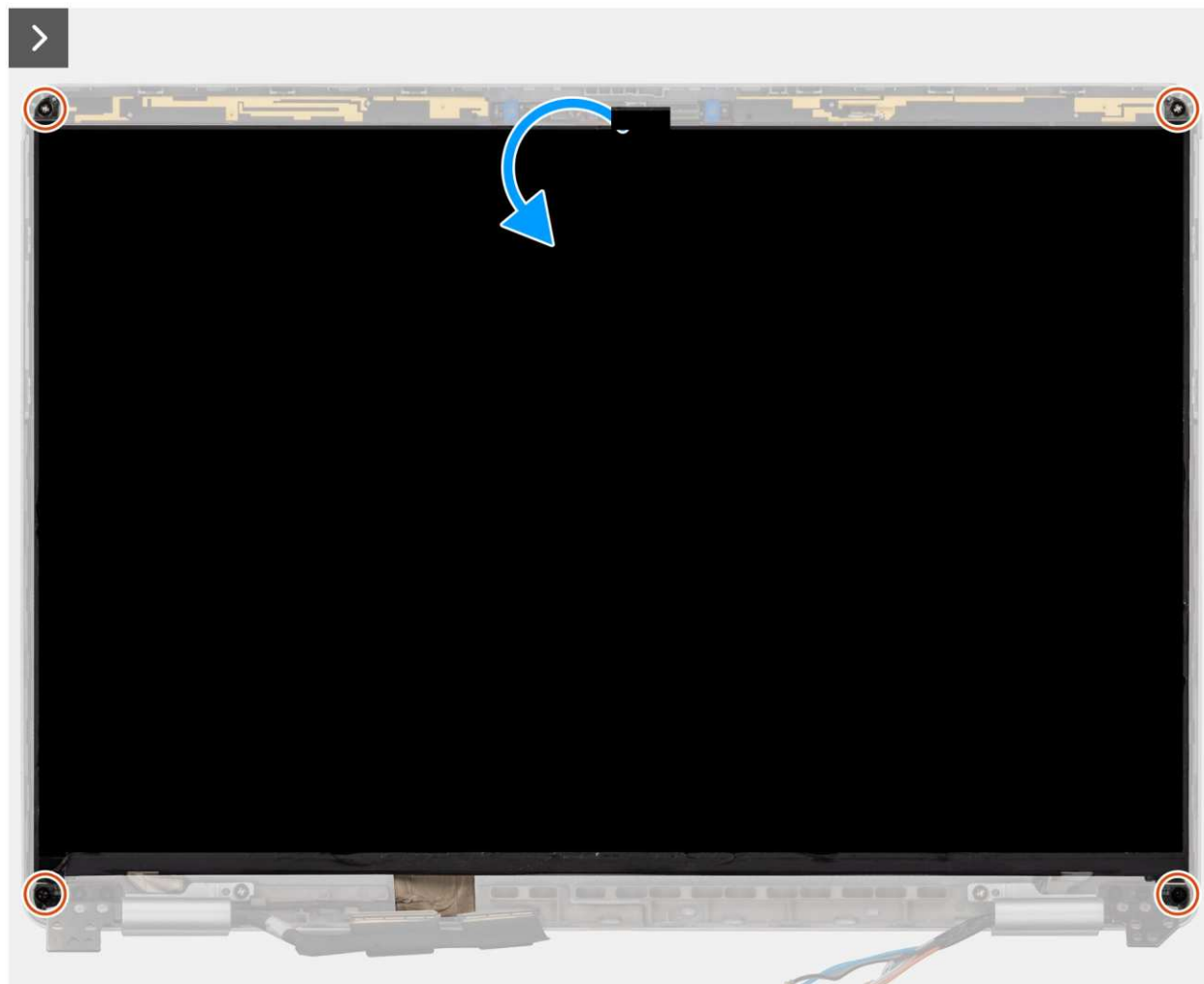
Rysunek 49. Wymontowywanie wyświetlacza
