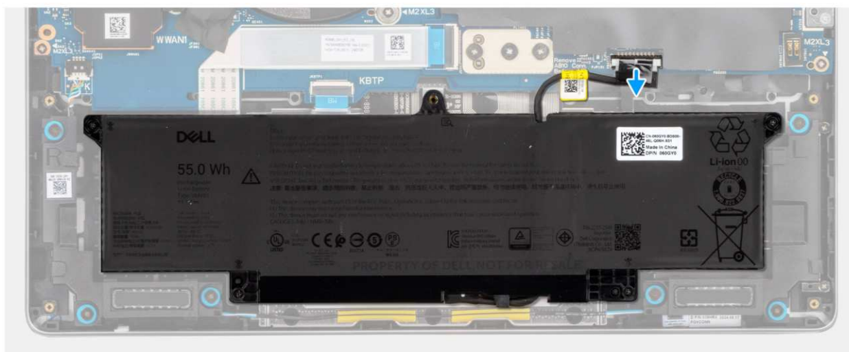
Rysunek 21. Odłączanie kabla baterii
