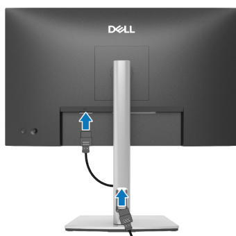
Rysunek 30. Porządkowanie kabli
