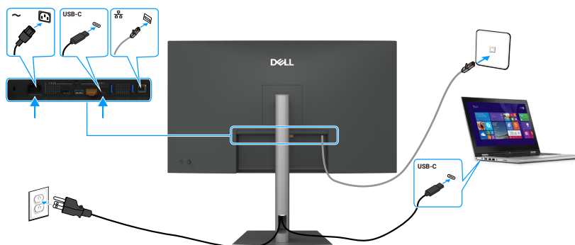
Rysunek 34. Połączenie monitora dla kabla RJ45
