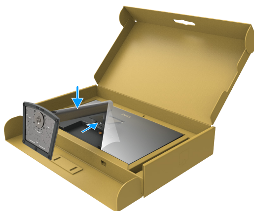
Rysunek 20. Wsuń zaczepy zespołu płyty wspornika do gniazd
