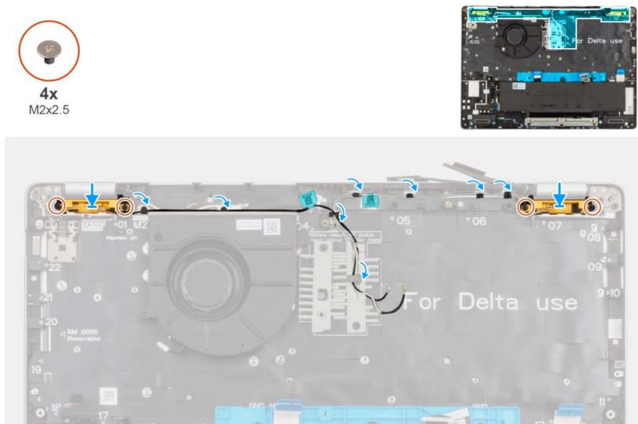
Rysunek 77. Instalowanie anteny sieci bezprzewodowej
