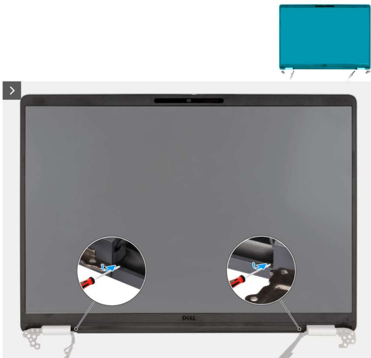
Rysunek 61. Podważanie plastikowej ramki
