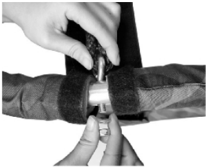
Drehen Sie die Mutter, ohne die Unterlegscheibe zu vergessen. Ziehen Sie die Mutter mit Hilfe eines Schraubenschlüssels fest. Wiederholen Sie den Vorgang für 3 weitere Schrauben
