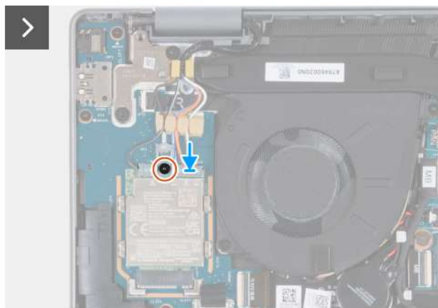
Rysunek 28. Instalowanie karty sieci WWAN 5G
