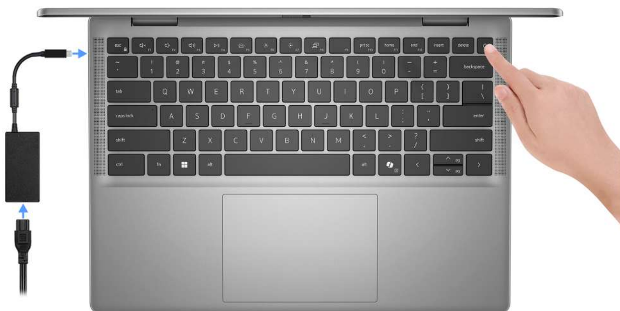
Rysunek 7. Podłącz zasilacz i naciśnij przycisk zasilania
