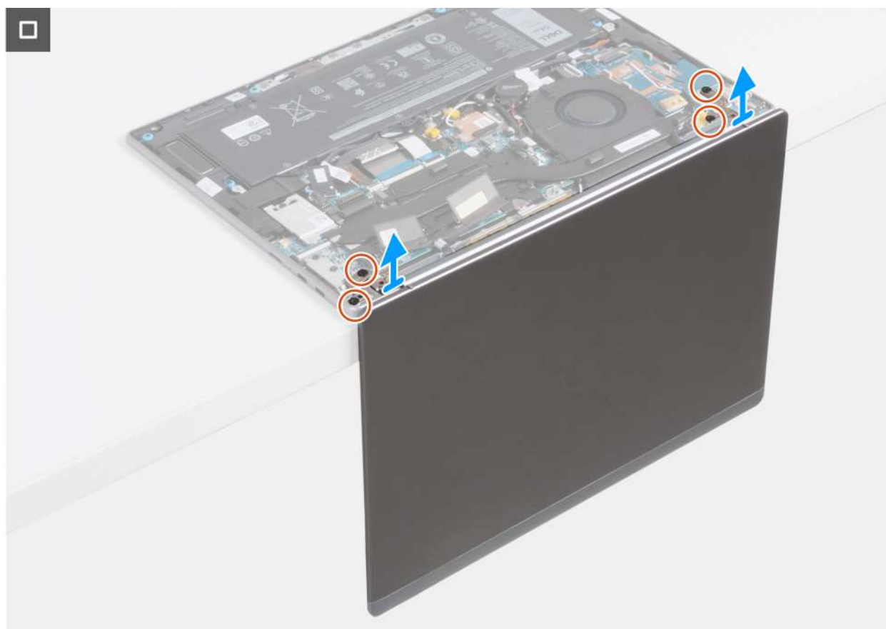
Rysunek 78. Wymontowywanie zestawu wyświetlacza (dotyczy komputerów dostarczanych z obsługą WWAN)
