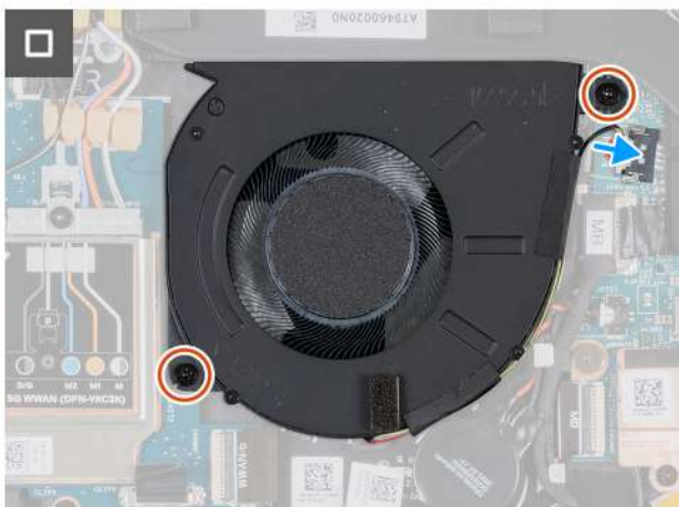
Rysunek 38. Instalowanie wentylatora (dotyczy komputerów dostarczanych z obsługą sieci WWAN)
