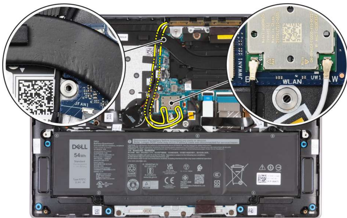
Rysunek 62. Instalowanie kabli anteny sieci WLAN
