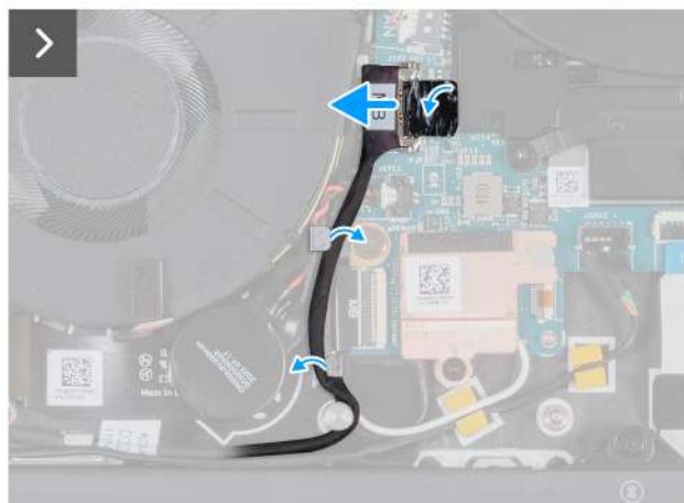
Rysunek 46. Wymontowywanie baterii pastylkowej
