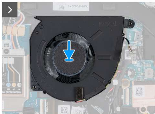
Rysunek 38. Instalowanie wentylatora (dotyczy komputerów dostarczanych z obsługą sieci WWAN)
