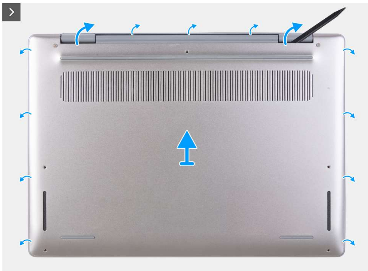
Rysunek 16. Wymontowywanie pokrywy dolnej
