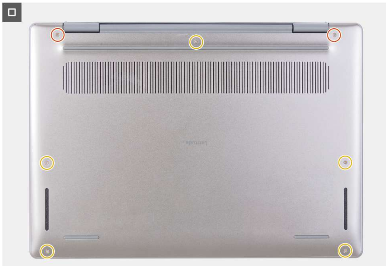
Rysunek 20. Dokręcanie i wymiana śrub
