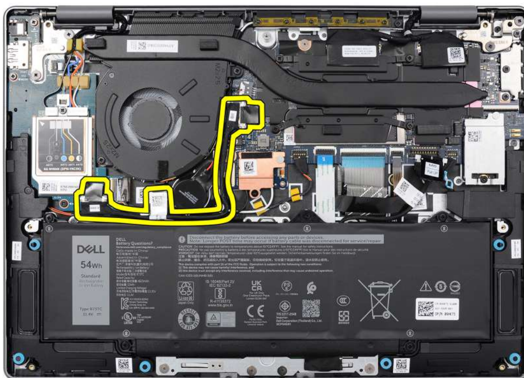
Rysunek 54. Umiejscowienie kabla płyty we/wy
