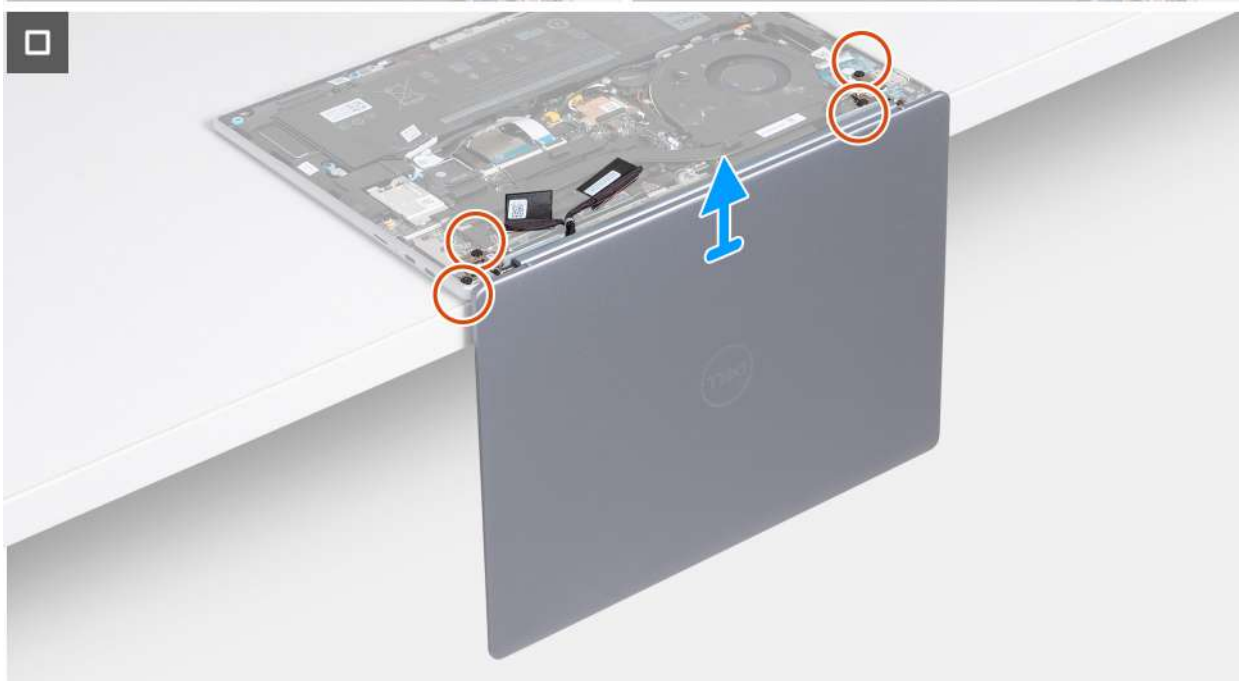
Rysunek 74. Wymontowywanie zestawu wyświetlacza (dotyczy komputerów dostarczanych z obsługą wyłącznie WLAN)
