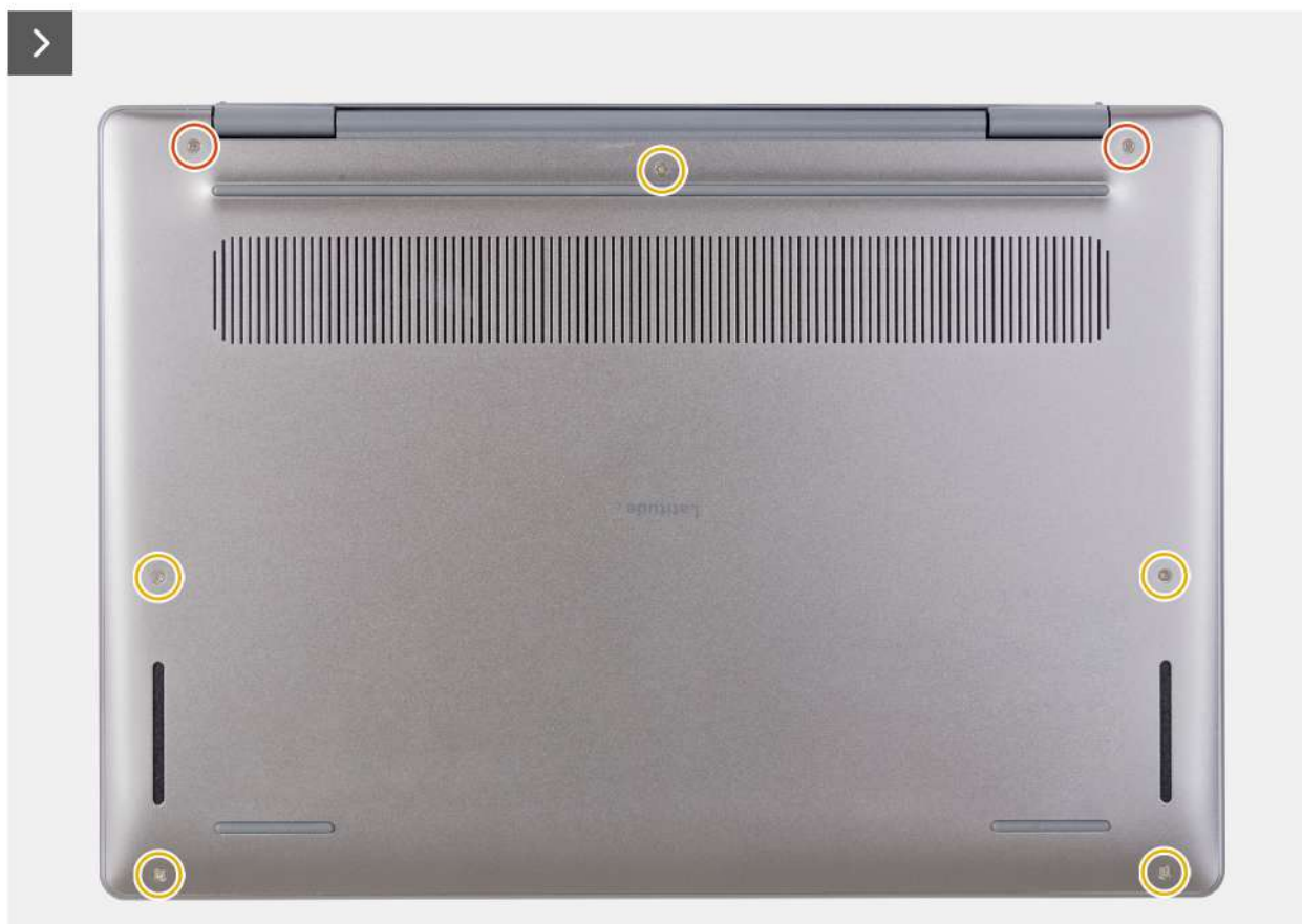
Rysunek 15. Wymontowywanie pokrywy dolnej
