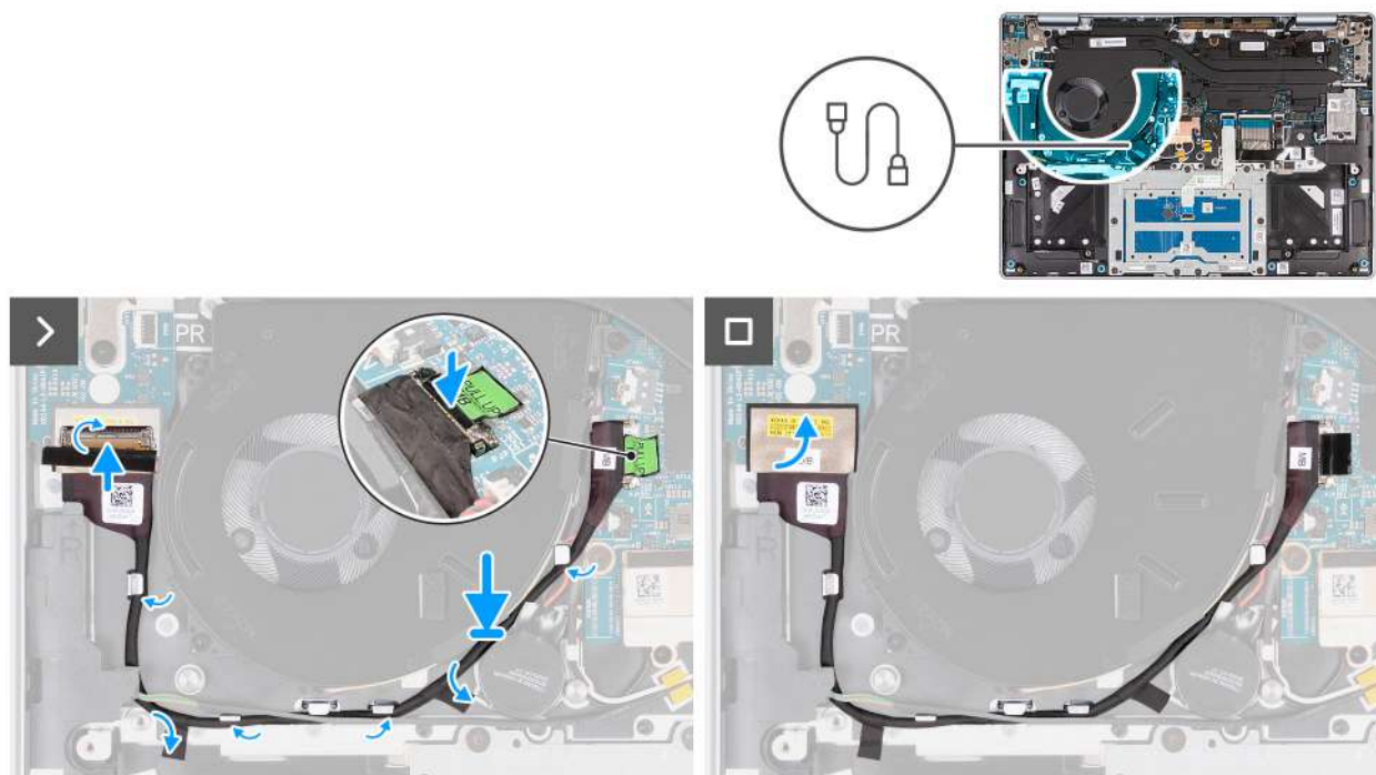
Rysunek 51. Instalowanie kabla płyty we/wy (dotyczy komputerów dostarczanych z obsługą wyłącznie sieci WLAN)
