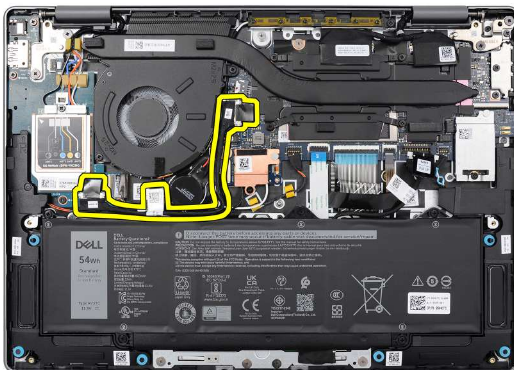
Rysunek 52. Umieszczenie kabla płyty we/wy
