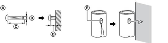
**(A)** Śruba (brak w zestawie) pasująca do otworu montażowego w ścianie z tyłu głośników
