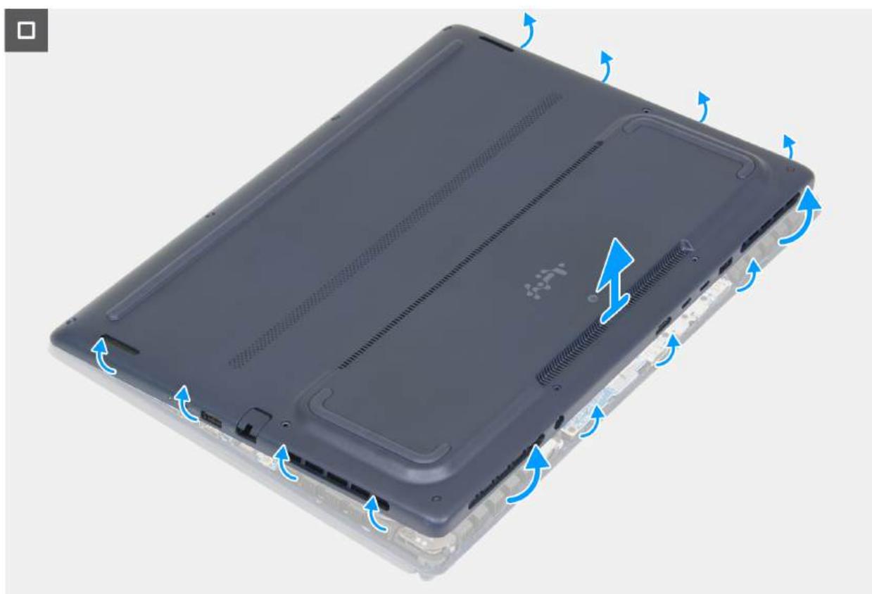
Rysunek 13. Wymontowywanie pokrywy dolnej
