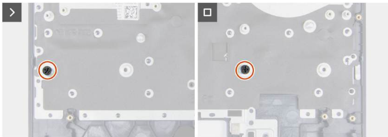
Rysunek 72. Wkręcanie uchwytów na śruby dysku SSD
