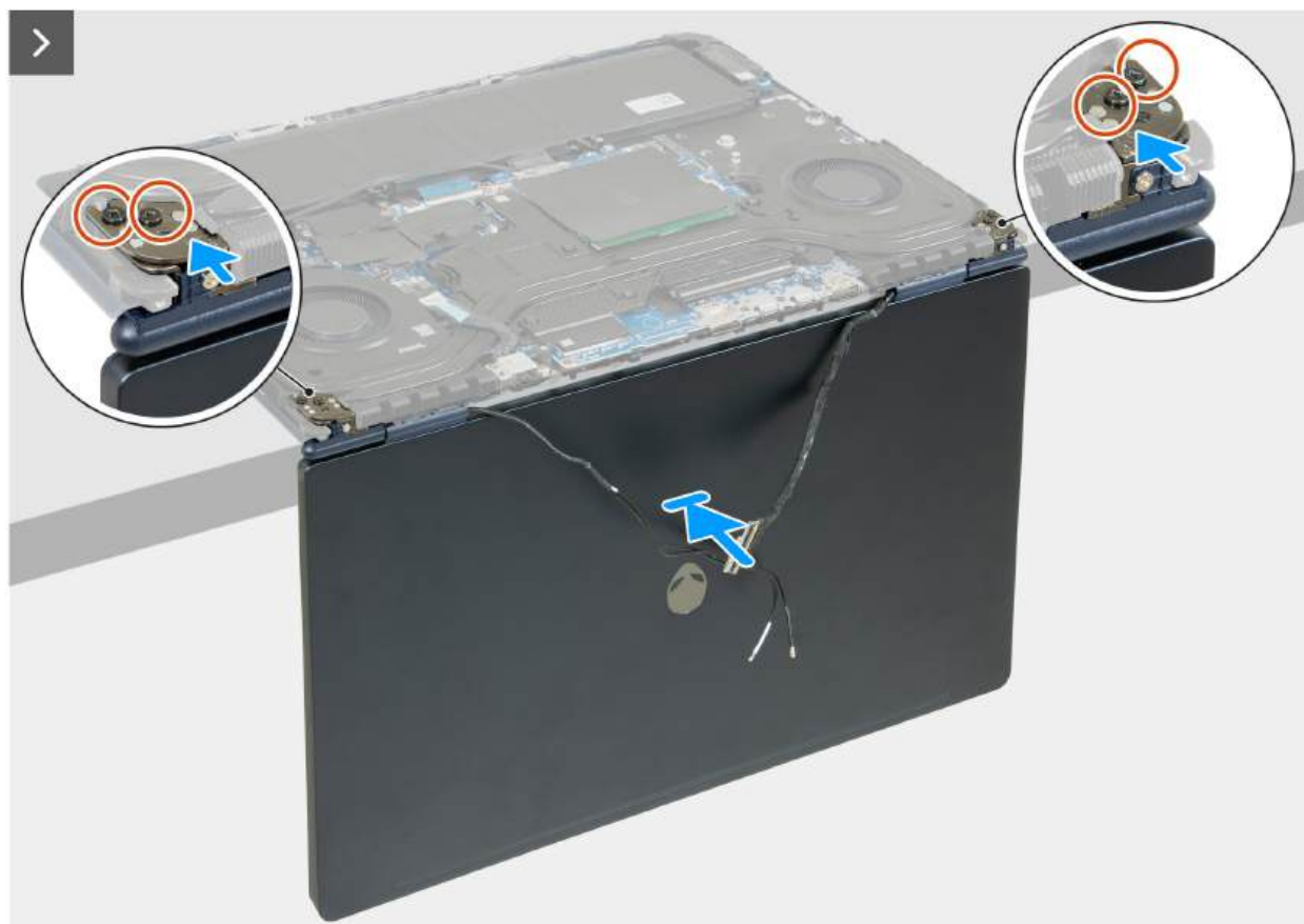
Rysunek 68. Instalowanie zestawu wyświetlacza
