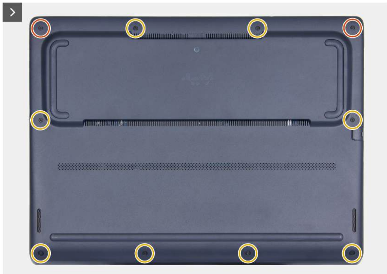
Rysunek 11. Wymontowywanie pokrywy dolnej
