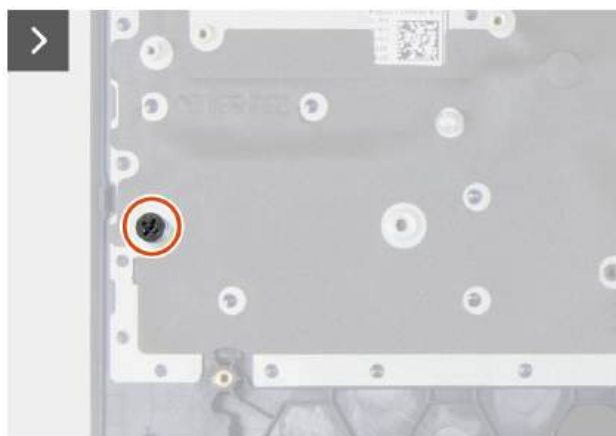
Rysunek 71. Wymontowywanie uchwytych na śruby dysku SSD
