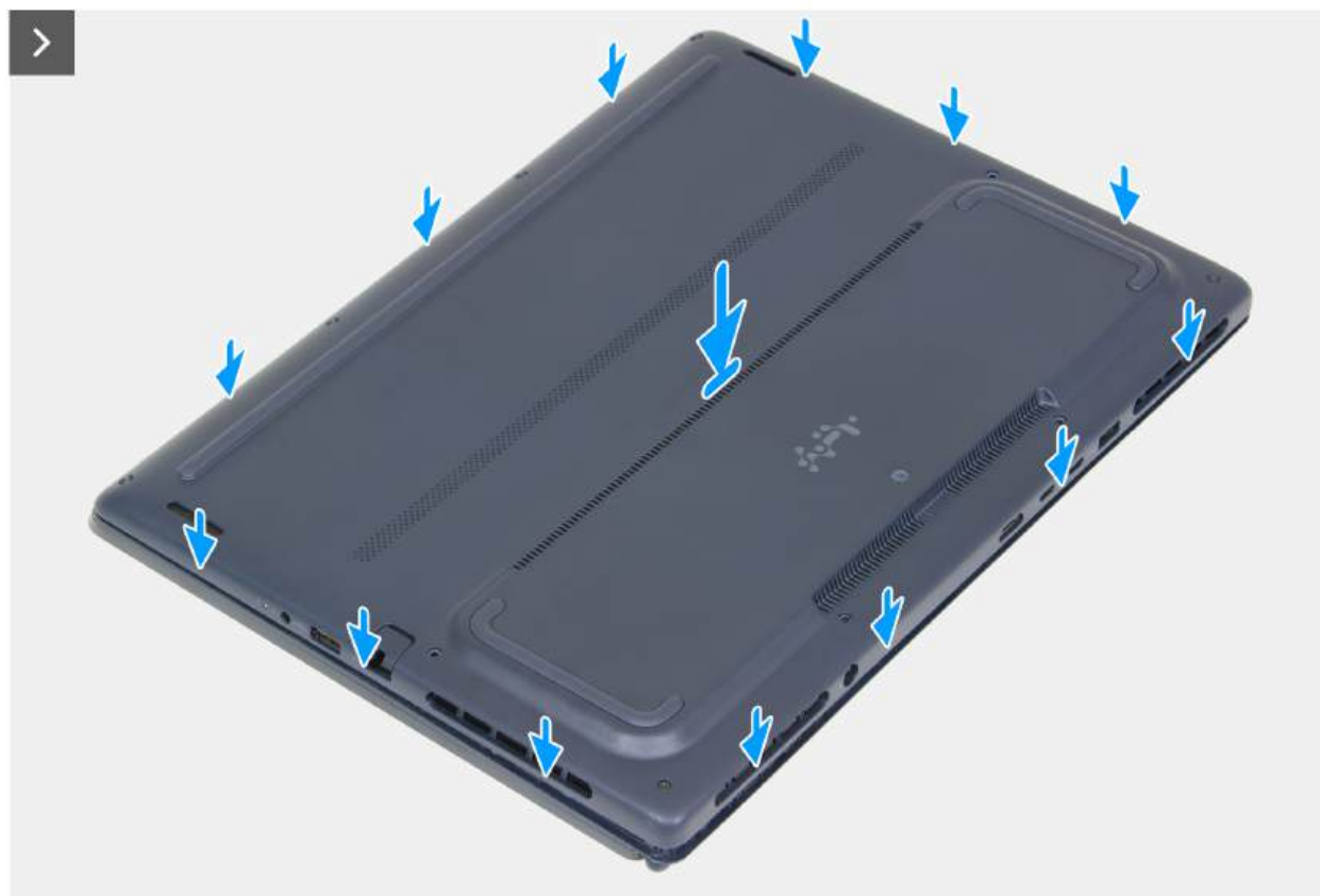
Rysunek 16. Instalowanie pokrywy dolnej
