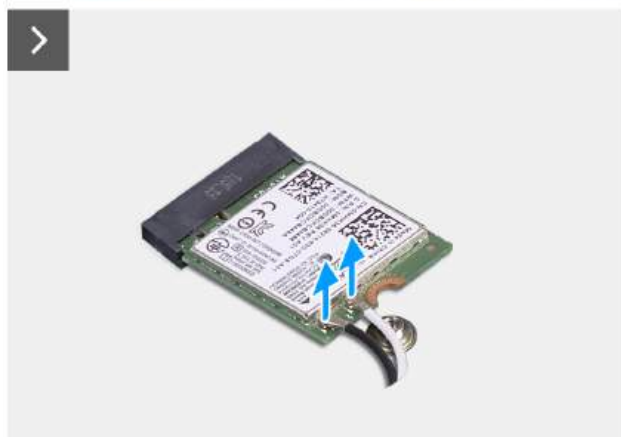
Rysunek 32. Wymontowywanie karty sieci bezprzewodowej
