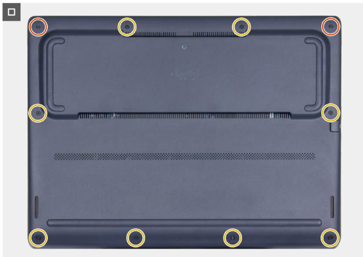
Rysunek 17. Instalowanie pokrywy dolnej
