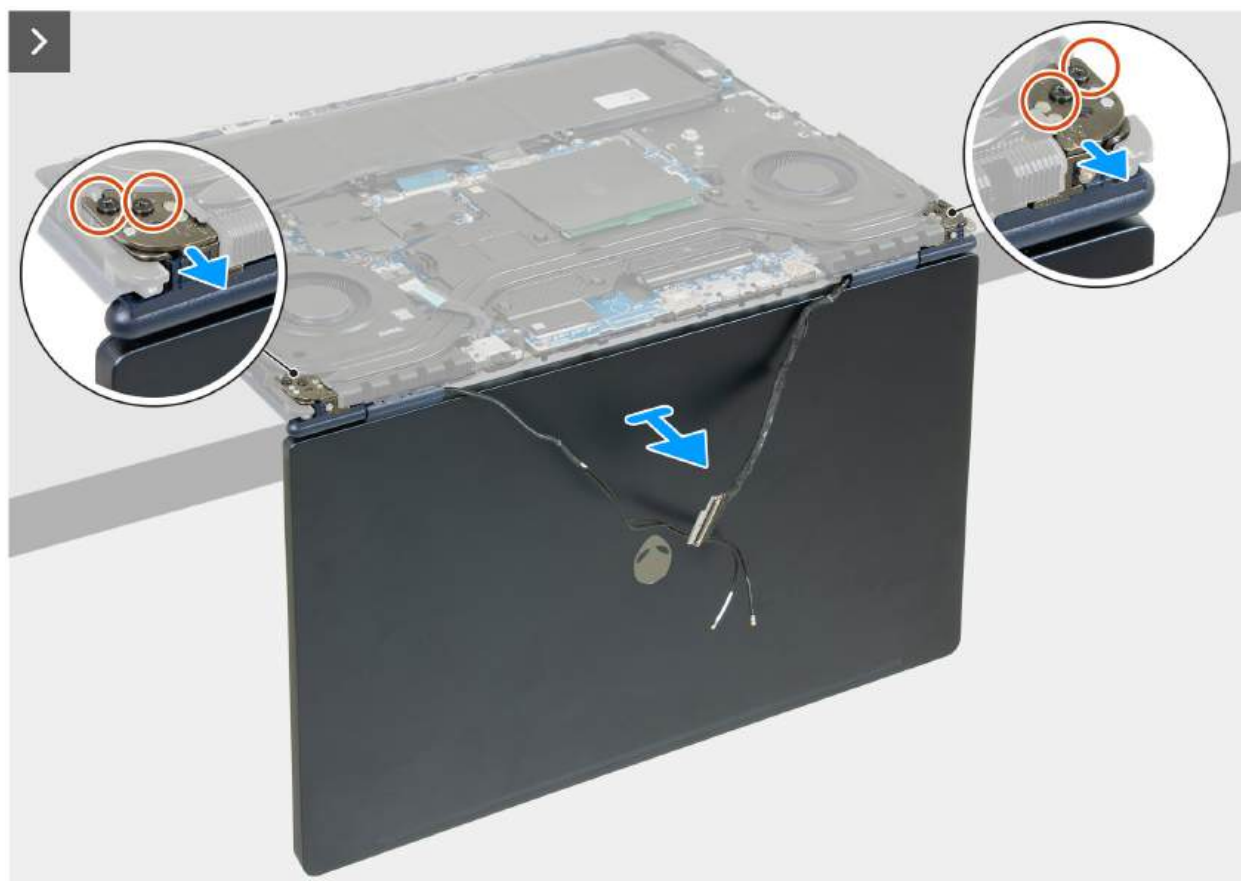
Rysunek 66. Wymontowywanie zestawu wyświetlacza
