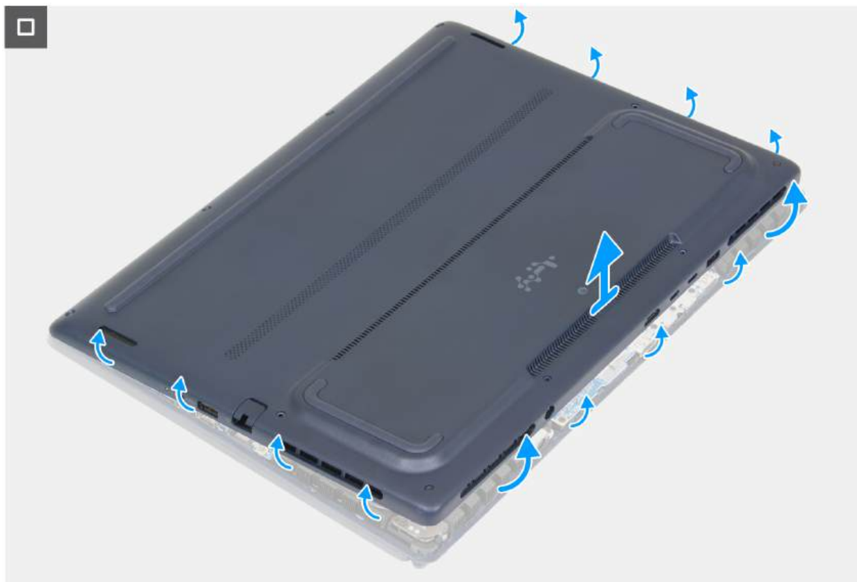
Rysunek 12. Wymontowywanie pokrywy dolnej
