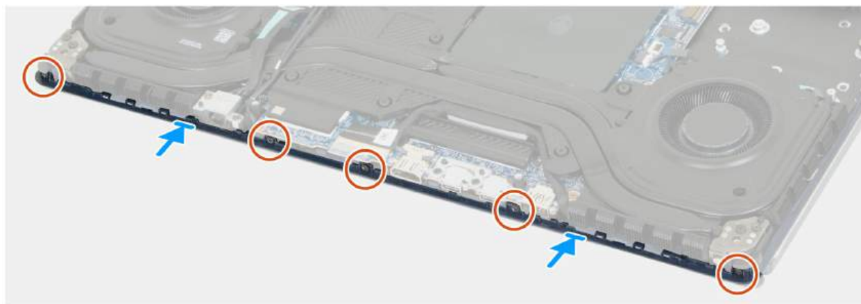
Rysunek 60. Instalowanie pokrywy tylnej
