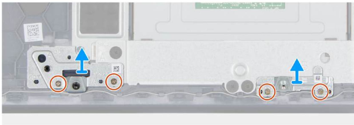
Rysunek 44. Wymontowywanie klamer baterii 6-ogniowej
