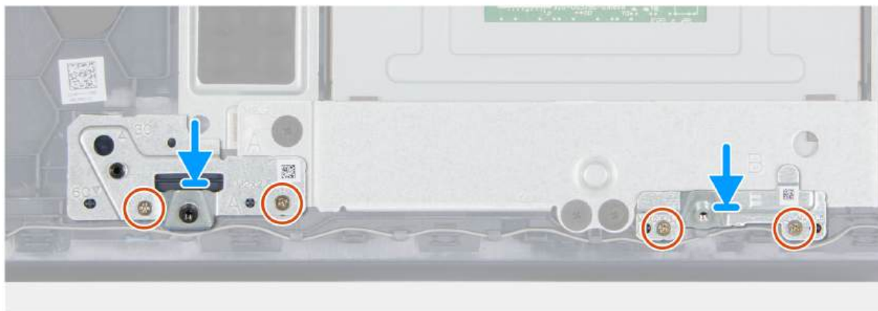
Rysunek 45. Instalacja klamer baterii 6-ogniowej
