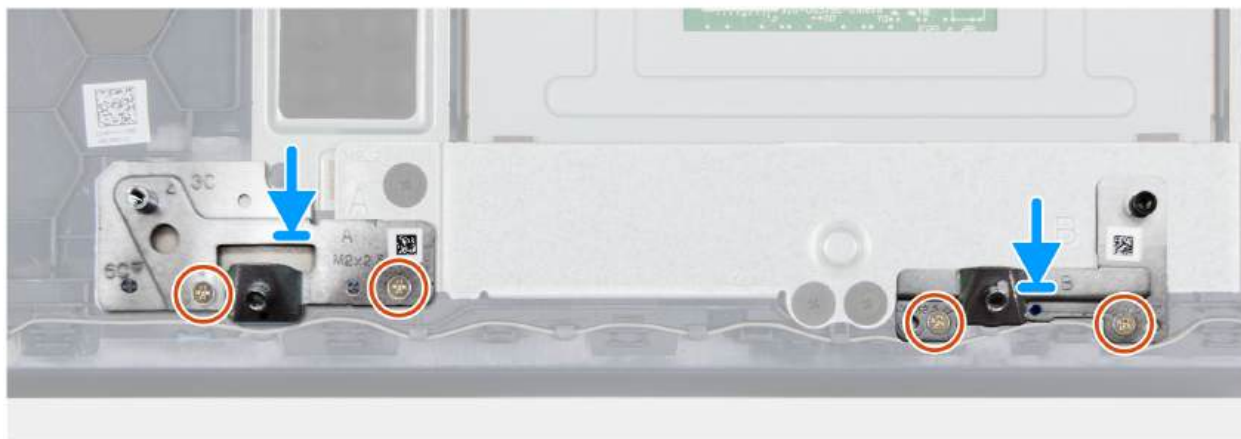
Rysunek 43. Instalacja klamer baterii 3-ogniowej
