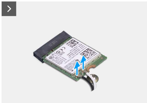
Rysunek 33. Wymontowywanie karty sieci bezprzewodowej
