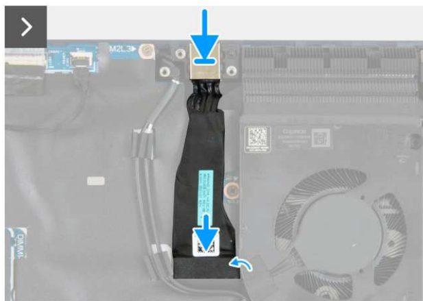
Rysunek 38. Instalowanie gniazda zasilacza
