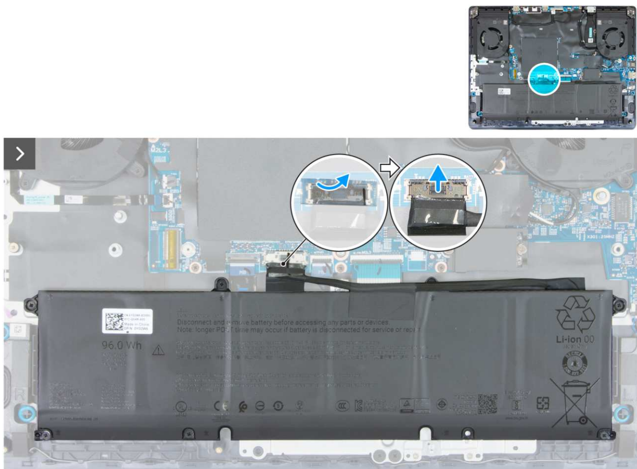
Rysunek 13. Odłączanie kabla baterii
