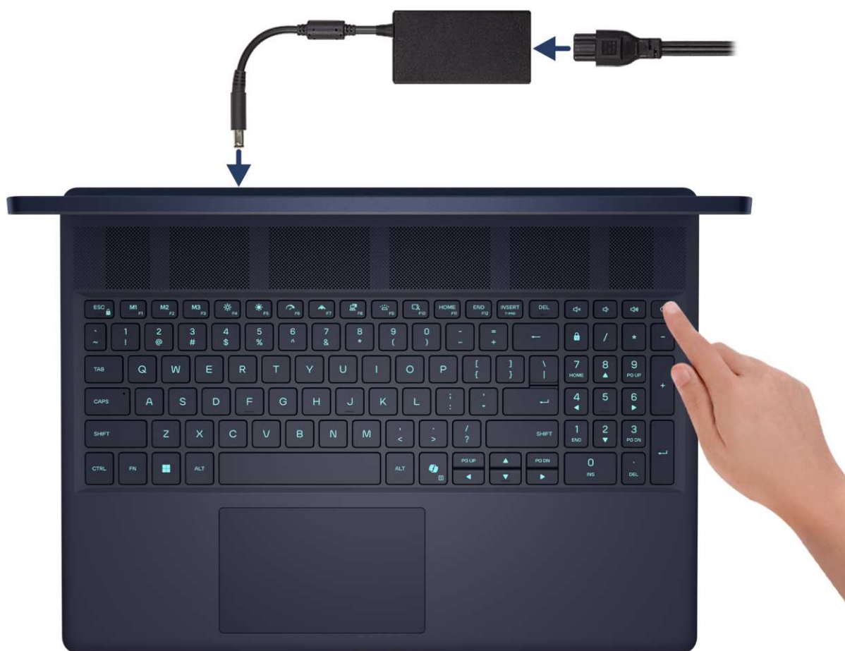
Rysunek 8. Podłącz zasilacz i naciśnij przycisk zasilania
