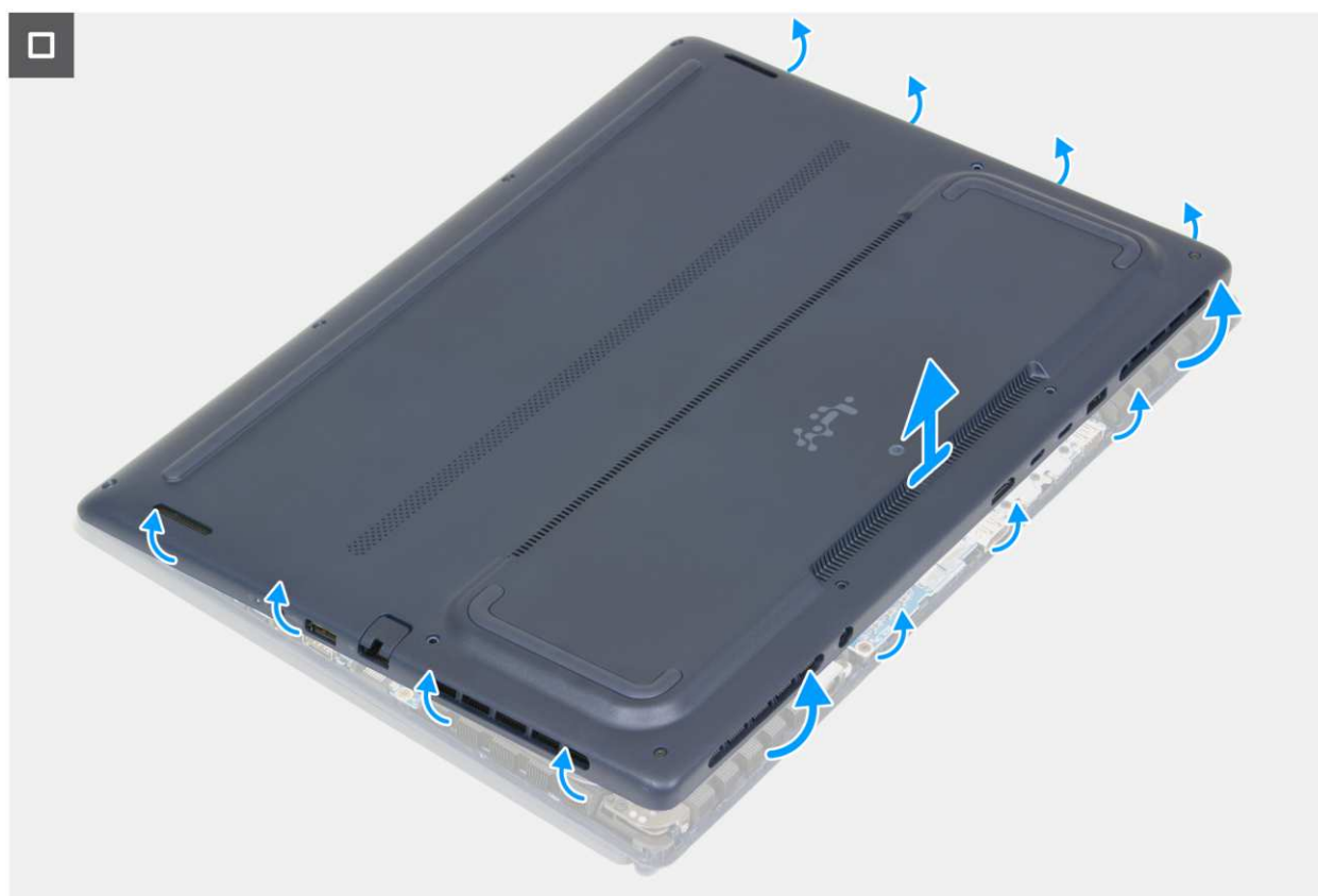
Rysunek 12. Wymontowywanie pokrywy dolnej
