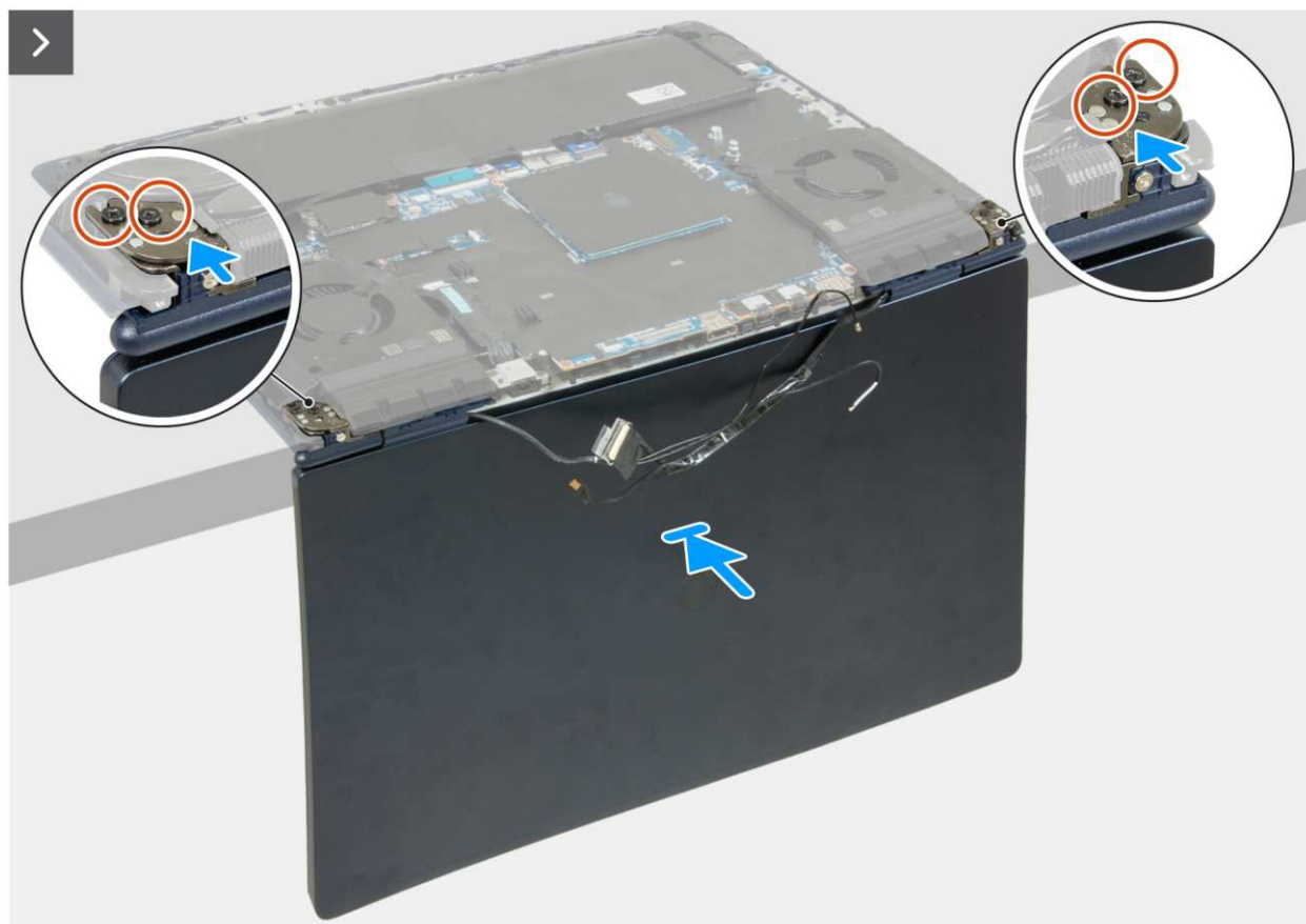
Rysunek 74. Instalowanie zestawu wyświetlacza
