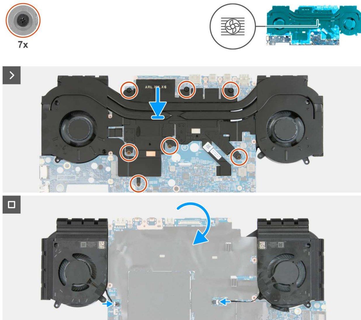
Rysunek 61. Instalowanie zestawu wentylatora i radiatora
