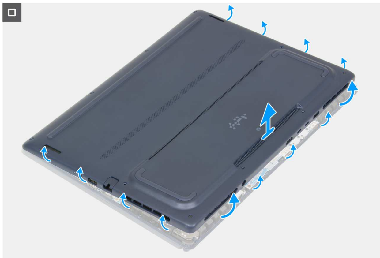
Rysunek 11. Wymontowywanie pokrywy dolnej
