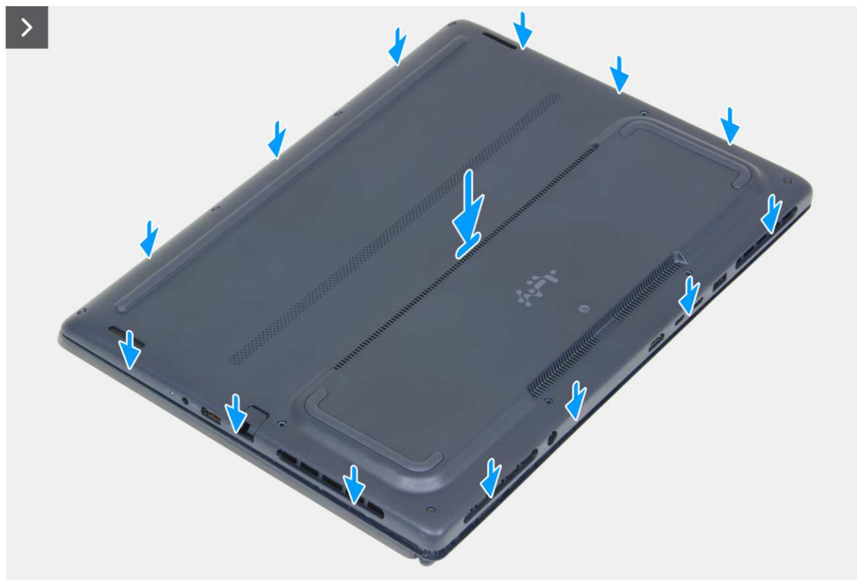
Rysunek 15. Instalowanie pokrywy dolnej
