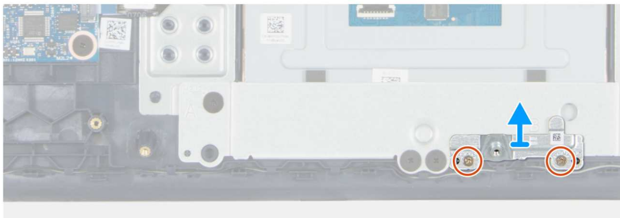
Rysunek 41. Wymontowywanie klamry baterii
