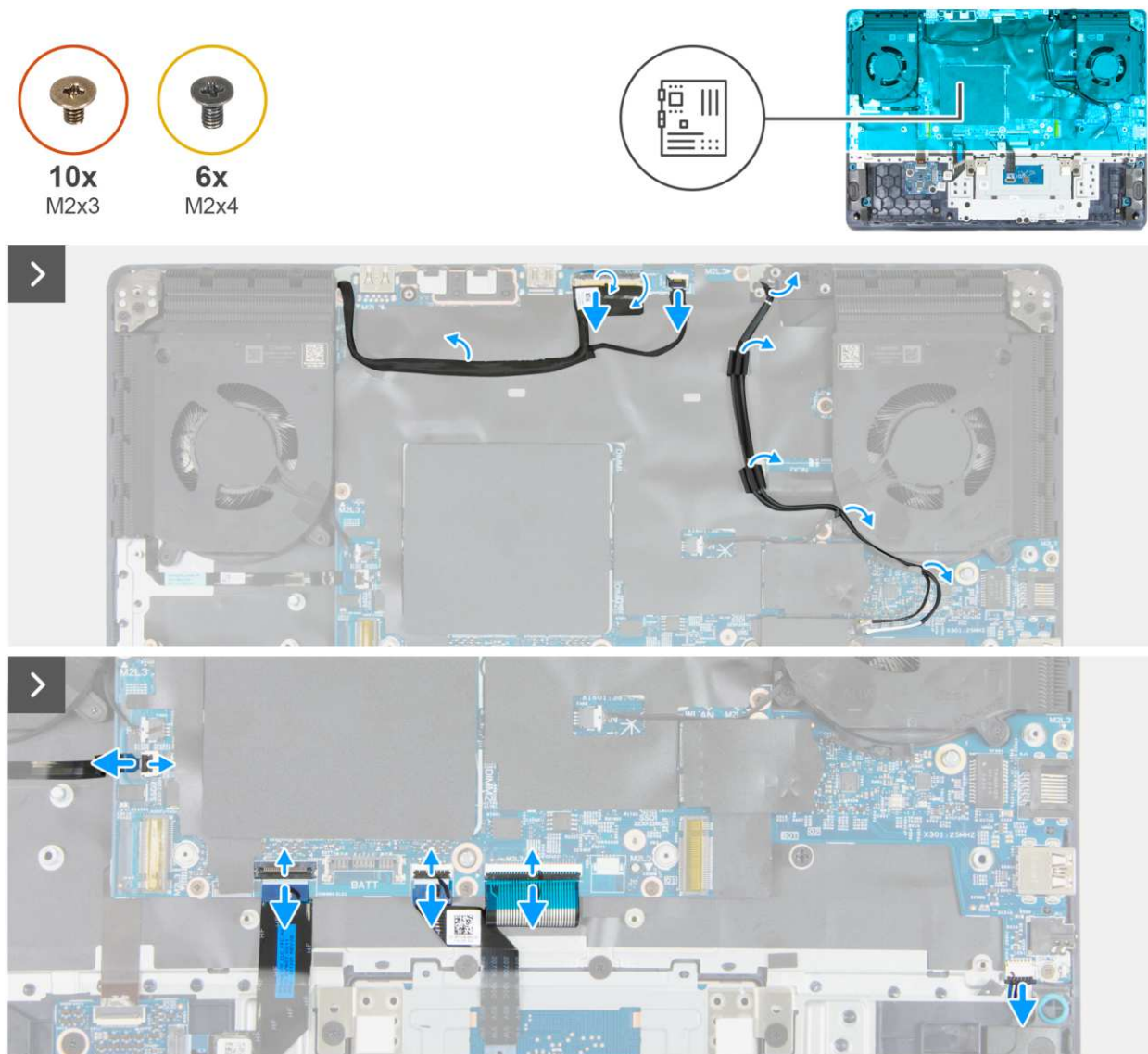
Rysunek 48. Wymontowywanie płyty głównej
