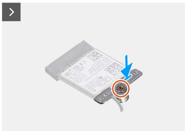
Rysunek 34. Instalowanie karty sieci bezprzewodowej
