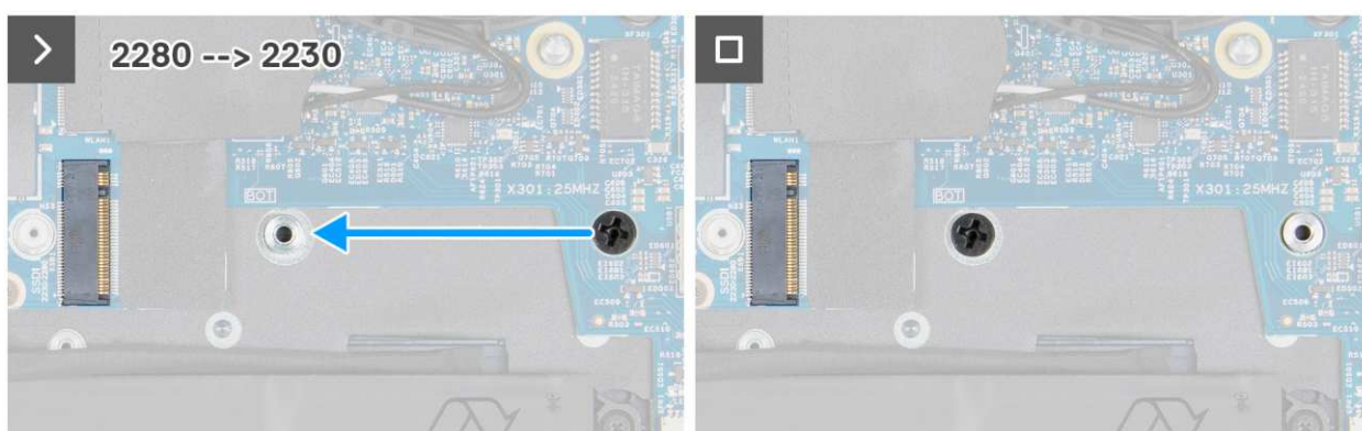
Rysunek 32. Procedura przenoszenia uchwyty śruby w celu zainstalowania dysku M2.2230
