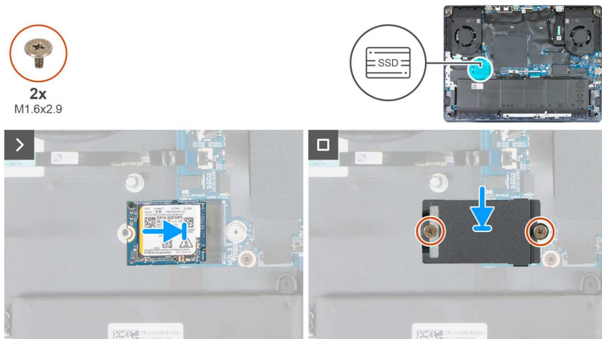
Rysunek 26. Instalacja dysku SSD M.2 2230 w gnieździe SSD2
