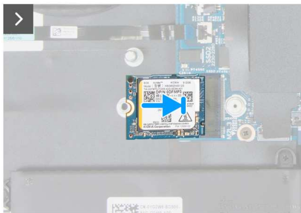
Rysunek 25. Wymontowywanie dysku SSD M.2 2230 z gniazda SSD2
