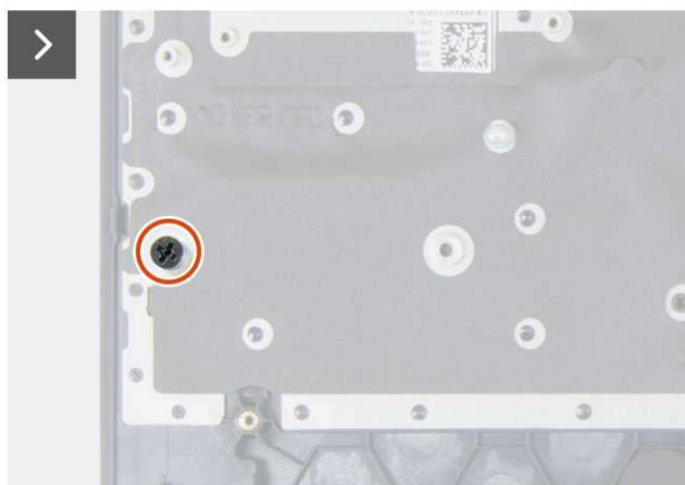
Rysunek 77. Wymontowywanie uchwytych na śruby dysku SSD
