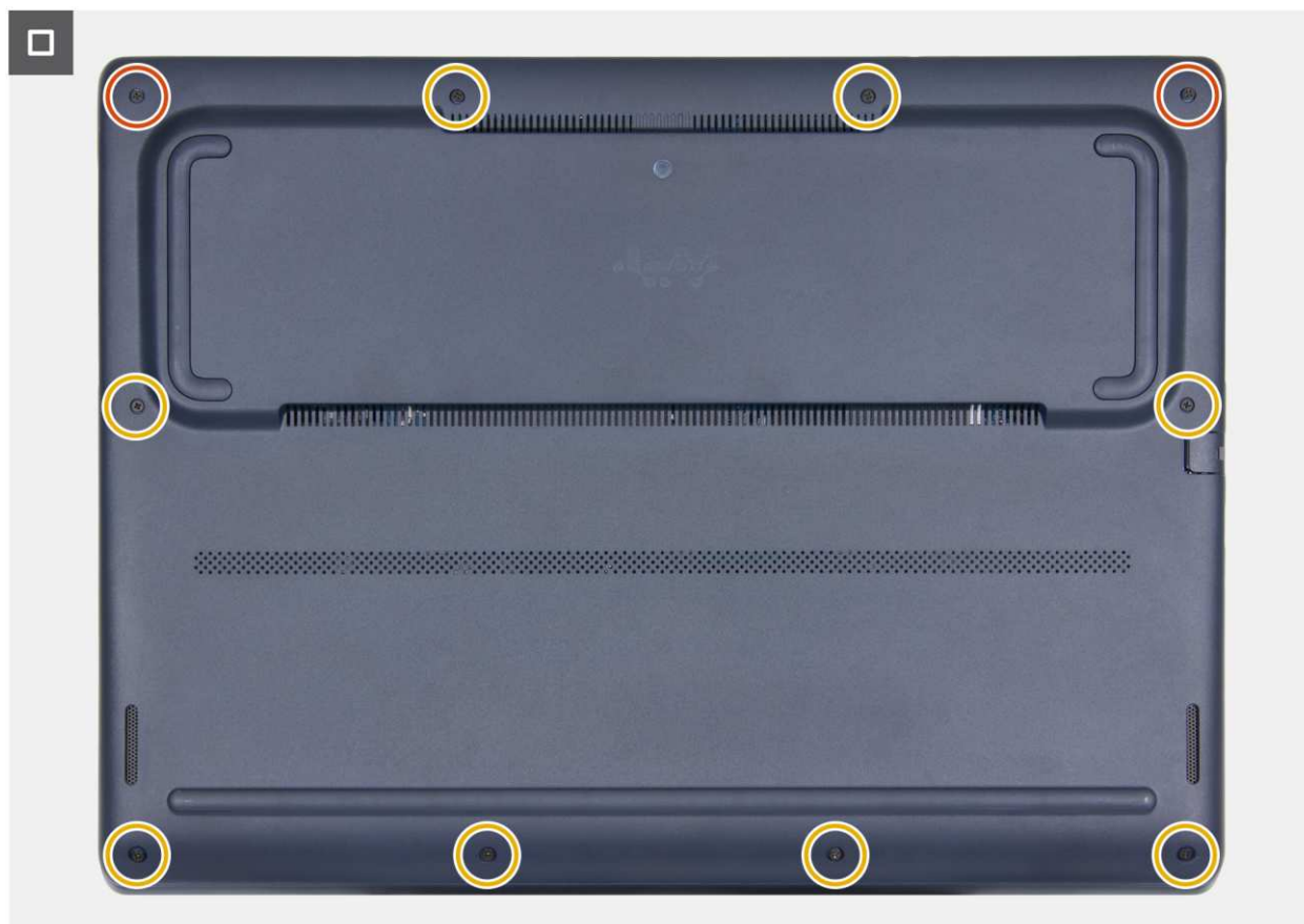
Rysunek 16. Instalowanie pokrywy dolnej
