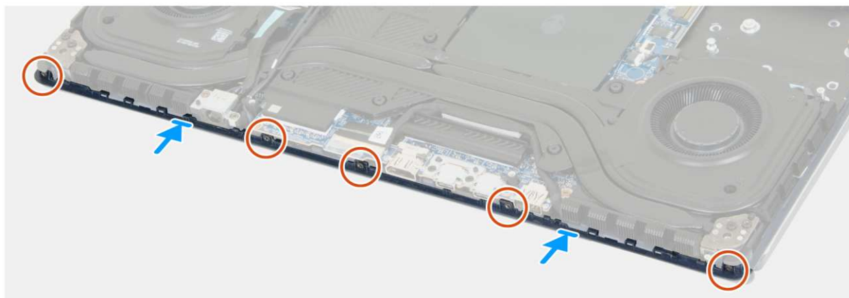
Rysunek 66. Instalowanie pokrywy tylnej
