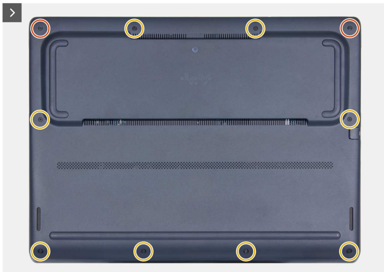
Rysunek 10. Wymontowywanie pokrywy dolnej
