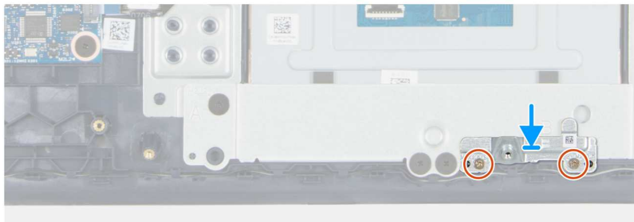
Rysunek 42. Instalacja klamry baterii
