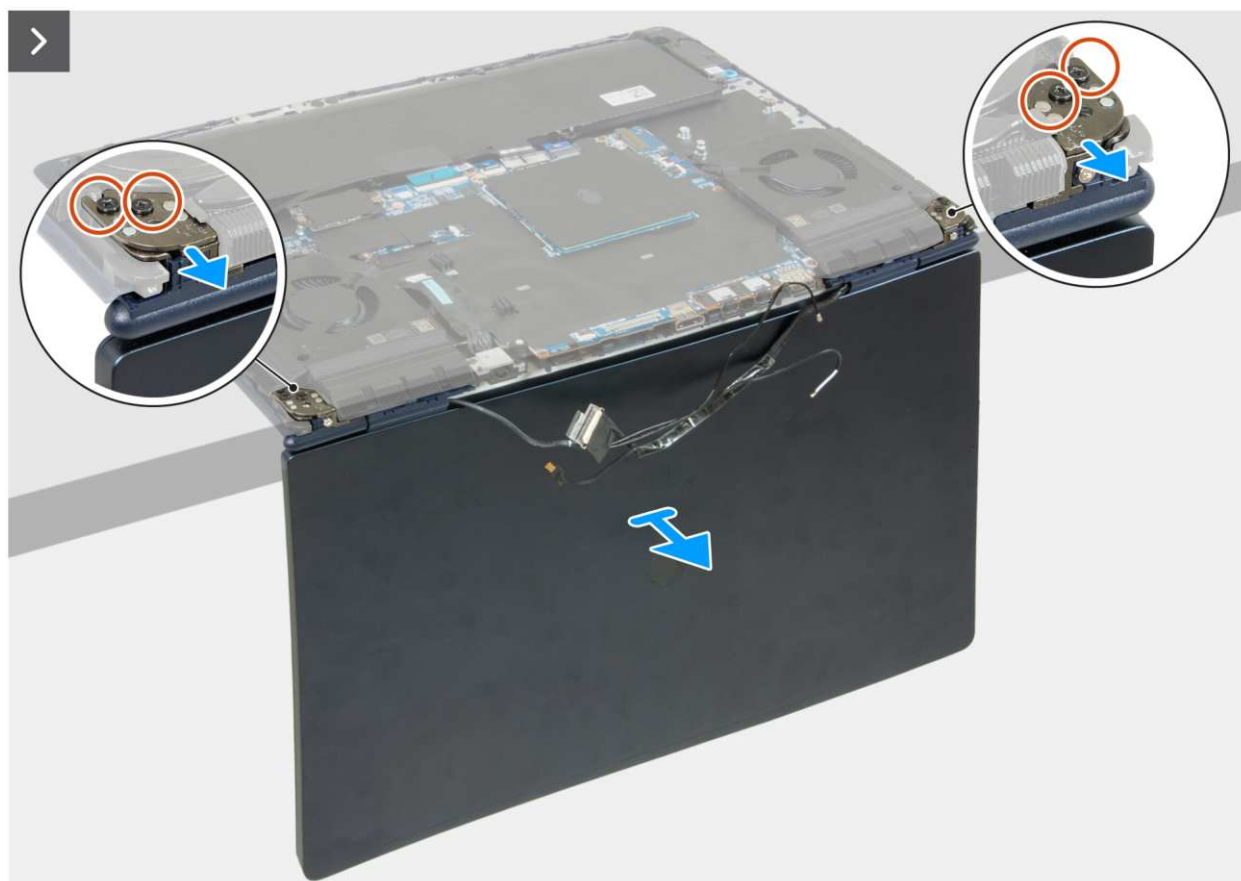
Rysunek 72. Wymontowywanie zestawu wyświetlacza
