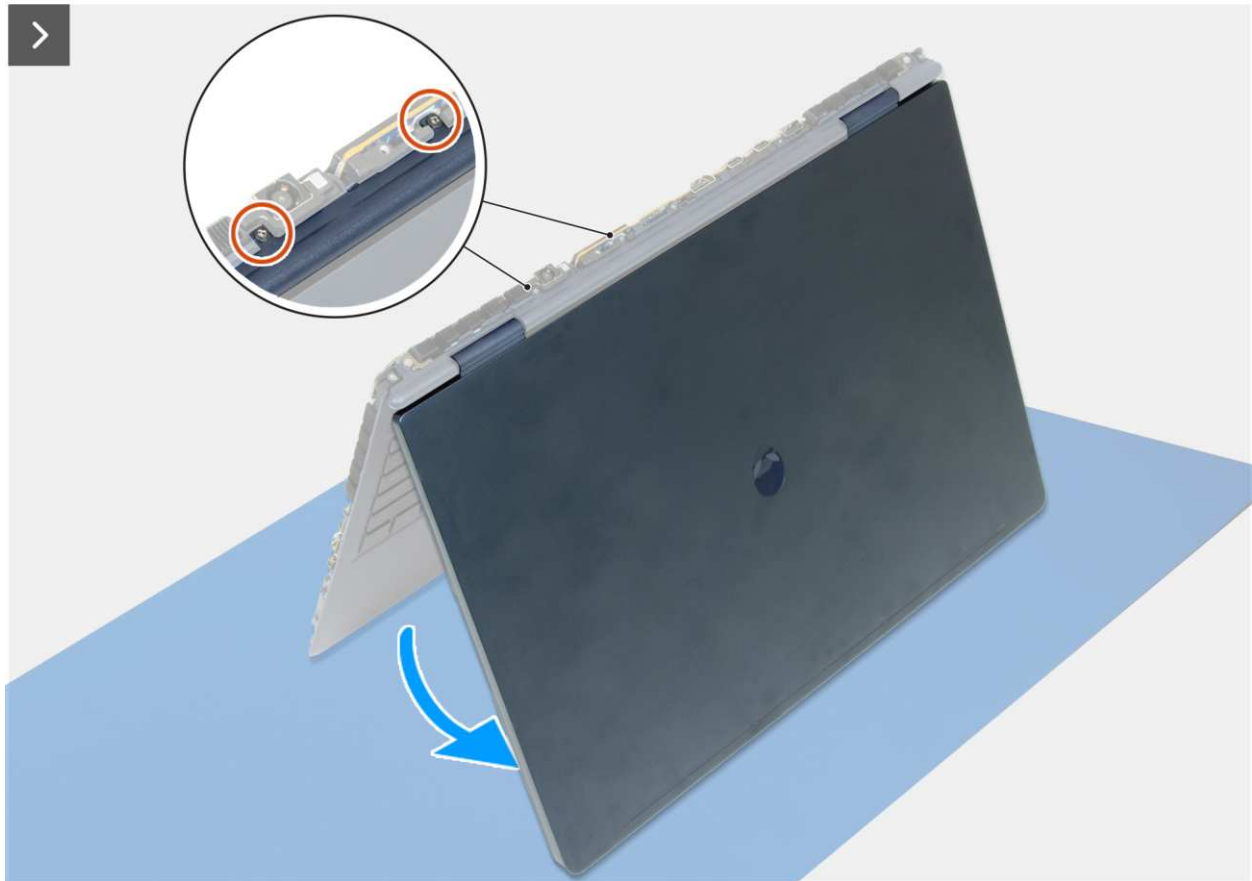
Rysunek 67. Wymontowywanie listwy środkowej
