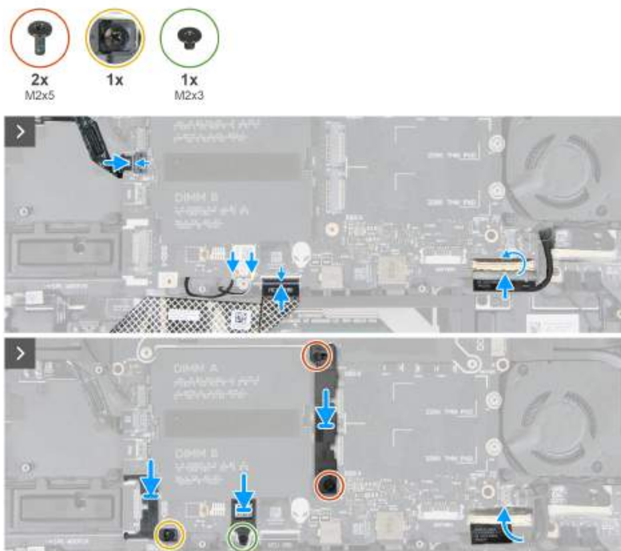
Rysunek 67. Podłączanie do płyty głównej
