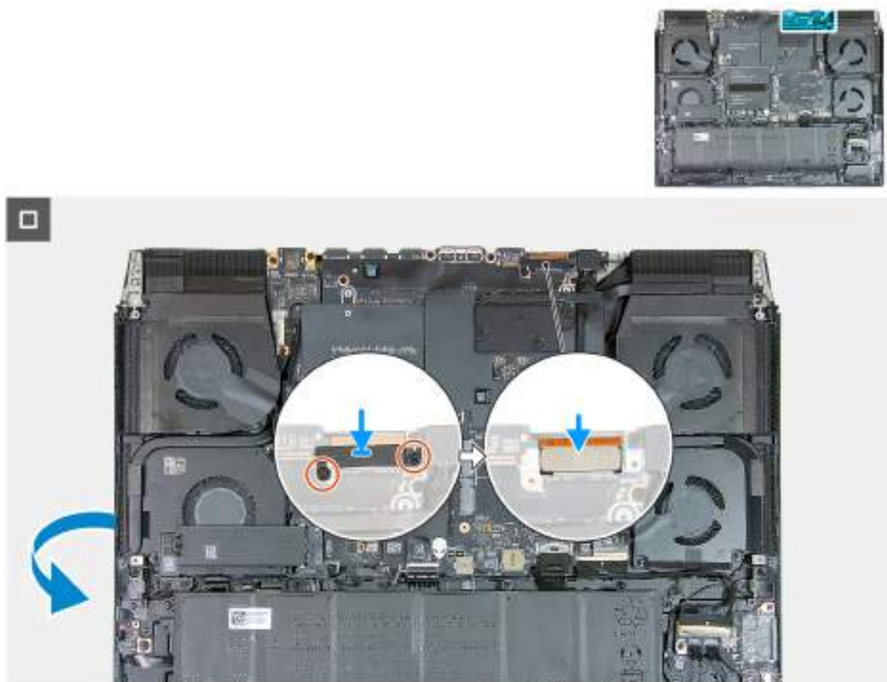
Rysunek 57. Instalowanie zestawu wyświetlacza
