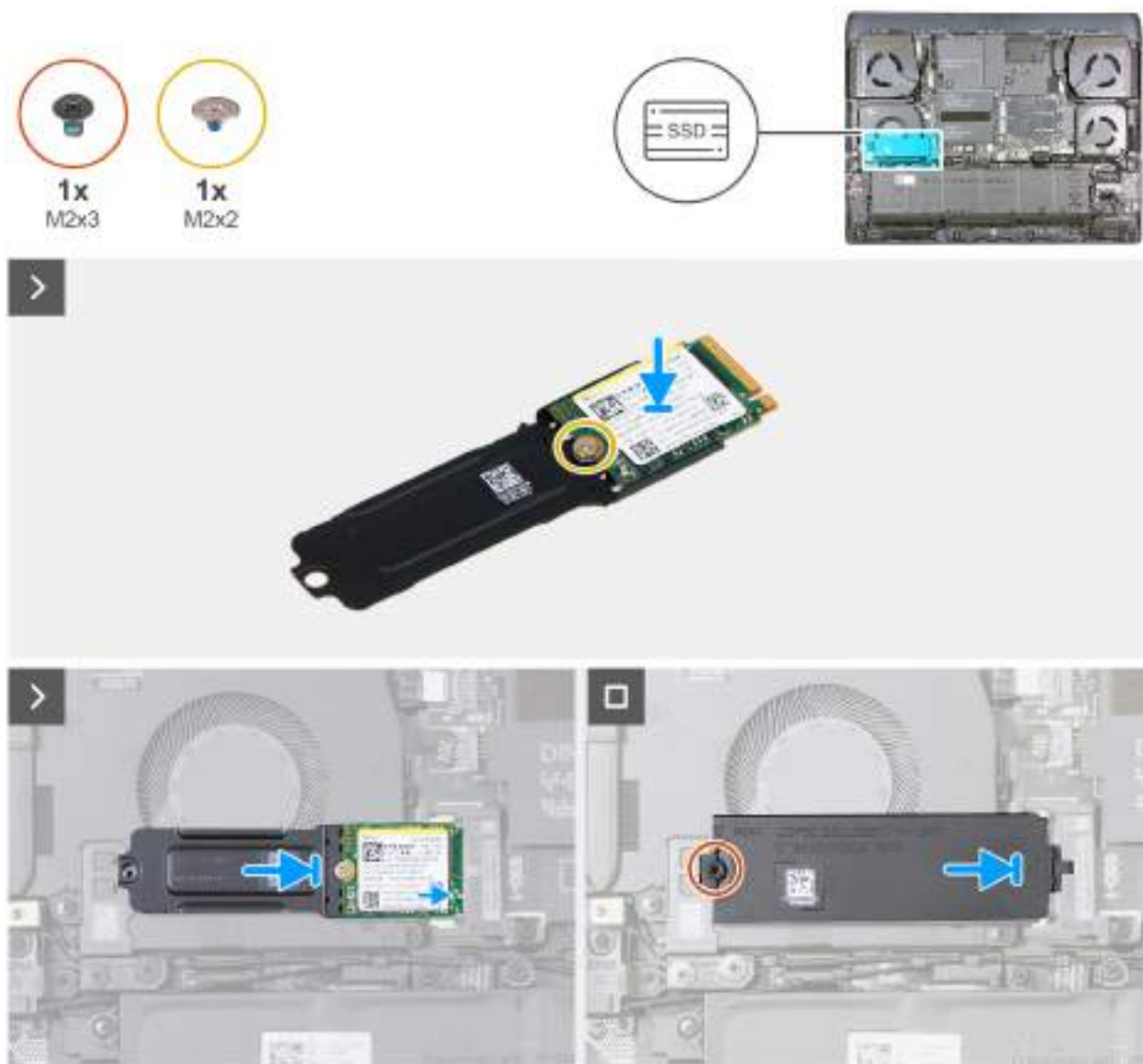
Rysunek 24. Instalowanie dysku SSD M.2 2230 w gnieździe 1
