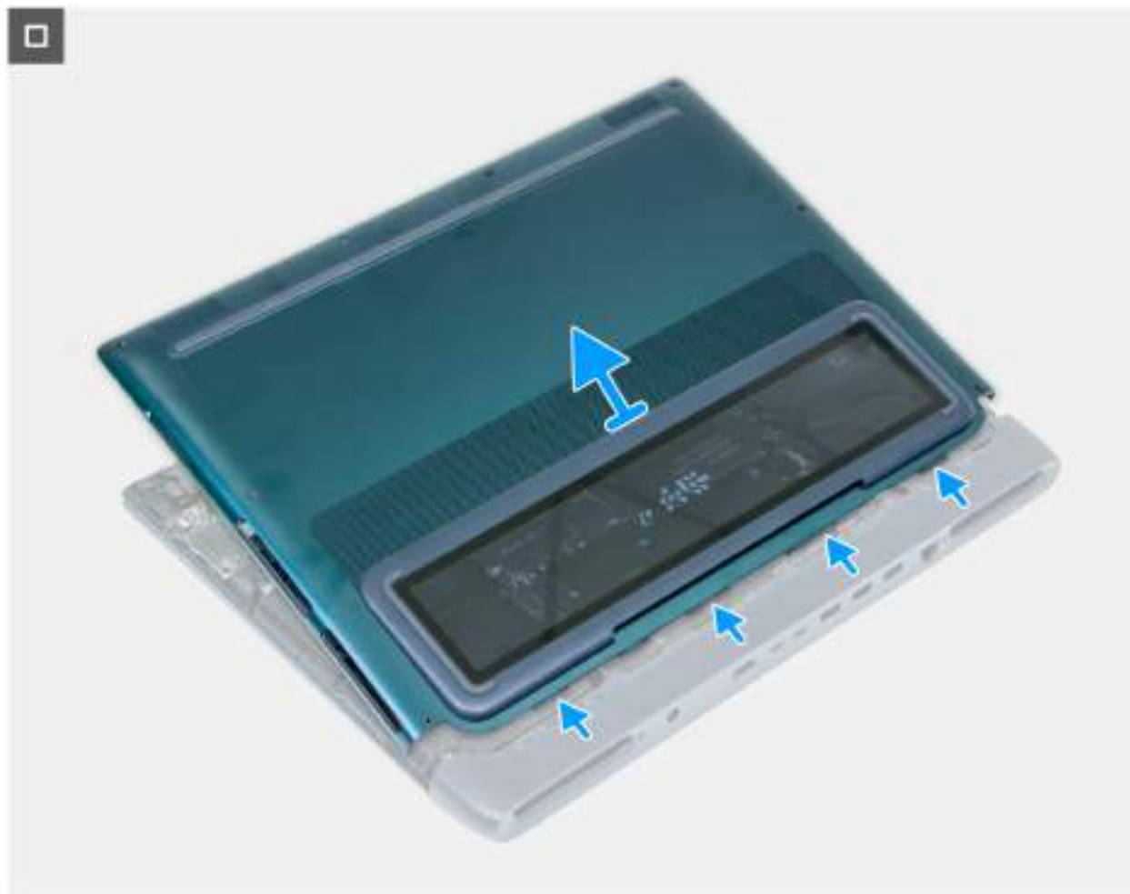
Rysunek 11. Podnoszenie pokrywy podstawy
