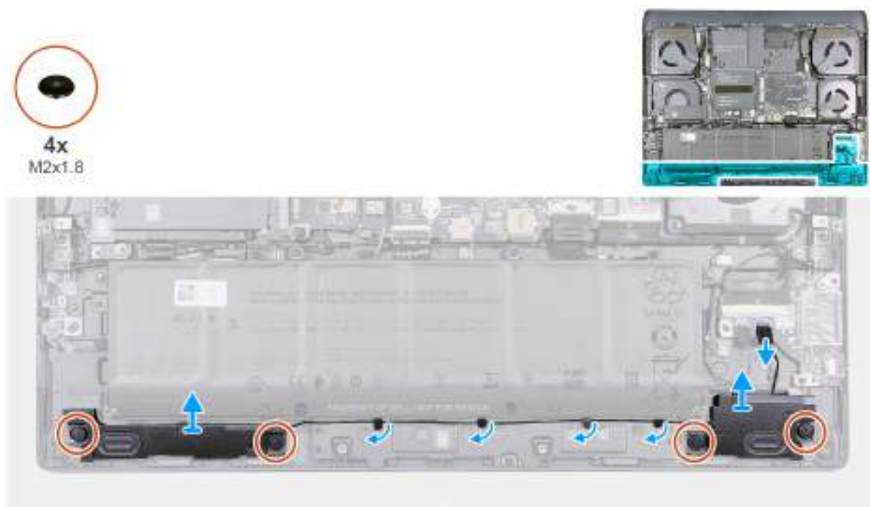
Rysunek 35. Wymontowywanie głośników niskotonowych
