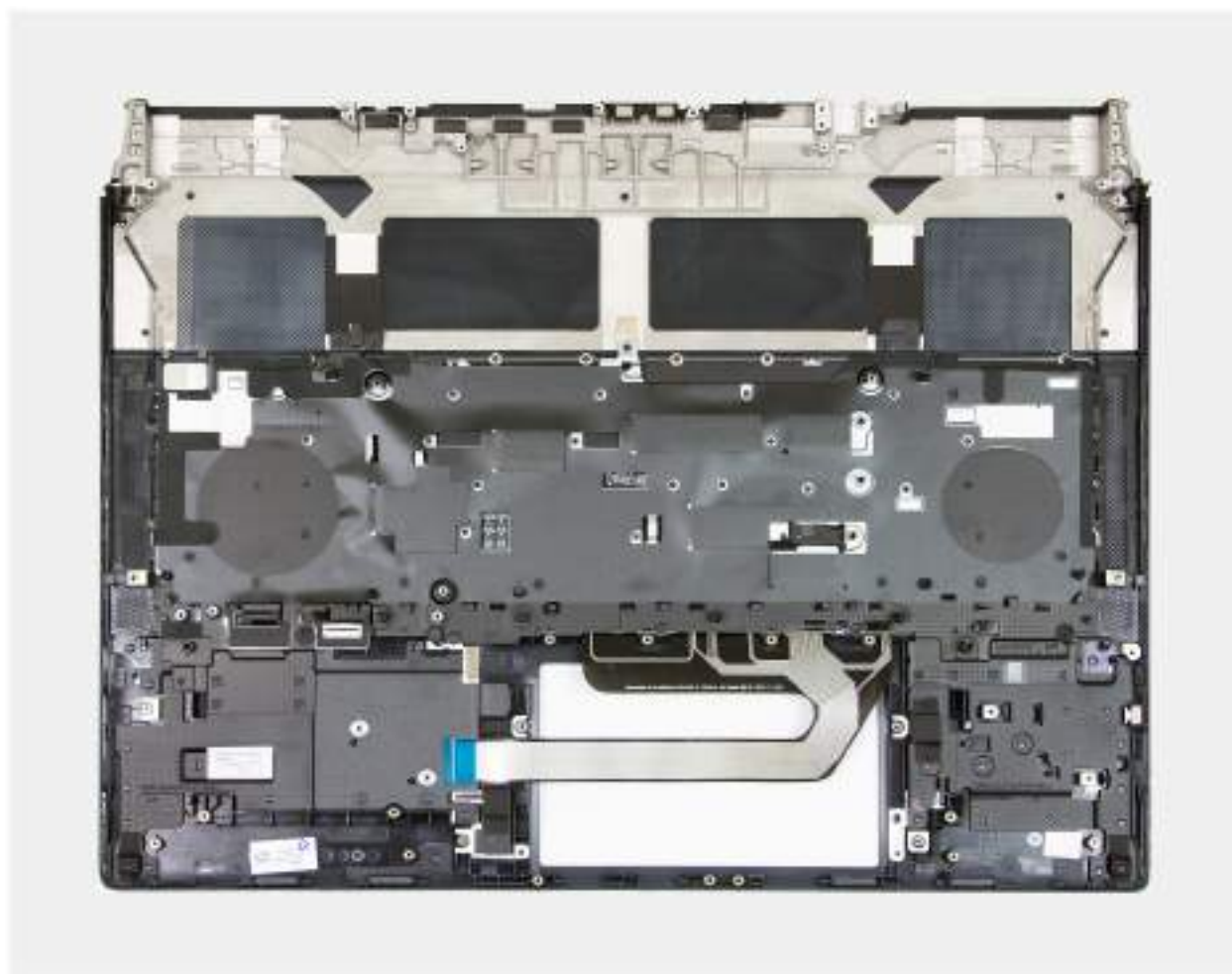
Rysunek 79. Instalowanie zestawu podpórki na nadgarstek i klawiatury
