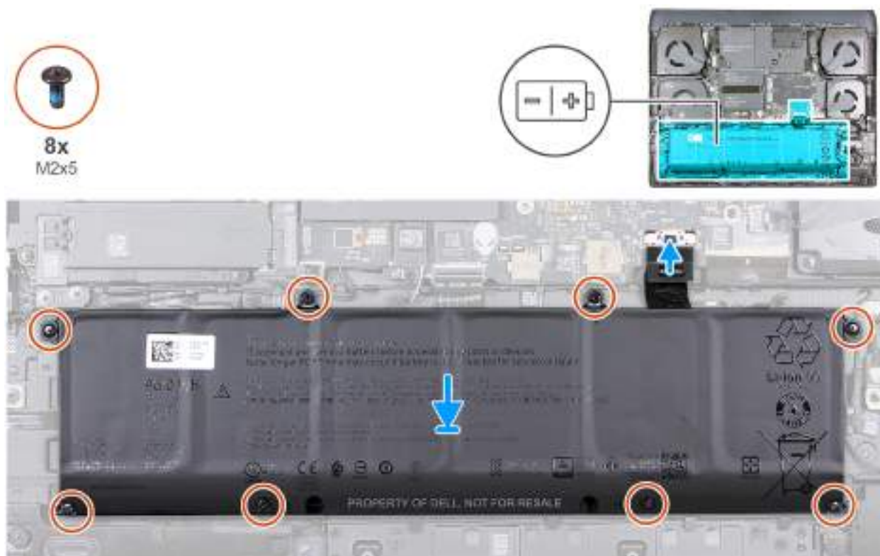
Rysunek 18. Instalowanie baterii
