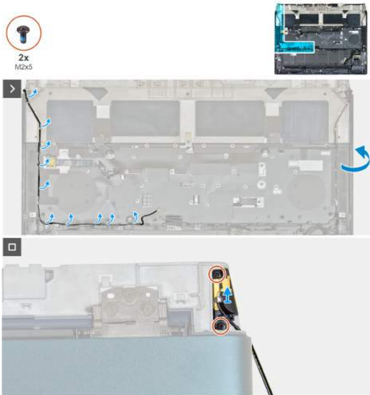
Rysunek 77. Wymontowywanie anteny pomocniczej WLAN
