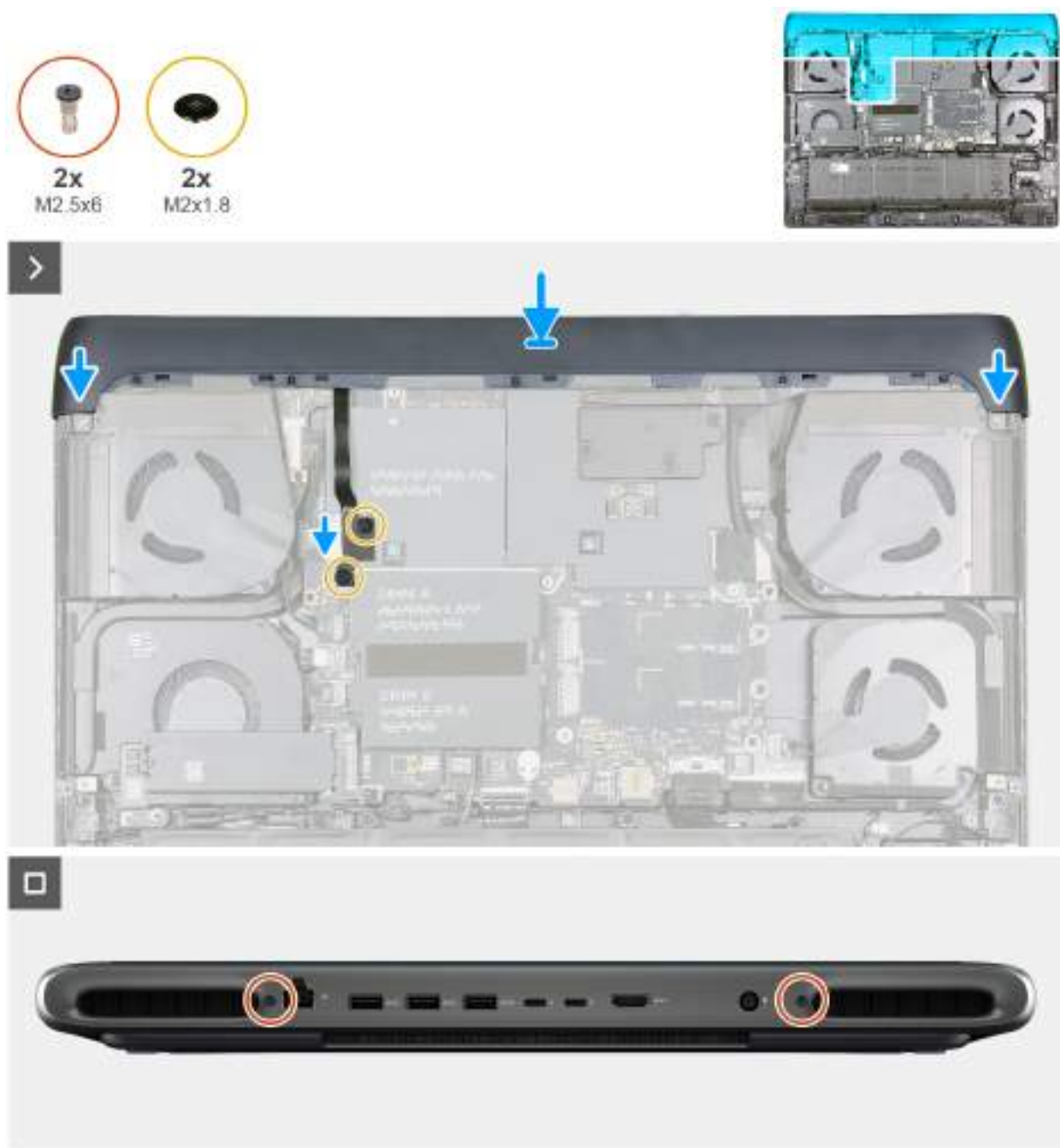
Rysunek 32. Instalowanie pokrywy tylnych złączy we/wy
