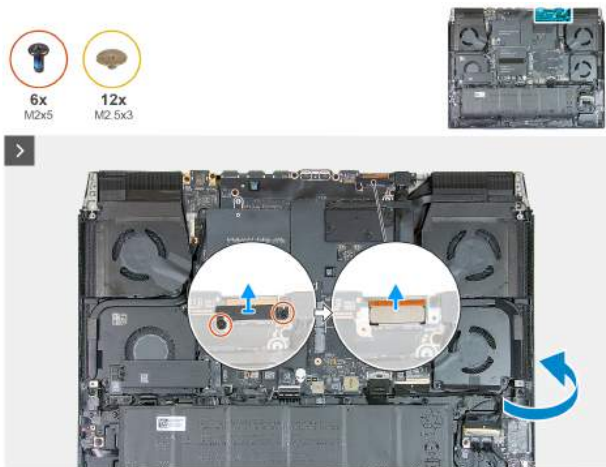
Rysunek 51. Wymontowywanie zestawu wyświetlacza
