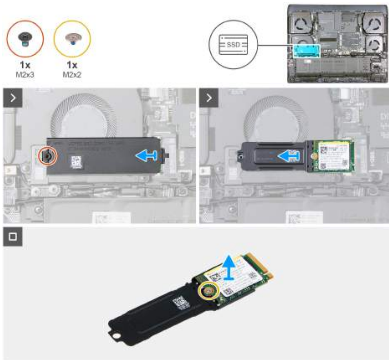
Rysunek 23. Wymontowywanie dysku SSD M.2 2230 z gniazda 1
