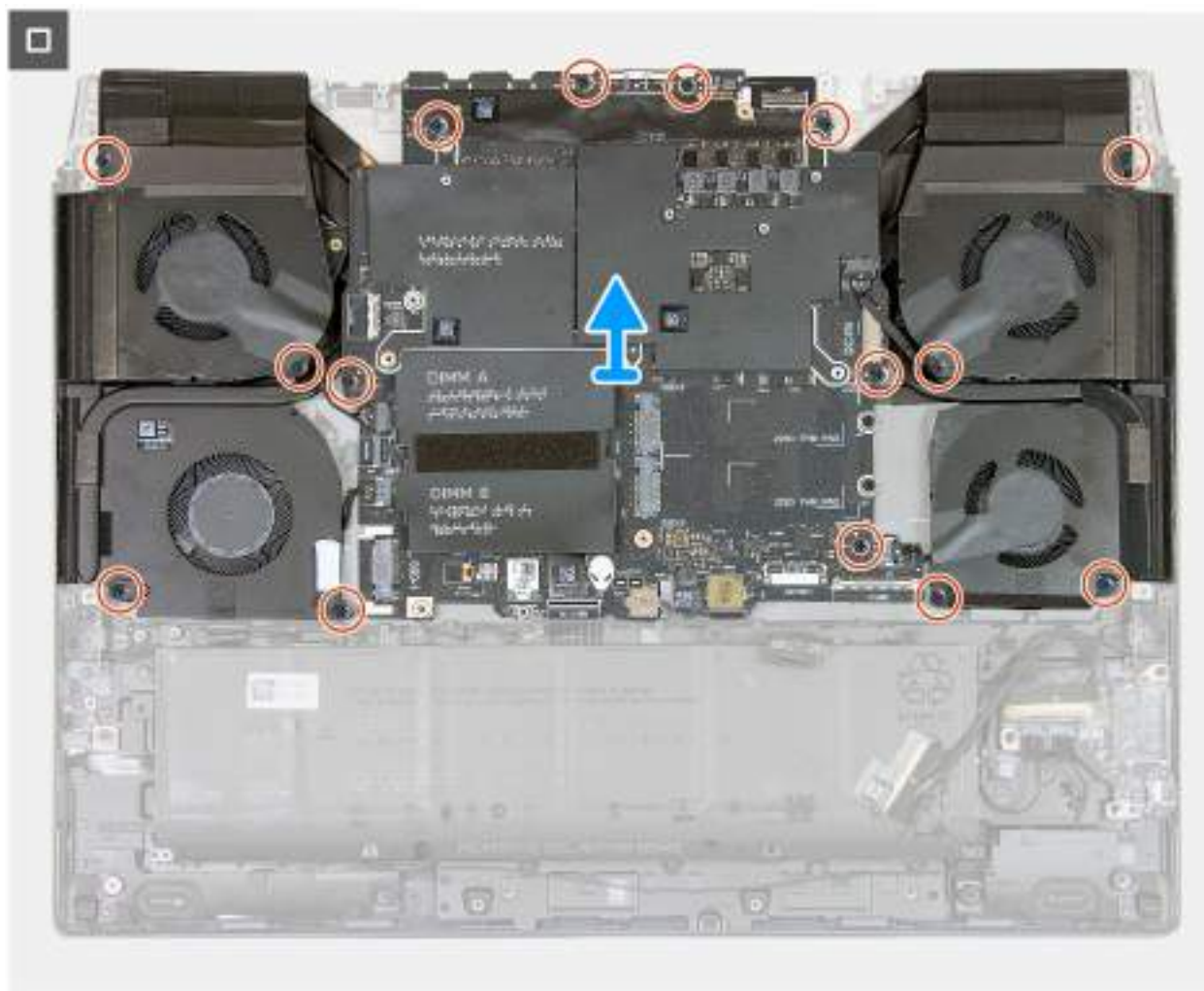
Rysunek 65. Wymontowywanie płyty głównej
