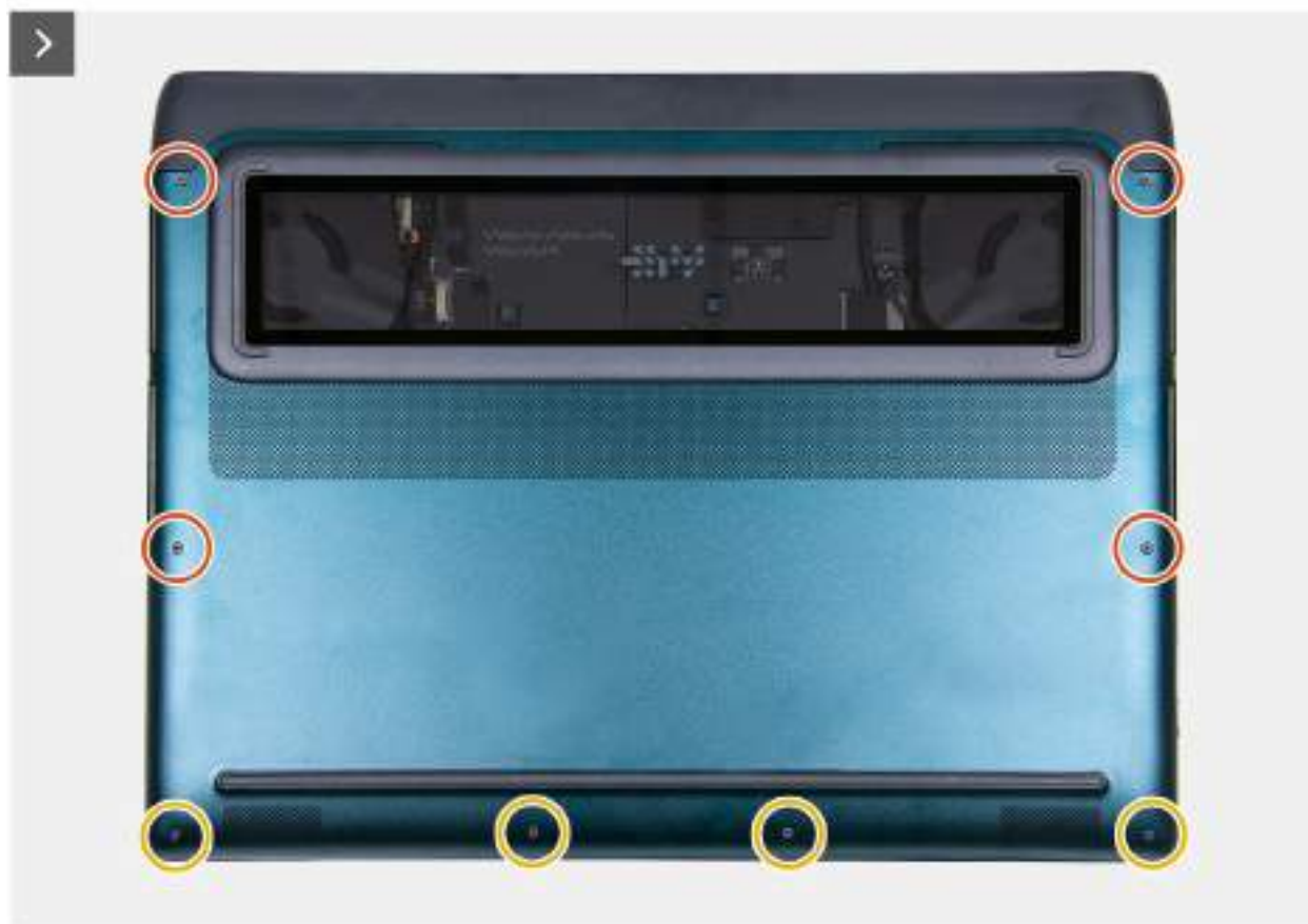
Rysunek 9. Wykręcanie śruby z pokrywy podstawy
