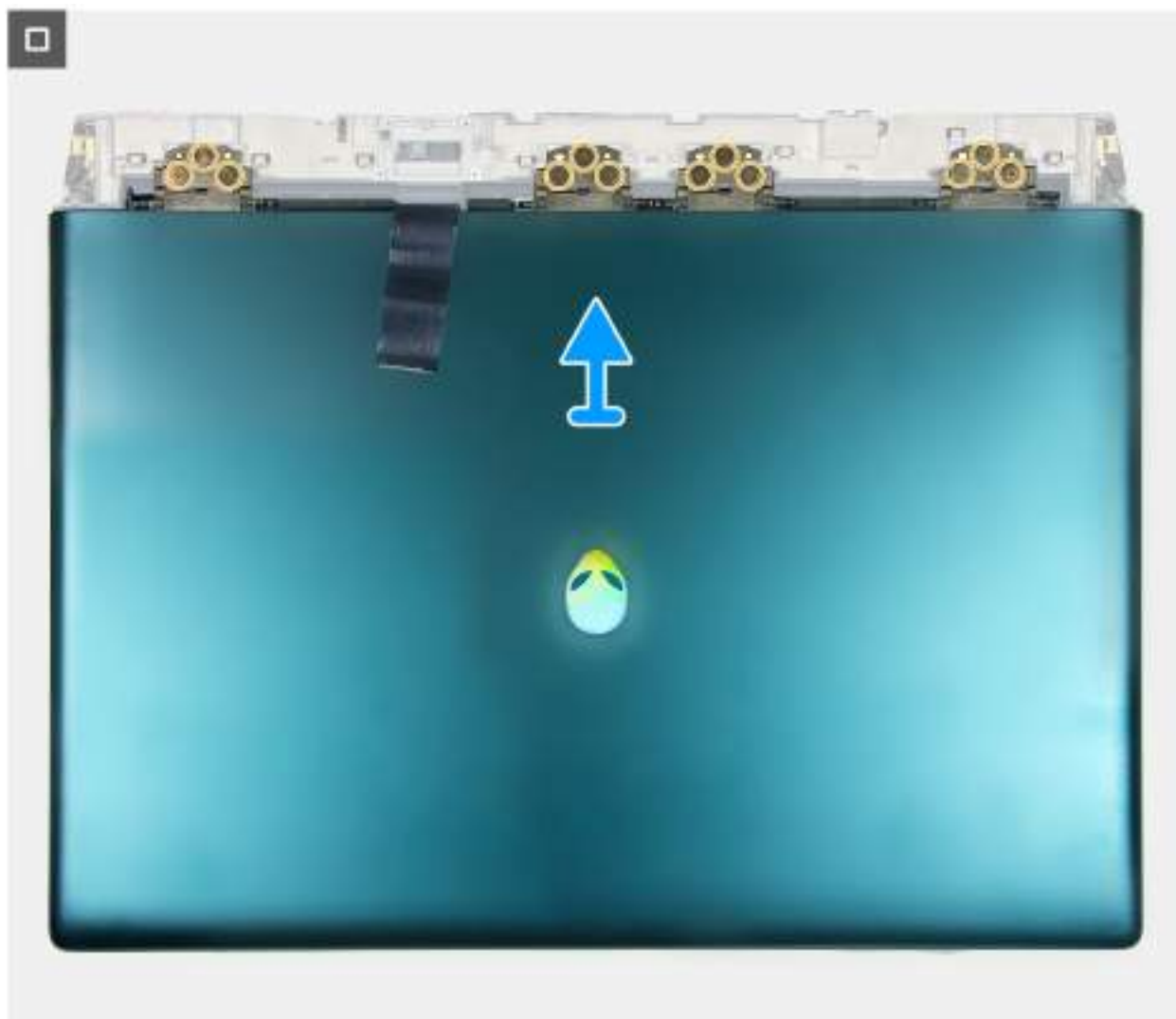
Rysunek 53. Wymontowywanie zestawu wyświetlacza
