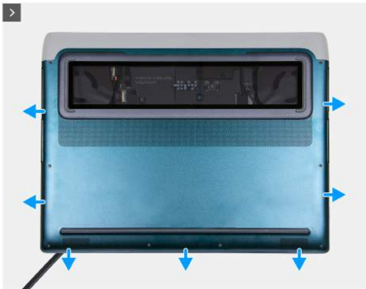
Rysunek 10. Podważanie pokrywy podstawy
