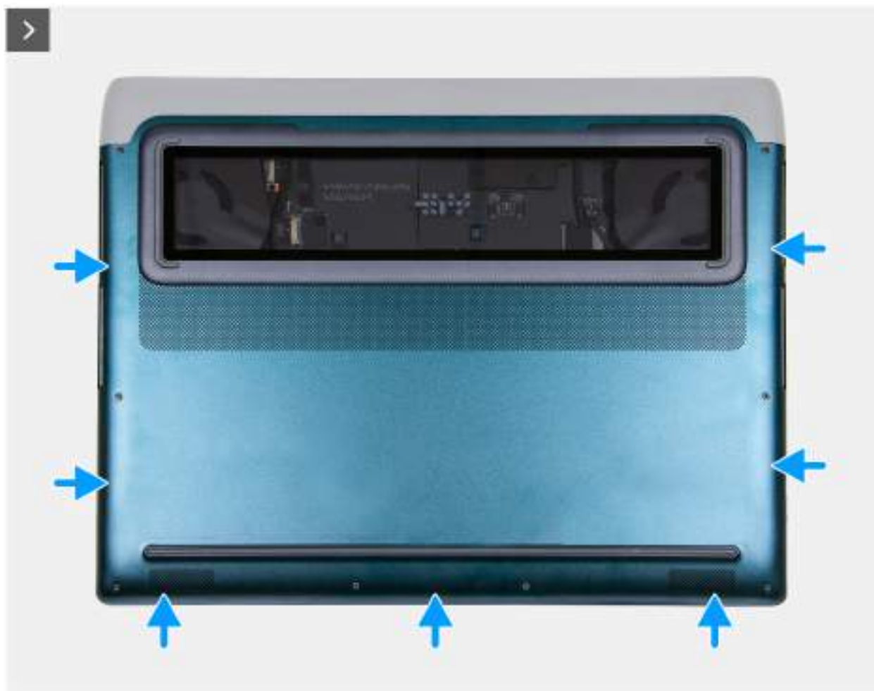
Rysunek 15. Zatrzaskiwanie pokrywy podstawy
