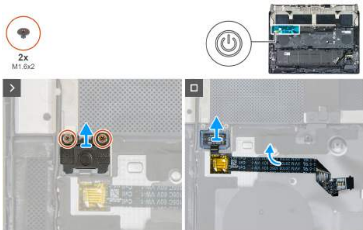
Rysunek 73. Instalowanie przycisku zasilania
