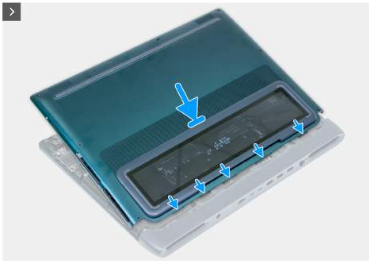
Rysunek 14. Przesuwanie pokrywy podstawy
