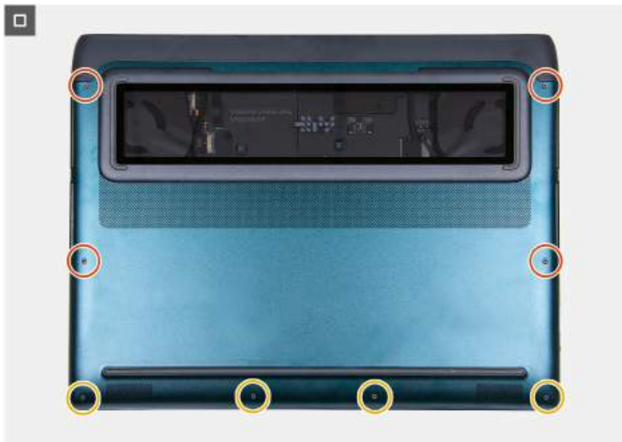
Rysunek 16. Wkręcanie śrub pokrywy podstawy
