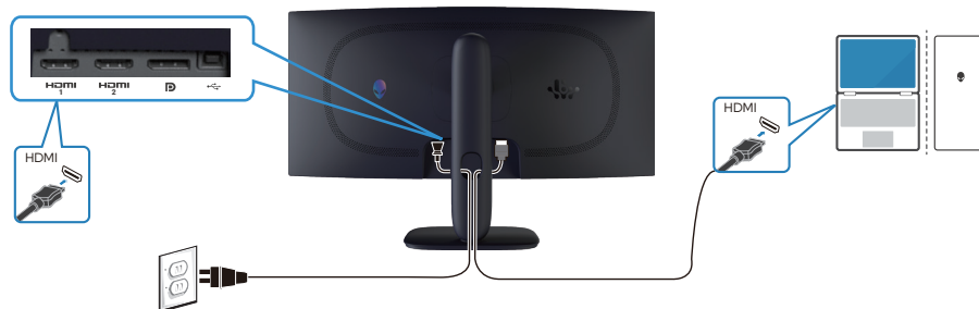
Rysunek 23. Podłączenie kabla HDMI
