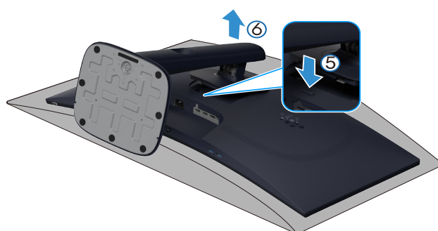
Rysunek 26. Demontaż podstawy monitora
