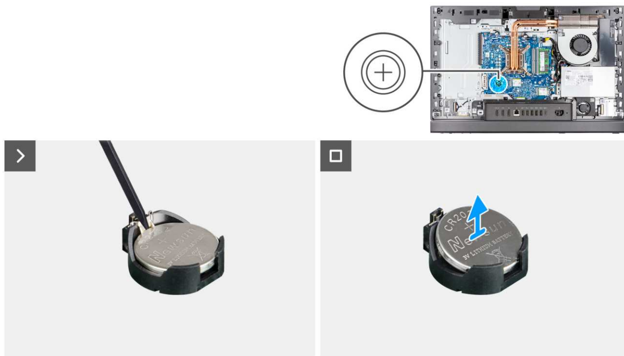
Rysunek 31. Wymontowywanie baterii pastylkowej
