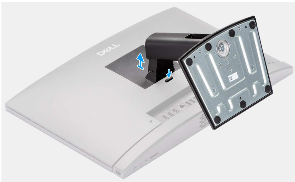
Rysunek 14. Wymontowywanie podstawy stałej
