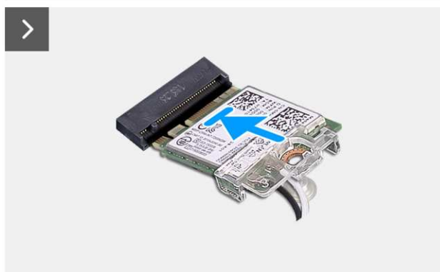
Rysunek 24. Instalowanie karty sieci bezprzewodowej
