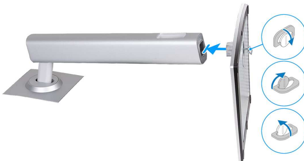
Rysunek 8. Instalowanie bazy podstawy
