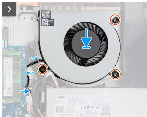
Rysunek 40. Instalowanie wentylatora
