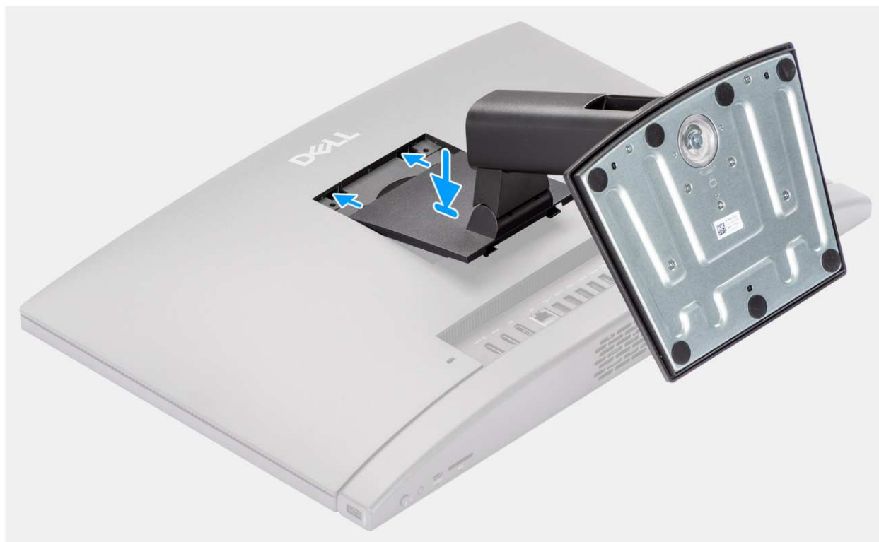
Rysunek 16. Instalowanie podstawy stałej
