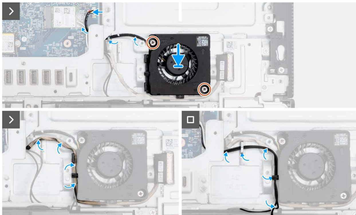
Rysunek 44. Instalowanie wentylatora zasilacza
