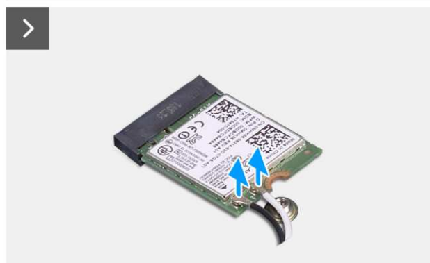
Rysunek 23. Wymontowywanie karty sieci bezprzewodowej
