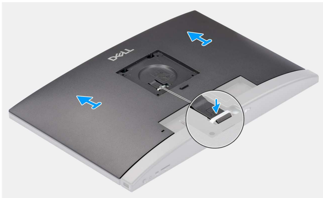
Rysunek 17. Wymontowywanie pokrywy tylnej
