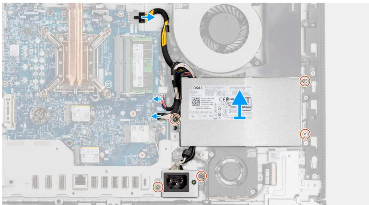
Rysunek 41. Wymontowywanie zasilacza
