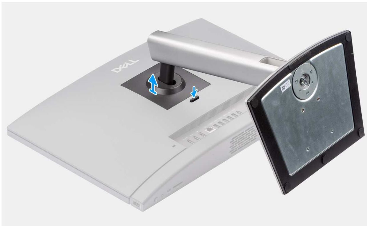
Rysunek 13. Wymontowywanie podstawy o regulowanej wysokości
