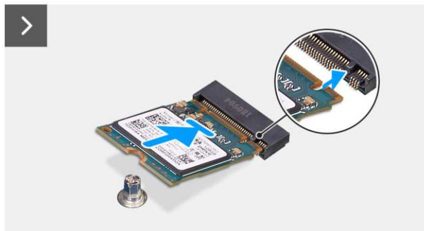
Rysunek 29. Instalowanie dysku SSD M.2 2230 w gnieździe M.2 nr 1
