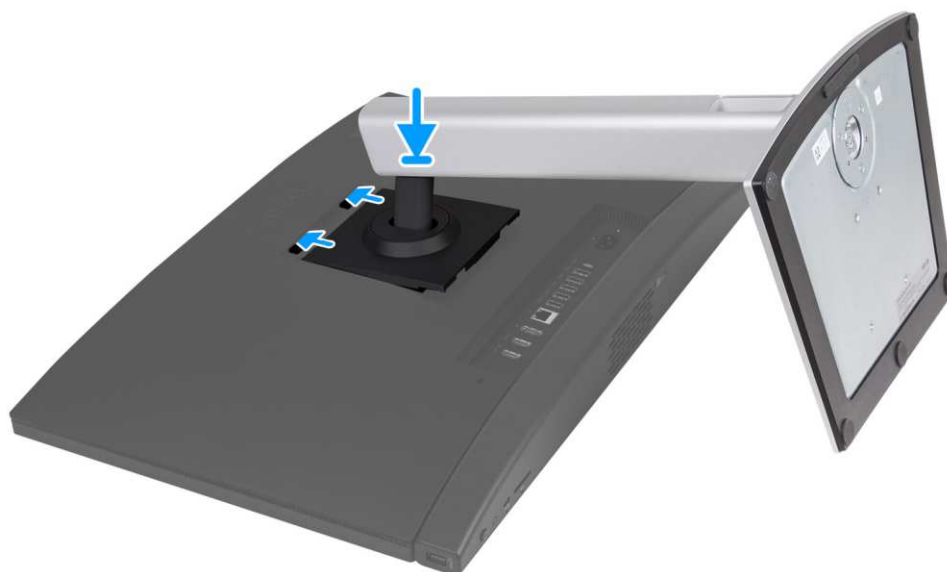
Rysunek 9. Instalowanie podstawy
