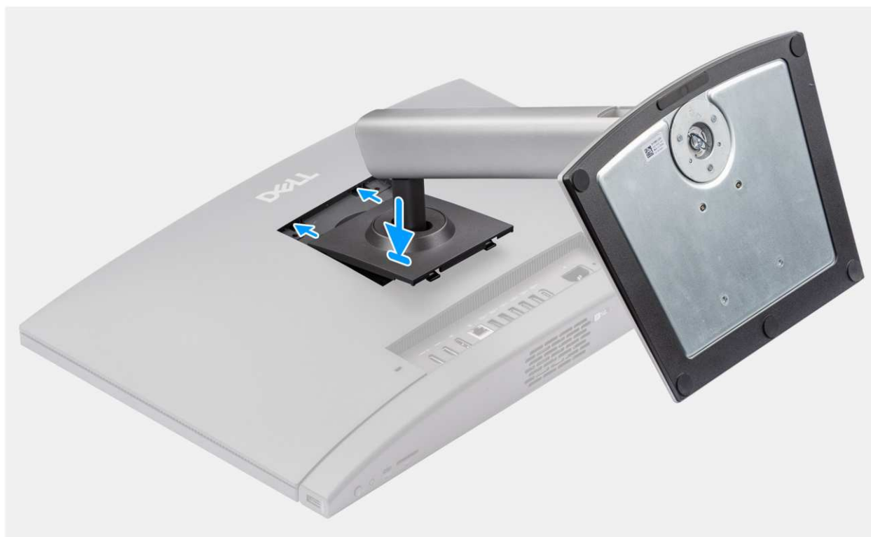
Rysunek 15. Instalowanie podstawy o regulowanej wysokości
