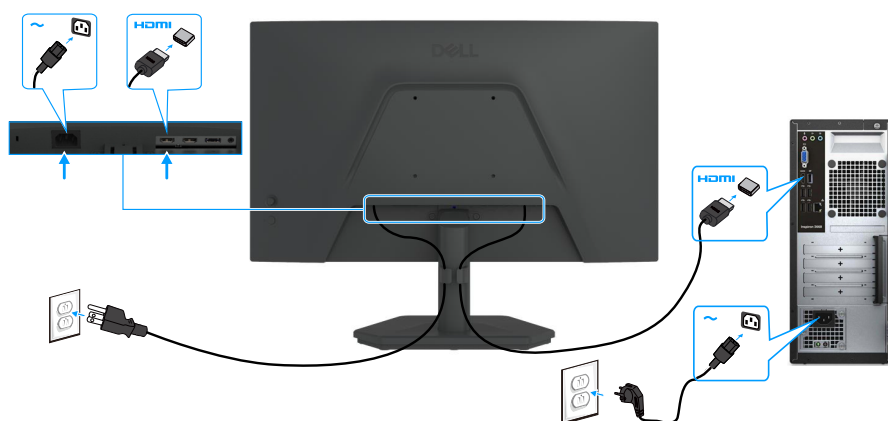
Rysunek 14. Podłączenie przewodu HDMI
