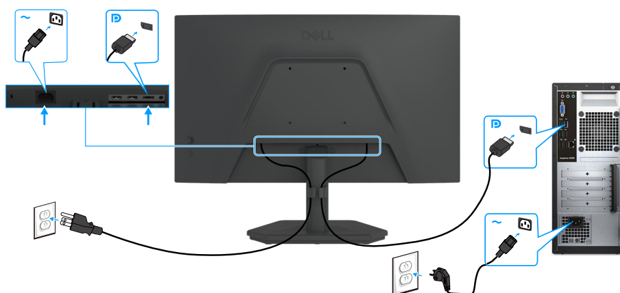
Rysunek 15. Podłączenie przewodu DisplayPort
