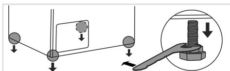
**4** Наклоните стиральную машину на одну сторону и с помощью ключа (ключ 32 мм) открутите и снимите металлические ножки. Затем повторите с другой стороны.
