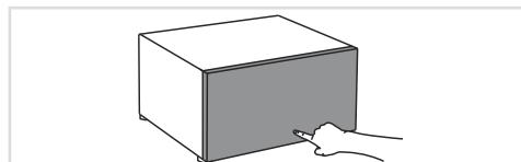
**1** 在首次使用之前，需要在底座抽屉(pedestal drawer)上安装底脚。将底脚拧紧至末端，使底座抽屉水平并保持稳定。
