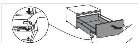
**3** Двома руками потягніть тумбу-шухляду на себе. Потім натисніть на пластикові важелі, розташовані на напрямних під шухлядою з обох боків до середини, щоб звільнити стопор, який перешкоджає повному висуванню шухляди.
