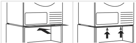
**7.1** Коли сушильну машину встановлено, встановіть на місце фіксатори передніх ніжок. Щільно притисніть фіксатор передніх ніжок до сушильної машини, після чого прикрутіть його знизу гвинтами.
