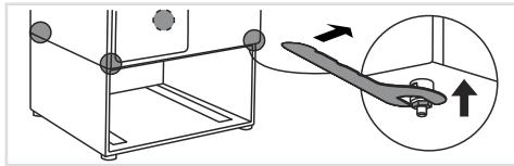
**7.1** Прикрутите гайки на четыре распорки стиральной машины и затяните их с помощью открытого гаечного ключа (ключ 17 мм).
