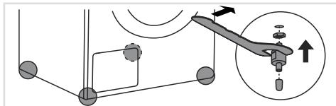
**6** Anleitung zur Installation der Distanzstücke an der Waschmaschine:
