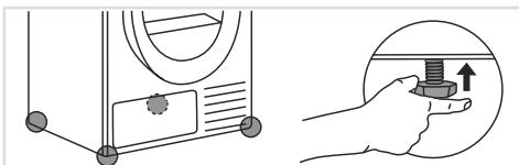
**6** Перед тим, як поставити сушильну машину на тумбу-шухляду, перевірте рукою, чи повністю затягнуті ніжки (не використовуйте гайковий ключ).
