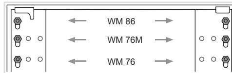
**8** Installatie van schroeven op verschillende modellen wasmachines
