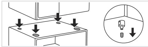
**7** Поднимите стиральную машину и установите на корпус ящика.
