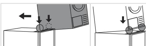
**7** Heben Sie den Trockner an, setzen Sie ihn sicher auf die Sockelschublade und schieben Sie ihn zurück, bis er in den voreingestellten Halterungen einrastet.
