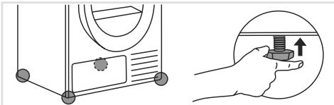
**6** Preden postavite sušilni stroj na izvlečni predal, z roko preverite, da so nogice privite do konca (ne uporabljajte ključa).
