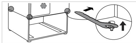
**7.1** Надягніть гайки на всі чотири проставки знизу пральної машини, міцно затягніть їх за допомогою вилкового ключа (ключ на 17 мм).
