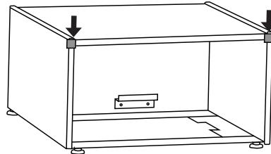
Pirms pirmā lietojuma jānonem visi transportēšanas aizsargi. Transportēšanas elementi ir paredzēti paaugstinājuma atvilktnes (pedestal drawer)aizsargāšanai transportēšanas laikā un pirms iedarbināšanas ir jānorīgēm.
