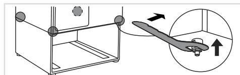
**7.1** Bevestig de moeren aan alle 4 de afstandhouders aan de onderkant van de wasmachine en draai ze stevig vast met een steeksleutel (van 17 mm).
