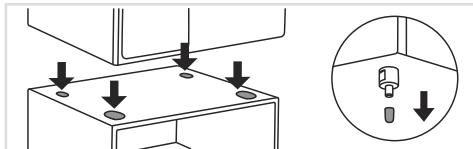
**7** Heben Sie die Waschmaschine an und stellen Sie sie auf die Sockelschublade.
