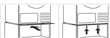
**7.1** Sobald der Wäschetrockner installiert ist, bringen Sie die vordere Fußfixierung wieder an. Drücken Sie die vordere Fußfixierung fest gegen den Wäschetrockner und befestigen Sie sie von unten mit den Schrauben.
