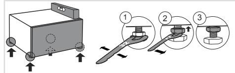
Vyrovnejte výsuvnou zásuvku podélně a příčně s vrty nástavných nožiček (pomocí klíče č. 32). Nožičky umožňují vyrovnání +/- 1 cm.
