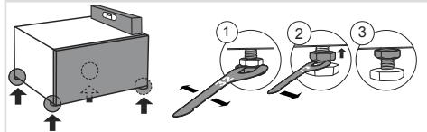
**1** Перед первым использованием установите ножки на напольный ящик (pedestal drawer). Закрутите ножки до упора, чтобы напольный ящик был правильно выровнен и стоял устойчиво.
