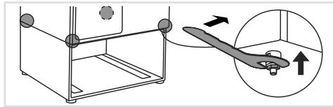
**7.1** Fixe as porcas em todos os quatro espaçadores a partir da parte inferior da máquina de lavar e aperte-as firmemente com uma chave de boca (chave de 17 mm).
