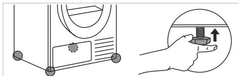
**6** Antes de colocar la secadora sobre el pedestal drawer, verifique que las patas estén completamente ajustadas con la mano (no use una llave).
