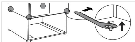
**7.1** Befestigen Sie die Muttern an allen vier Distanzstücken von der Unterseite der Waschmaschine und ziehen Sie sie mit einem Gabelschlüssel (17-mm-Gabelschlüssel) fest an.
