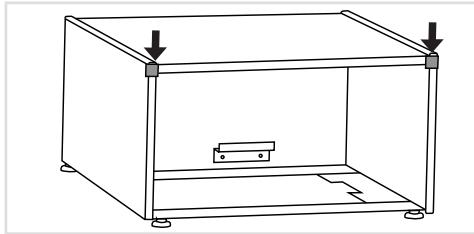
Før første brug skal al transportbeskyttelse fjernes. Transportelementerne er beregnet til at beskytte sokkelskuffen (pedestal drawer) under transport og skal fernes inden idriftsættelse.
