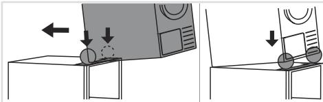
**7** Sušilni stroj dvignite, ga varno postavite na izvlečni predal ter ga potisnite nazaj, dokler se ne zaskoči v prednastavljene nosilce.
