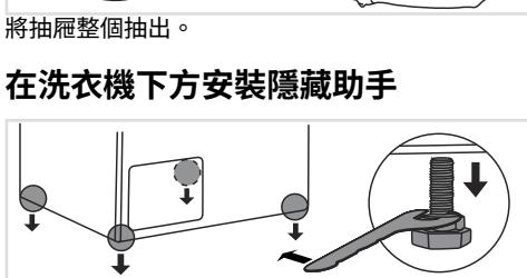
**4** 先將洗衣機向一側傾斜，然後再向另一側傾斜，以便用扳手（32毫米扳手）拆下金屬腳。
