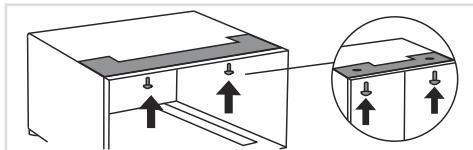
**5** Instalar la fijación de las patas delanteras. Desenrosque todos los tornillos de la parte superior interna y retire la fijación de las patas delanteras.
