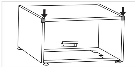
在首次使用之前，必须拆除所有运输保护装置。
