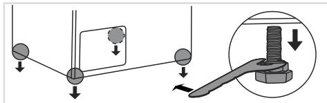
**4** Kippen Sie die Waschmaschine zuerst auf die eine und dann auf die andere Seite, sodass die Metallfüße mit einem Schraubenschlüssel (32-mm-Schraubenschlüssel) entfernt werden können.
