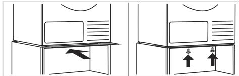
**7.1** Una vez instalada la secadora, vuelva a montar la fijación de las patas delanteras. Presione la fijación de las patas delanteras firmemente contra la secadora y vuelva a colocarla desde abajo con los tornillos.
