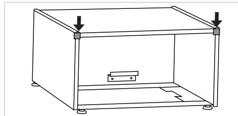
Retirez les éléments de protection utilisés pour le transport avant la première utilisation. Les éléments de protection sont destinés à protéger le tiroir avec socle (pedestal drawer) pendant le transport et doivent être retirés avant la mise en service.
