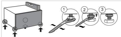
Вирівнійте тумбу в поздовжньому і поперечному напрямку, обертаючи регульовані ніжки (за допомогою гайкового ключа 32). Ніжки дозволяють вирівняти шухляду на +/- 1 см.
