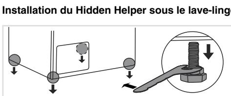
**4** Inclinez d'abord le lave-linge d'un côté, puis de l'autre afin de pouvoir retirer les pieds métalliques à l'aide d'une clé (clé de 32 mm).
