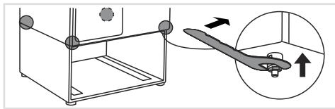
**7.1** Zo spodnej strany práčky pripevnite matice na všetky štyri dištančné podložky a pevne ich utiahnite vidlicovým klúčom (17 mm klúč).
