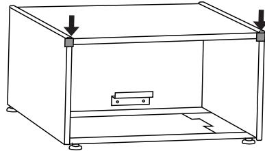
Antes del primer uso, elimine todas las protecciones de transporte. Los elementos de transporte están destinados a proteger el cajón pedestal (pedestal drawer) durante el transporte y deben retirarse antes de comenzar a usarlo.
