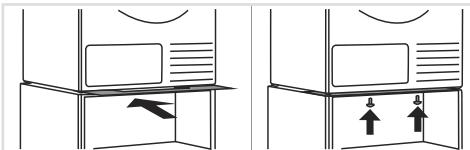
**7.1** Ko je sušilni stroj nameščen, ponovno namestite sprednje varovalo. Varovalo tesno pritisnite ob sušilni stroj in ga s spodnje strani ponovno pritrdite z vijaki.
