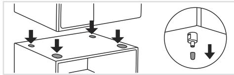
**7** Levante a máquina de lavar e coloque-a na gaveta de pedestal.
