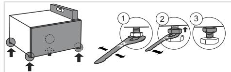
Wypoziomować szufladę wzduż i w szerz obracając regulowanymi nóżkami (kluczem nr 32). Nóżki można poziomować z dokładnością do +/- 1 cm.
