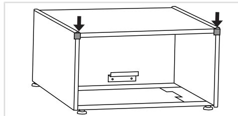
Vor der ersten Inbetriebnahme muss die gesamte Transportsicherung entfernt werden. Die Transportelemente dienen dem Schutz der Sockelschublade (pedestal drawer) während des Transports und müssen vor der Inbetriebnahme entfernt werden.
