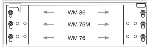
**8** Instalação de parafusos em diferentes modelos de máquina de lavar roupa
