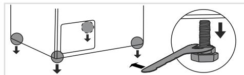
**1** Pred prvým použitím je potrebné namontovať nožičky na výsuvnú zásuvku (pedestal drawer). Utiahnite nožičky až do konca, aby bola zásuvka správne zarovnaná a stabilná.
