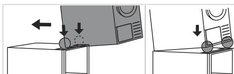
**7** Поднимите сушильную машину, аккуратно установите ее на корпус аксессуара и задвиньте назад, пока она не зафиксируется в предусмотренных местах.
