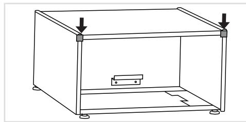
Antes da primeira utilização, é necessário remover toda a proteção de transporte. Os elementos de transporte destinam-se a proteger a gaveta de pedestal (pedestal drawer) durante o transporte e devem ser removidos antes da entrada em funcionamento.
