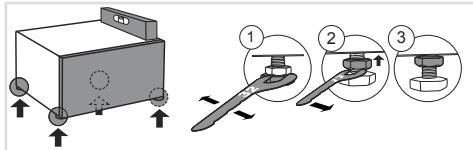
Nivåjustera tvättmaskinen plant i längsgående och tvärgående riktning genom att vrida på de justerbara fötterna (använd nyckel nr 32). Fötterna kan justeras med +/- 1 cm.
