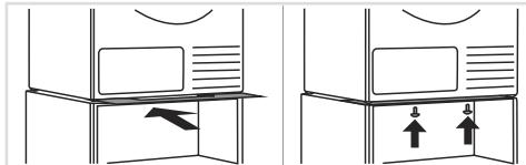
**7.1** Plaats wanneer de wasdroger is geïnstalleerd de bevestiging van de voorste voetjes terug. Druk de bevestiging stevig tegen de wasdroger draai de schroeven van onderen weer vast.
