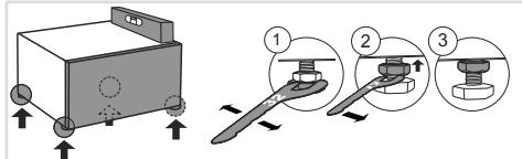
通過旋轉可調底腳（使用扳手編號32）在縱向和橫向方向上調整底座抽屜的水平。底腳可以調節+/- 1公分。
