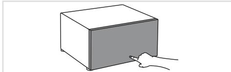
**1** Avant la première utilisation, il est nécessaire d'installer les pieds sur le tiroir avec socle (pedestal drawer) . Serrez les pieds à fond afin que le Pedestal Drawer soit correctement aligné et stable.
