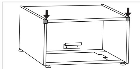
Du må fjerne all transportbeskyttelse fra produktet før du bruker det for første gang. Transportelementene er ment å beskytte sokkelskuffen (pedestal drawer) under transport, og må fjernes før oppstart.
