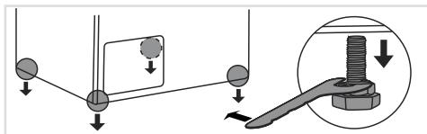
**4** Нахиліть пральну машину спочатку в один бік, а потім в інший, щоб зняти металеві ніжки за допомогою гайкового ключа (ключ на 32 мм).
