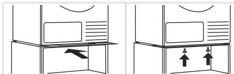
**7.1** После установки сушильной машины установите передний защитный элемент. Плотно прижмите защитный элемент к сушильной машине и прикрутите его винтами снизу.
