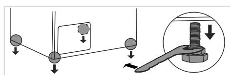
**4** 先将洗衣机向一侧倾斜，然后再向另一侧倾斜，以便用扳手（32毫米扳手）拆下金属底脚。
