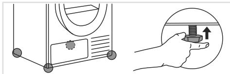
6 将干衣机放置在底座抽屉上之前，请用手检查干衣机底脚是否完全拧紧（不要使用扳手）。
