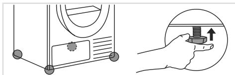
**6** Перед тем как поставить сушильную машину на напольный ящик, проверьте рукой, что ножки закручены до упора (не используйте ключ).
