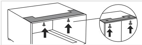
**5** Etujalkojen kiinnikkeiden asentaminen
