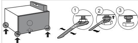
Nível a gaveta de pedestal na direção longitudinal e transversal ao rodar os pés ajustáveis (utilizando uma chave n.º 32). Os pés permitem nivelar +/- 1 cm.
