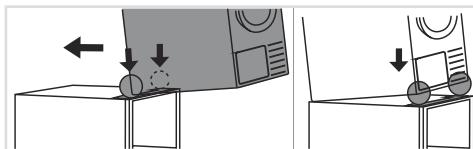
**7** Levante la secadora, colóquela con seguridad sobre el pedestal drawer y empújela hacia atrás hasta que se bloquee en los soportes preinstalados.
