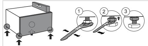
旋转可调底脚（使用扳手编号32）在纵向和横向方向上调整底座抽屉的水平。底脚可以调节+/- 1厘米。
