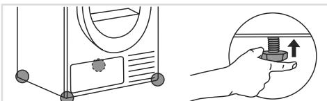
**6** Bevor Sie den Wäschetrockner auf die Sockelschublade stellen, prüfen Sie von Hand, ob die Füße vollständig angezogen sind (keinen Schraubenschlüssel verwenden).
