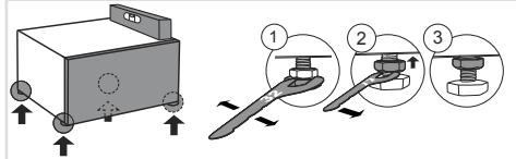
Mettez-le Pedestal Drawer à niveau, à l'horizontale et à la verticale, en tournant les pieds réglables (avec une clé n° 32). Les pieds permettent un ajustement en hauteur de +/- 1 cm.
