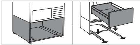
8 拉出两个导轨并将底座抽屉放在导轨上。
