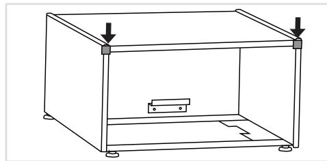
Перед первым использованием удалите всю транспортную защиту. Транспортировочные элементы служат для защиты напольного ящика (pedestal drawer) во время транспортировки, поэтому их необходимо снять перед началом использования.
