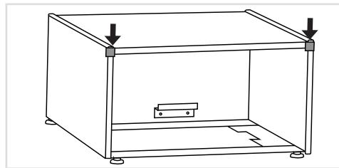
Prije prve uporabe potrebno je ukloniti svu zaštitu za transport. Transportni elementi namijenjeni su zaštiti postolja s ladicom (pedestal drawer) tijekom transporta i moraju se ukloniti prije pokretanja uređaja.
