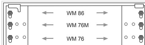
Hvis du har en vaskemaskine med mindre dybde, vil en del af soklen rage ud bagved, hvilket ikke påvirker monteringen stabilitet eller funktionalitet.
