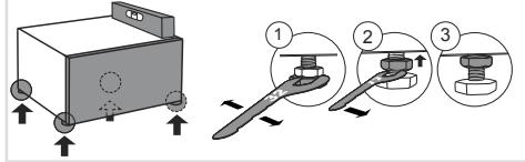
Nivellieren Sie die Sockelschublade in Längs- und Querrichtung durch Drehen der verstellbaren Füße (mit einem Schraubenschlüssel Nr. 32). Die Gerätefüße ermöglichen eine Ausrichtung von  $\pm 1$  cm.
