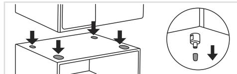
**7** Til de wasmachine op en plaats deze op de uitschuifbare lade.
