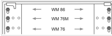
**8** Установка винтов для различных моделей сушильных машин
