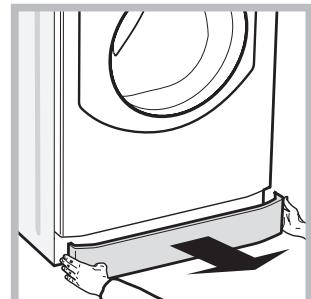
1. zdjąć płytę przykrywającą, znajdująca się tyłu rzadzenie naciskając ją ku środkowi, następnie popchnąć ku dołowi z dwóch stron i wyjąć ją (zobacz rysunki).
