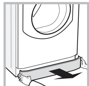
1. Sejměte krycí panel na přední straně zařízení zatlačením na jeho střed a následným zatlačením směrem dolů z obou stran a poté jej vytázněte (viz obrázky).
