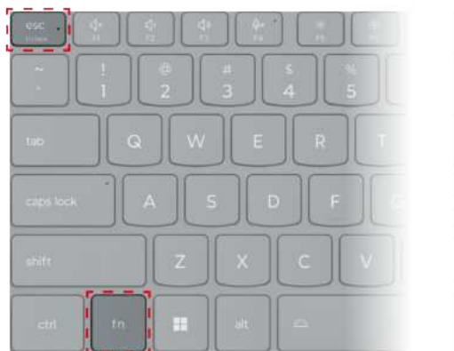
Rysunek 3. Umieszczenie klawisza Fn Lock i klawisza Fn
