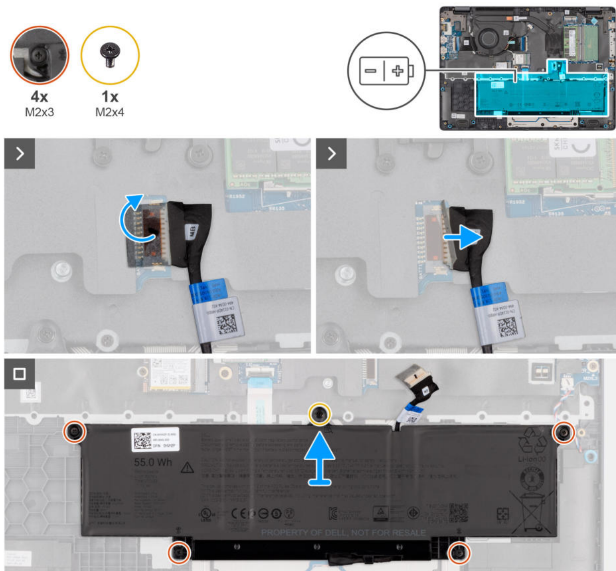
Rysunek 17. Wymontowywanie baterii
