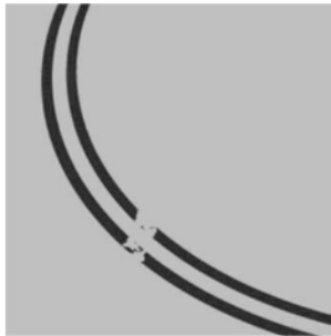
Starty nadruk dekoracyjny szyby - wynik zastosowania nieodpowiedniego środka czyszczącego.
