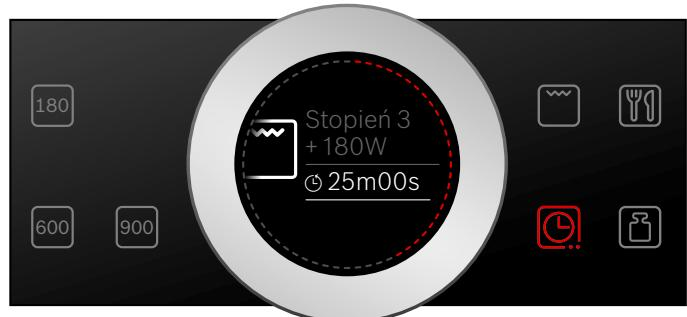
6. Włączyć za pomocą przycisku start/stop ④. Czas trwania odliczany jest na wyświetlaczu.
