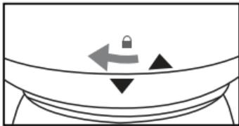
**DE Inbetriebnahme:** Batteriefachdeckel aufdrehen. 3 AAA-Batterien entsprechend der Markierung einlegen. Batteriefachdeckel wieder aufsetzen, auf richtige Ausrichtung achten.
