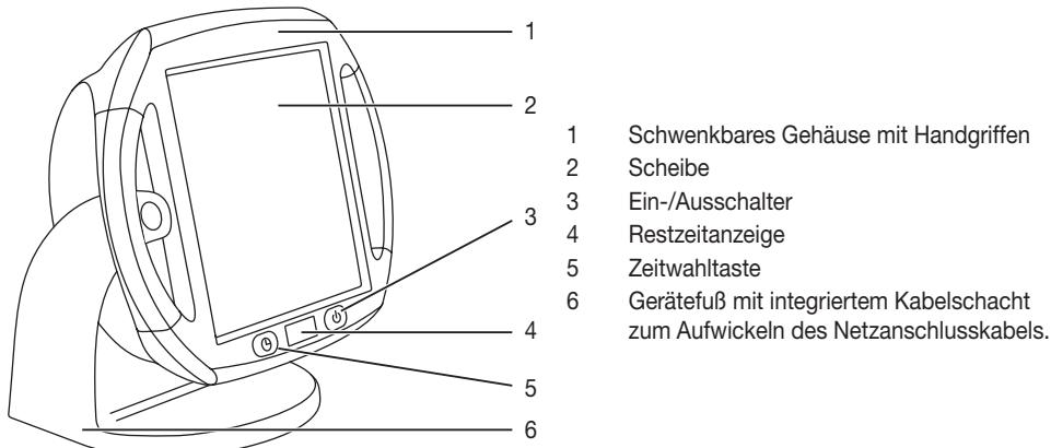
Infrarot-Wärmestrahl器 mit einstellbarem Timer (1 bis 15 Minuten) und schwenkbarem Gehäuse (0 bis 50 Grad).
