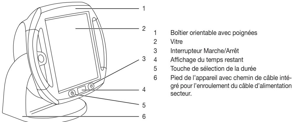
Diffuseur de chaleur infrarouge avec minuteur réglable (1 à 15 minutes) et boîtier orientable (0 à 50 degrés).
