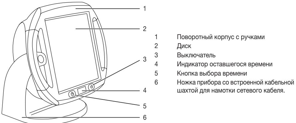
Прибор инфракрасного излучения с настраиваемым таймером (от 1 до 15 минут) и поворотным корпусом (от 0 до 50 градусов).
