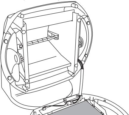
6. Установите новую лампу в патрон. Следуйте инструкции по демонтажу лампы, но в обратной последовательности.
