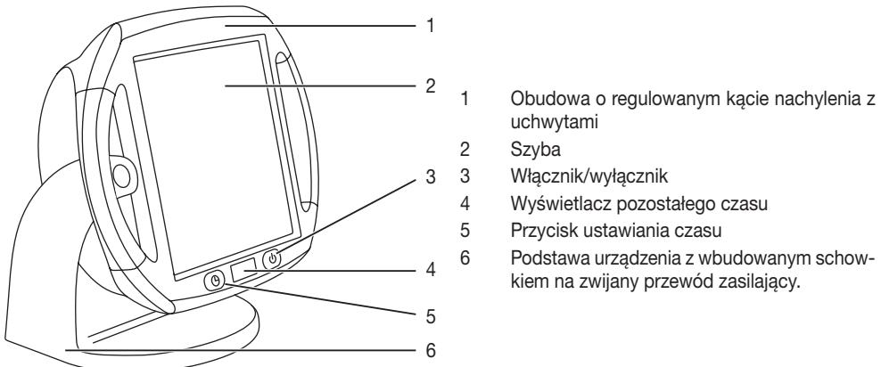
Promiennik podczerwieni z timerem (nastawnym od 1 do 15 minut) i obudową o regulowanym kącie nachylenia (od 0 do 50 stopni).
