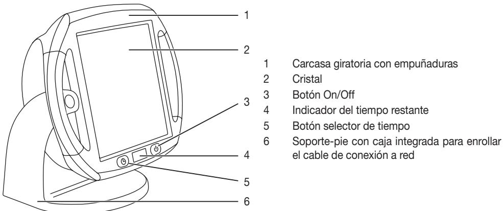
Radiador de calor Infrarrojo con temporizador ajustable (de 1 a 15 minutos) y carcasa giratoria (de 0 a 50 grados).
