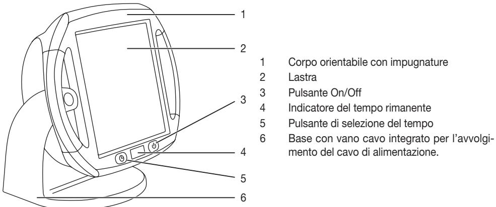
Radiatore termico a raggi infrarossi con timer impostabile (da 1 a 15 minuti) e corpo orientabile (da 0 a 50 gradi).
