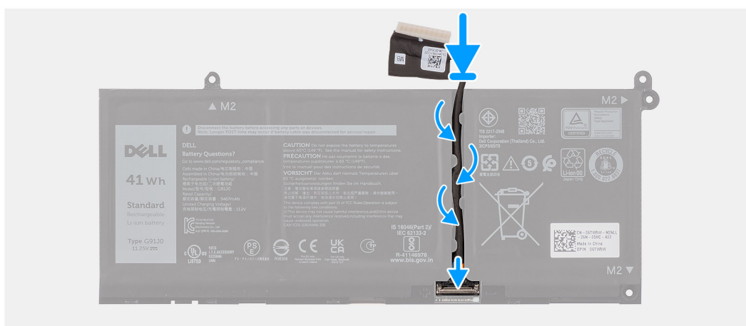
Rysunek 22. Podłączanie kabla baterii
