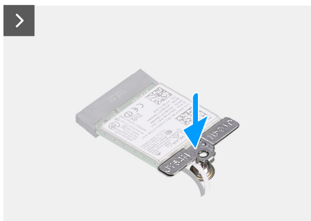
Rysunek 28. Instalowanie karty sieci bezprzewodowej
