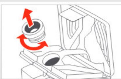
Bei starker Verschmutzung kann der sogenannte Ejector durch Drehen der Stutzendichtung für die Reinigung entnommen werden.
