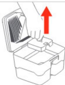
Sofern sich noch Schmutz im Schmutzwasserbehälter der AQUA-Pure-Filterbox befindet, reinigen Sie diesen gründlich unter fließendem Wasser und gießen das Schmutzwasser über die Ausgieöffnung aus.
