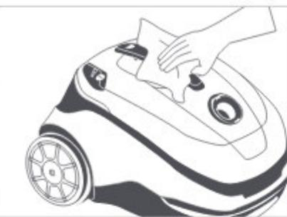
Gehäuse des Gerätes reinigen
