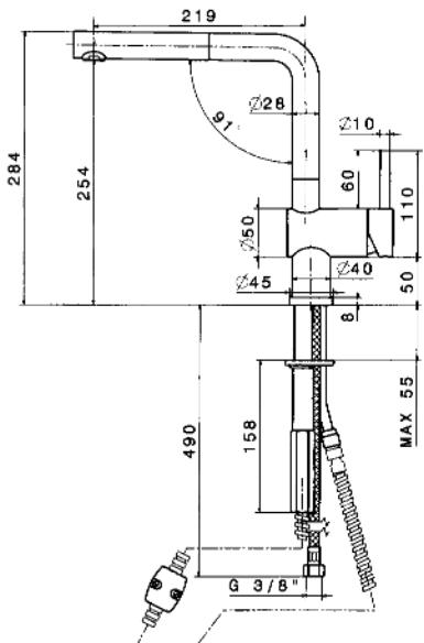
Tischplattenbohrung Ø 35 mm
