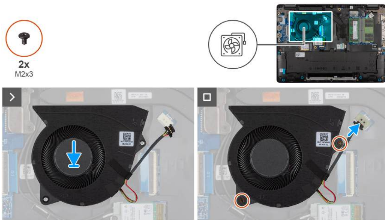
Rysunek 34. Instalowanie wentylatora
